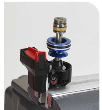
**2** Bewegen Sie die Dichtkopf/Luftkolben-Baugruppe nach unten.
