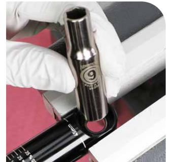
Stecknuss (AD: 14,5 mm bis 16,25 mm)
