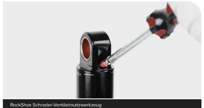
**8** Beaufschlagen Sie den Dämpferkörper mit Druck.
