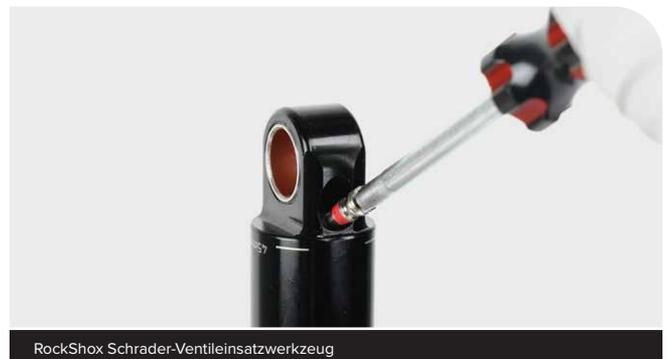
**8** Beaufschlagen Sie den Dämpferkörper mit Druck.
