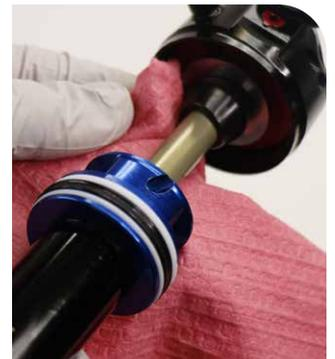
**2** Entfernen Sie die Staubabstreiferdichtung der Luftkammer in der oberen Nut.
