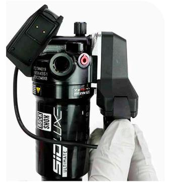
Setzen Sie den Verlängerungskabel-Akku in das Steuermodul ein.
