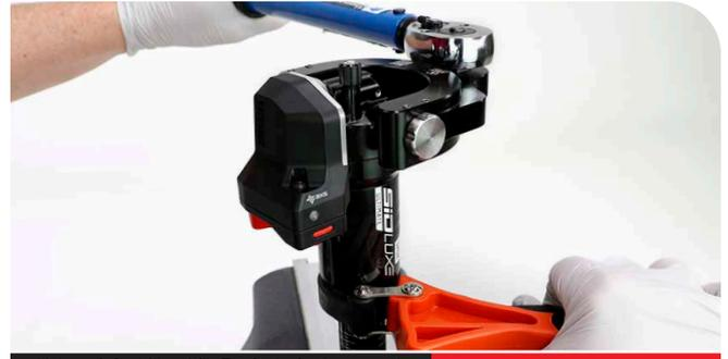
Hahnenfußschlüssel für Zapfenbefestigung und Bandschlüssel
