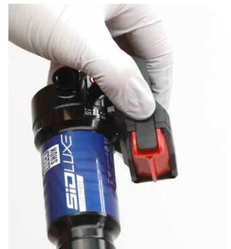
**3 Ultimate Flight Attendant (FA) Verlängerungskabel:** Stellen Sie den Hinterbaudämpfer auf die offene Position ein, bevor Sie den Akku entfernen. Für einen FA-Hinterbaudämpfer, der nicht mit einer FA-Gabel gekoppelt ist (oder wenn der Akku aus der Gabel entfernt wurde), drücken Sie zweimal kurz die AXS-Taste am Hinterbaudämpfermodul, um den Hinterbaudämpfer in die offene Position zu stellen. Er befindet sich in der offenen Position, wenn ein Doppelklick keinen Ton vom Modul erzeugt.
