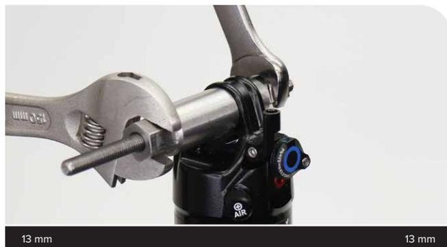
**3** Schrauben Sie den Aufnehmer von der Gewindestange ab. Entfernen Sie das Werkzeug aus dem Auge und entsorgen Sie die Buchse.
