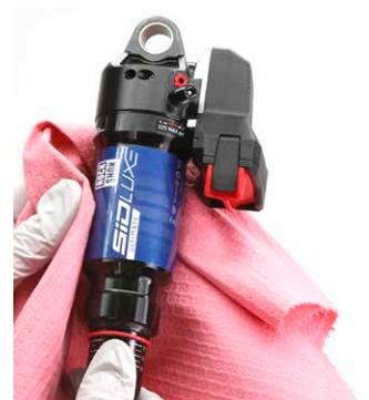
**7** Montieren Sie den O-Ring der Nachgiebigkeitsanzeige.
