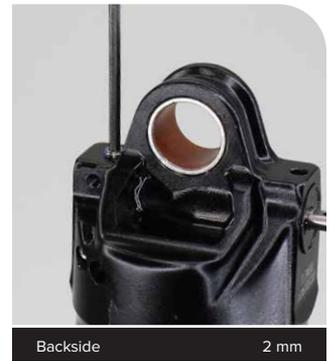
**4 In und Out:** Entfernen Sie die Feststellschraube auf der Rückseite des Auges.
