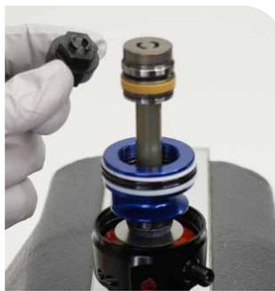
Ventildeckel mit Kolbenwerkzeug
