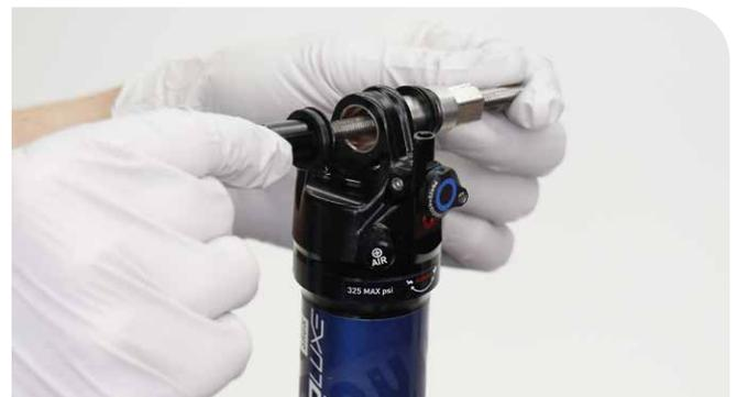
**4** Wenn sich der Buchsenstift nicht einfach entfernen lässt, stecken Sie die Gewindestange und den Druckstift wieder durch das Auge
