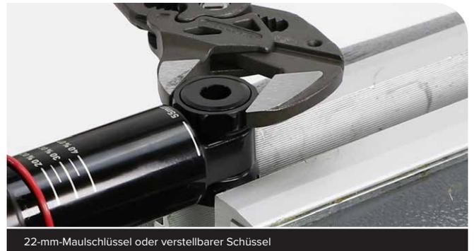
22-mm-Maulschlüssel oder verstellbarer Schlüssel
