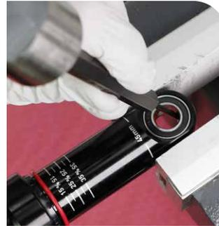
Lagerauschlagwerkzeug und Hammer
