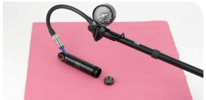
RockShox SIDLuxe Luftventil-Adapter und Dämpferpumpe
