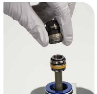
Kolbenwerkzeug und 14-mm-Stecknuss
