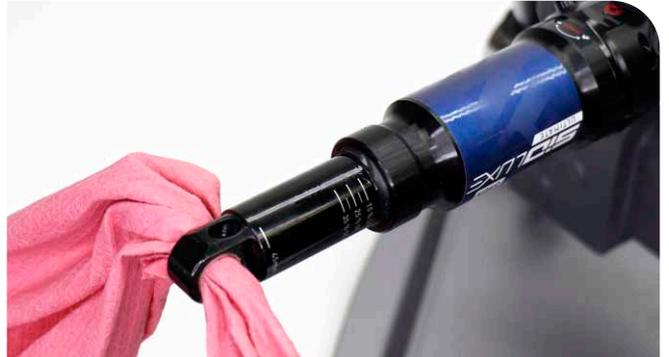
10 Bauen Sie die Luftkammer mit einem Bandschlüssel aus. Wickeln Sie das Band um den Teil der Luftkammer, der am weitesten vom Führungsstangenauge entfernt ist. Drehen Sie den Schlüssel gegen den Uhrzeigersinn, um die Luftkammer abzuschrauben.
