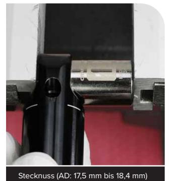
Stecknuss (AD: 17,5 mm bis 18,4 mm)
