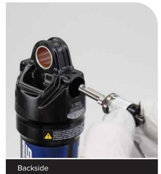
**7** Säubern Sie das Auge. Überprüfen Sie, dass der Druckstufenstift nicht durch die Öffnung des Auges sichtbar ist.
