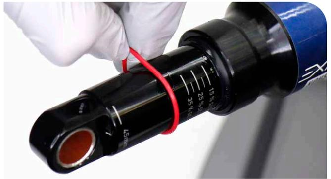
9 Stecken Sie ein Werkstatttuch in das Dämpferauge, damit die Luftkammer nicht stoßartig aus dem Dämpfer herausschnellen kann.
