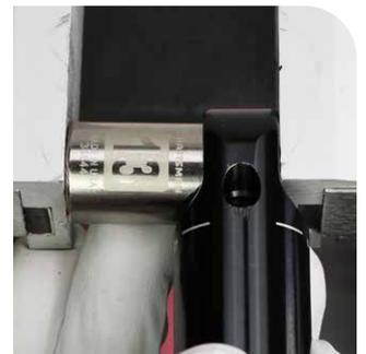
Stecknuss (AD: 17,5 mm bis 18,4 mm)
