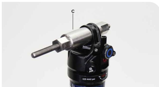
**2** Cspannen Sie den Aufnehmer in einen Schraubstock oder fixieren Sie ihn mit einem 13-mm-Schlüssel.
