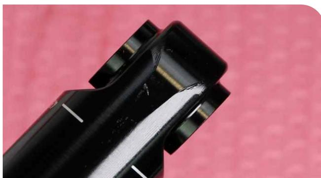
Bevor Sie Ihren Hinterbaudämpfer warten, bauen Sie ihn gemäß den Anweisungen des Fahrradherstellers aus dem Fahrradrahmen aus. Nachdem Sie den Dämpfer aus dem Fahrrad ausgebaut haben, entfernen Sie die Befestigungsteile, bevor Sie zur Wartung übergehen (siehe Abschnitt [Wartung des Dämpferauges](#)).
