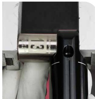
Stecknuss (AD: 17,5 mm bis 18,4 mm)
