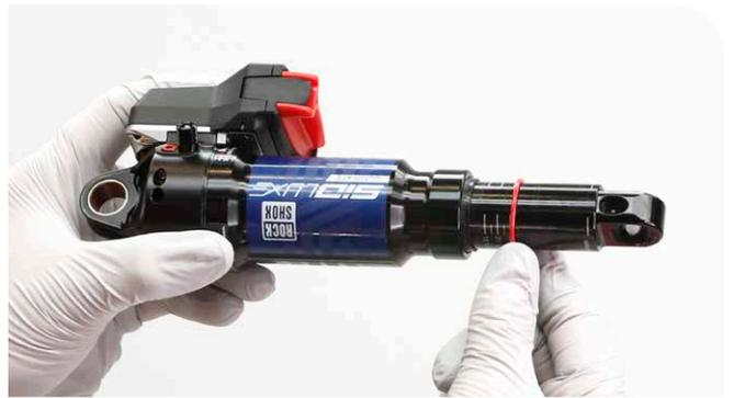
**8** Montieren Sie den Einsatz des Schrader-Ventils.
