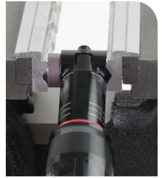
Herramienta de prensa de rodamientos de 22 mm (diámetro exterior) x 10 mm (diámetro interior)
