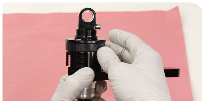
Clip de purge et outil de compression du ressort de la tête d'étanchéité Counter Measure
