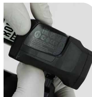
Installation de la batterie SRAM
