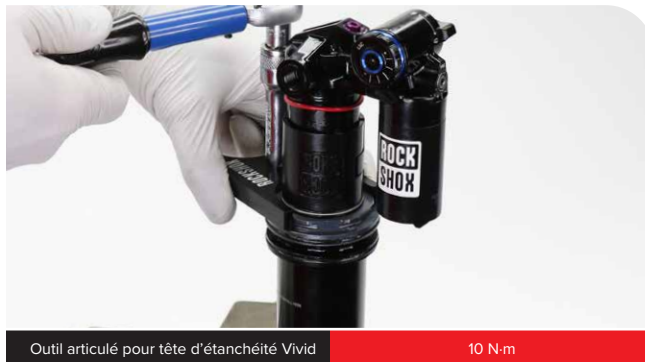
Outil articulé pour tête d'étanchéité Vivid
