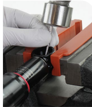
Marteau/maillet Poinçon pour roulement/tige étalon 1/8 po/3 mm (diam. ext.)
