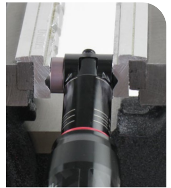
Presse à roulement de 22 mm (diam. ext.) x 10 mm (diam. int.)
