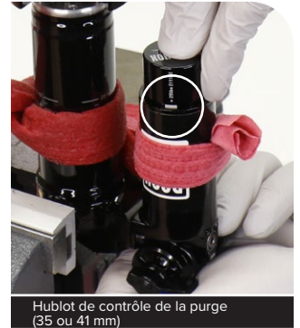
Hublot de contrôle de la purge (35 ou 41 mm)
