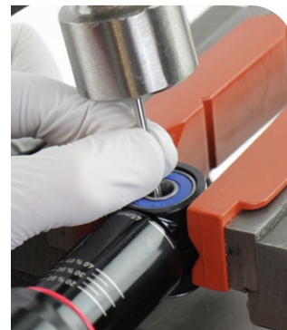
Poinçon pour roulement/tige étalon - 3 mm (diam. ext.)
