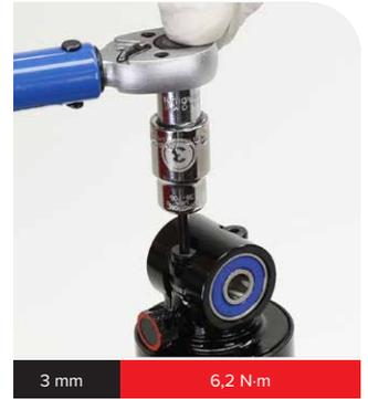
Bringen Sie die Staubabdeckungen der Lager wieder an, wenn der Dämpfer wieder in das Fahrrad eingebaut wird.
