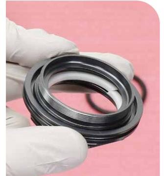
**5** **Vivid C1 V1 und V1,5:** Tragen Sie Schmierfett auf eine neue innere Vierkantringdichtung auf und montieren Sie sie über der weißen inneren geteilten Buchse.
