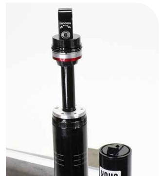
**Vivid C1 V1 und V1,5:** Wenn die graue Dichtkopfbaugruppe für Negativluft ausgetauscht werden muss, montieren Sie eine Vivid C1 V2 Dichtkopfbaugruppe für Negativluft.
