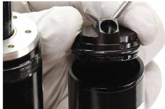
**6** Entfernen Sie den O-Ring der Kappe des IFP-Ausgleichsbehälters und entsorgen Sie ihn.
