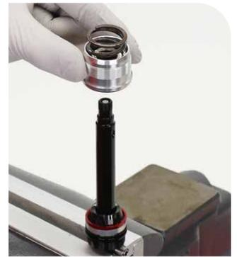
**Vivid C1 V1:** Wenn die Dämpfer-Dichtkopfbaugruppe ausgetauscht werden muss, montieren Sie eine Vivid C1 V2 Dämpfer-Dichtkopfbaugruppe, wenn Sie den Dämpfer wieder zusammenbauen. Nähere Informationen zu den aktuell verfügbaren Wartungs- und Ersatzteilsätzen finden Sie im *RockShox-Ersatzteilkatalog*. Wenden Sie sich wegen weiterer Informationen bei Bedarf an den SRAM Fahrer-Support.
