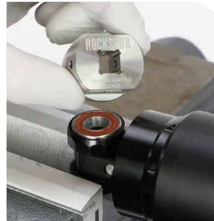
Wartung des Dämpferauges – Lageradapter (26 mm)
