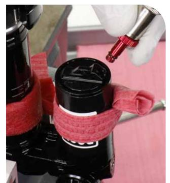
**26** Bringen Sie einen neuen O-Ring an der Luftventilkappe des Ausgleichsbehälters an.
