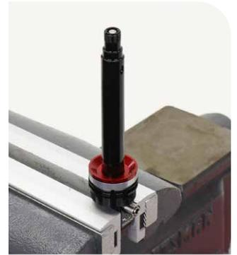
**14** Tragen Sie Schmierfett auf die innere Oberfläche des unteren Anschlagpuffers auf und montieren Sie ihn.
