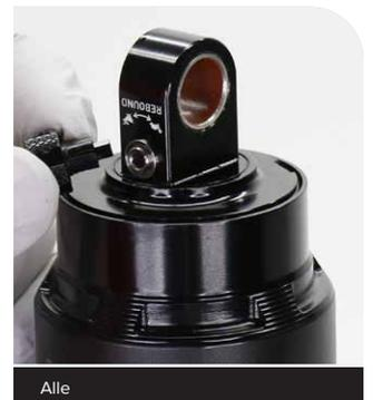
**Select RT, Select+ RCT, Ultimate RC2T:** Drehen Sie den Auslöseschwellen-Hebel (Pedal) in die geöffnete Position.
