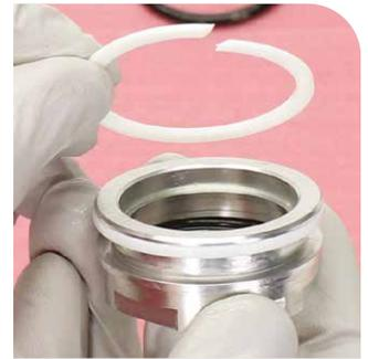
Dichtkopf für Positivluft V1
