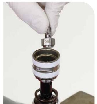
**6** Führen Sie einen Dorn oder einen kleinen Inbusschlüssel in der Mitte der Dämpferführungsstange ein.
