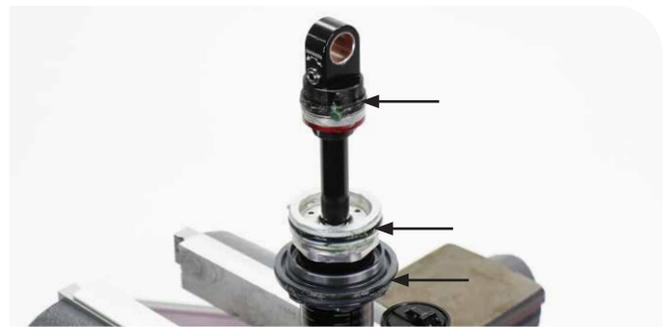
RockShox Dynamic Seal Grease-Dichtungsfett
