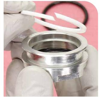
Dichtkopf für Positivluft V1
