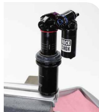
**18** Entfernen Sie den Dämpfer aus dem Schraubstock. Spannen Sie den Dämpferkörper wieder so in den Schraubstock ein, dass das Führungsstangenauge nach oben weist.
