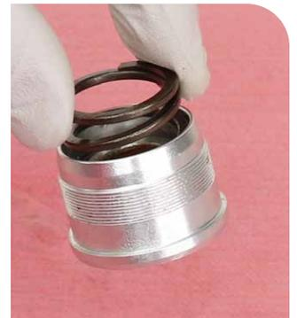
**21** Setzen Sie den Dichtkopf auf die Dämpferführungsstange auf. Wischen Sie überschüssiges Schmierfett vom Gewinde der Dämpferführungsstange ab.
