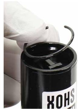
**5** Entfernen Sie die Kappe des IFP-Ausgleichsbehälters vom IFP-Ausgleichsbehälter.
