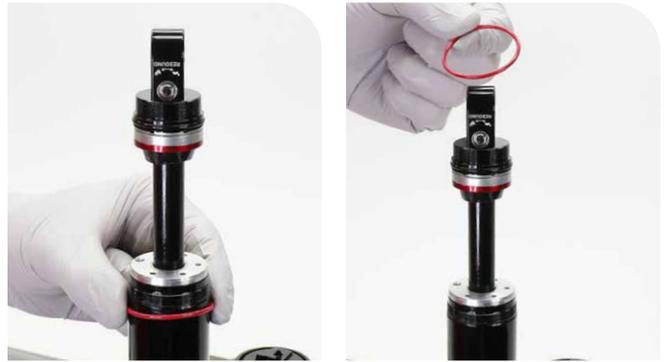
Entfernen Sie den O-Ring vom Führungsstangenauge und entsorgen Sie ihn.
