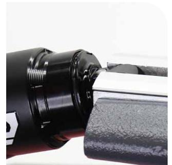
**6** Verwenden Sie einen kleinen, scharfen Schlitzschraubendreher, um das Ende des Luftkammer-Sicherungsringes so in der Nut zu positionieren, dass er zugänglich ist.
