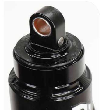
**24** Schieben Sie die äußere Luftkammer bis zum Anschlag zum Sicherungsring hin, damit der Sicherungsring nicht mehr sichtbar ist.
