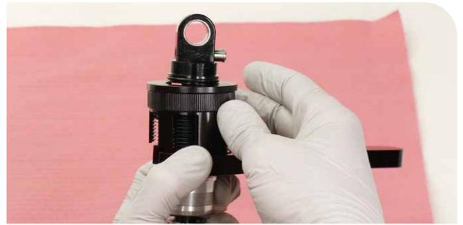
Entlüftungsclip V1 und Counter Measure-Dichtkopffeder-Kompressionswerkzeug
