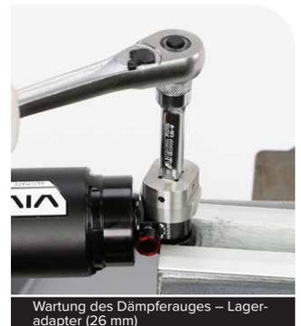
Wartung des Dämpferauges – Lageradapter (26 mm)
