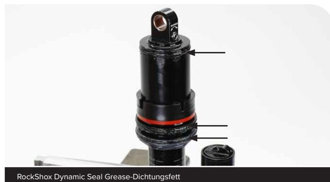
**21** Montieren Sie die äußere Luftkammer über der inneren Luftkammer und der O-Ring-Dichtung.
