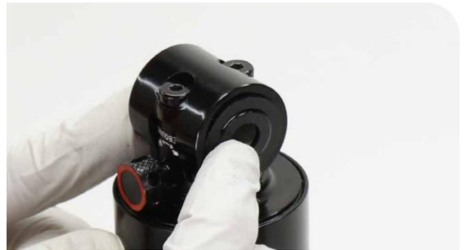
Montieren Sie das Flight Attendant-Hinterbaudämpfermodul nach Abschluss der Wartung.
