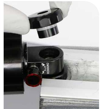
**3** Ziehen Sie den Dämpfer nach oben, um den verbleibenden Lageradapter zu entfernen.
