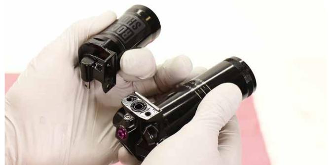
**3** **Select+ RCT, Ultimate DH RC2:** Schrauben Sie die (A) linke freiliegende Ausgleichsbehälterschraube (3 mm) heraus.
