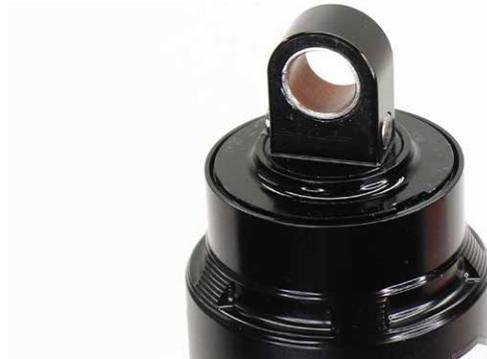
**25** Drehen Sie den Ausgleichsbehälter und richten Sie ihn, sofern erforderlich, in der ursprünglichen Position aus (parallel mit oder senkrecht zum Führungsstangenauge).
