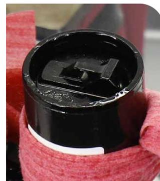
**22** Setzen Sie ein Ende des Sicherungsrings in die Nut ein.
