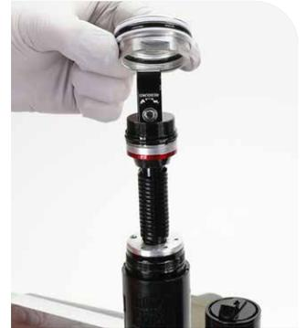
**Vivid C1 V1:** Wenn die silberne Dichtkopfbaugruppe für Positivluft ausgetauscht werden muss, montieren Sie eine Vivid C1 V2 Dichtkopfbaugruppe für Positivluft.
