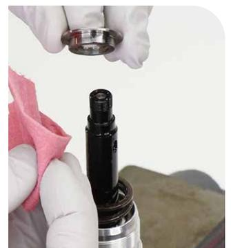
**8** Entfernen Sie die Dichtkopf-Baugruppe.
