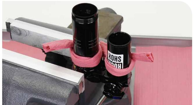
**3** Füllen Sie den IFP-Ausgleichsbehälter bis nahe an den oberen Rand mit Federungsöl. Öl beginnt in den Dämpferkörper abzulaufen.
