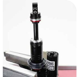
**24** Entfernen Sie den grauen Dichtkopf für Negativluft.
