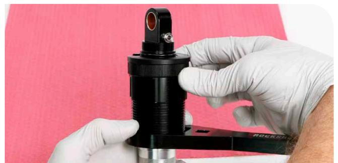
Entlüftungsclip V2 und Counter Measure-Dichtkopffeder-Kompressionswerkzeug
