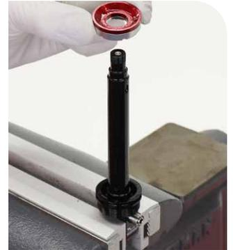
**12** Säubern Sie die Dämpferführungsstange und überprüfen Sie sie auf Beschädigungen. Wenn die Dämpferführungsstange beschädigt oder abgenutzt ist, muss sie ausgetauscht werden.
