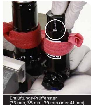
Entlüftungs-Prüfenster (33 mm, 35 mm, 39 mm oder 41 mm)
