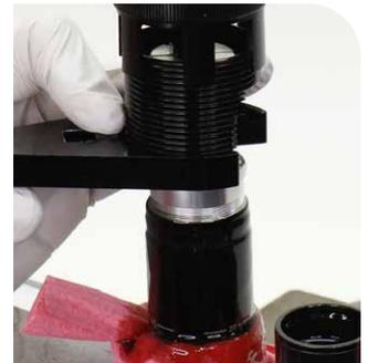
**11** Schrauben Sie den Dichtkopf in den Dämpferkörper, bis das Gewinde greift.
