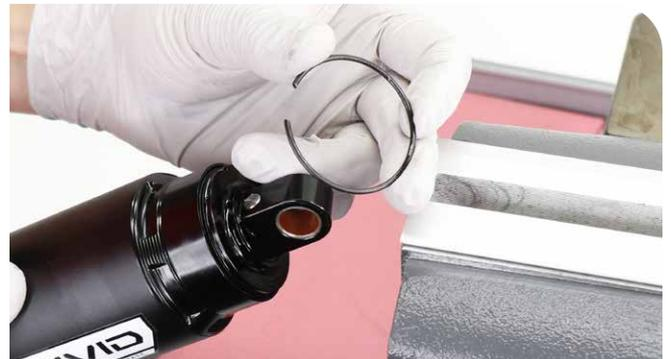
**7** Spannen Sie den Dämpfer wieder in den Schraubstock ein.
