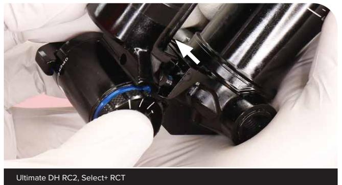
Entfernen Sie die linke Ausgleichsbehälterschraube und die Ausgleichsbehälter-Baugruppe.
