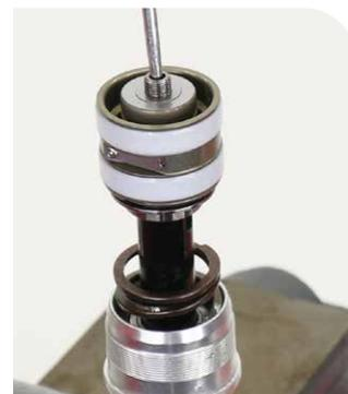
**26** Bringen Sie die Kolbenmutter auf dem unteren Zapfen an und ziehen Sie sie mit dem angegebenen Drehmoment fest.
