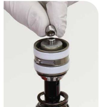
**4** Führen Sie einen Dorn oder einen kleinen Inbusschlüssel durch die Mitte des unteren Kolbenzapfens ein.
