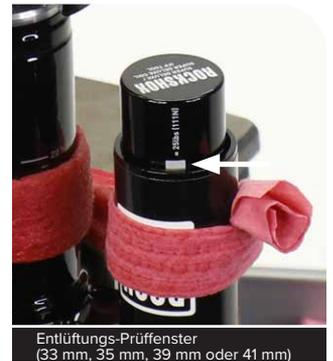
Entlüftungs-Prüfenster (33 mm, 35 mm, 39 mm oder 41 mm)
