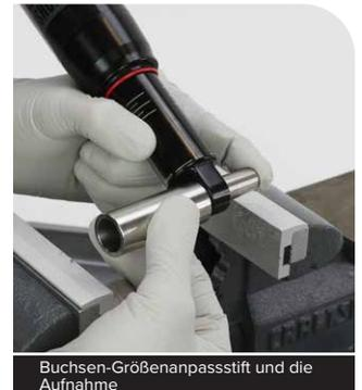
**3** Spannen Sie den Buchsen-Größenanpassstift und die Aufnahme in den Schraubstock ein.
