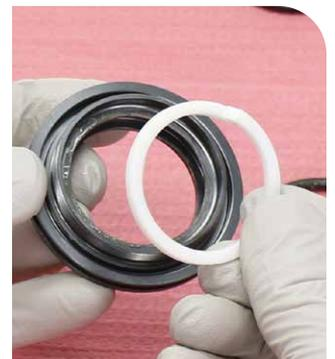
**2 Vivid C1 V1,5:** Entfernen Sie den äußeren O-Ring, die Abstreiferdichtung und die innere Vierkantringdichtung vom grauen Dichtkopf für Negativluft und entsorgen Sie sie.
