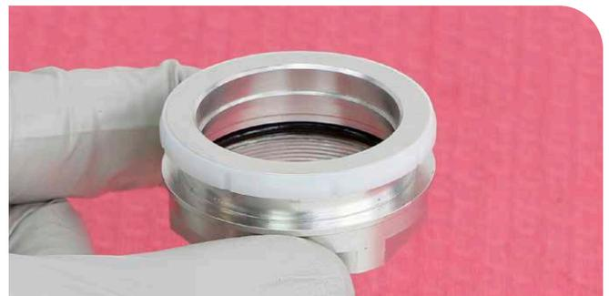
Dichtkopf für Positivluft V2
