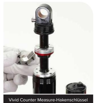
**2** Schieben Sie den Puffer, das Federwegdistanzstück und die Platte nach oben zum Auge hin.
