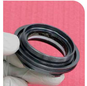
**Vivid C1 V2:** Tragen Sie Schmierfett auf eine neue innere Vierkantringdichtung auf und montieren Sie sie über der weißen inneren festen Buchse.
