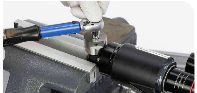
Wartung des Dämpferauges – Lageradapter (26 mm)
