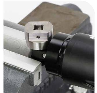
Wartung des Dämpferauges – Lageradapter (26 mm)
