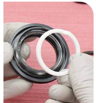
**Vivid C1 V2:** Entfernen Sie den äußeren O-Ring, die Abstreiferdichtung und die innere Vierkantringdichtung vom grauen Dichtkopf für Negativluft und entsorgen Sie sie.
