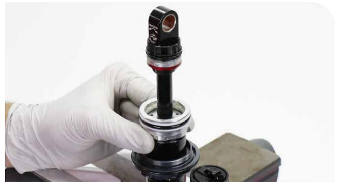
**5** Montieren Sie die Vivid Dämpferkörper-Protektoren.
