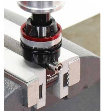
**3** Lösen und entfernen Sie die Kolbenmutter.
