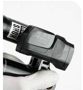
**5** Setzen Sie den SRAM-Akku ein, um zu überprüfen, ob das Hinterbaudämpfermodul ordnungsgemäß funktioniert. Der Motor des Hinterbaudämpfermoduls sollte sich ein- und ausschalten, sodass der Druckstufendämpfer in Richtung der offenen Position gestellt wird.
