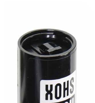
**4** Entfernen Sie den Sicherungsring vom IFP-Ausgleichsbehälter.
