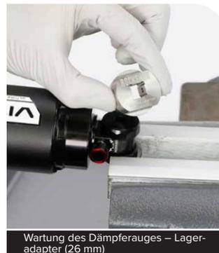
Wartung des Dämpferauges – Lageradapter (26 mm)
