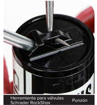
**24** Instale la herramienta adaptadora para válvulas de aire del amortiguador trasero RockShox roja en la bomba para amortiguadores.
