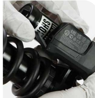
Extracción de la batería SRAM
