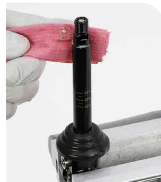
**14** Retire el tornillo de purgado del cabezal de sellado.
