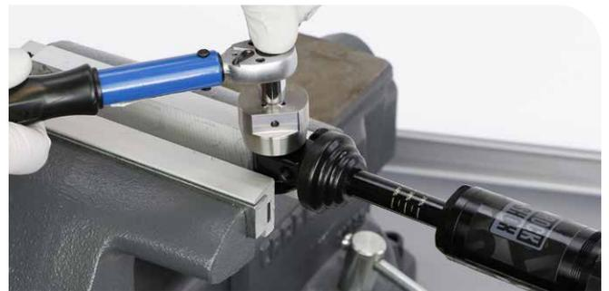
Adaptador de rodamiento del amortiguador trasero (26 mm)
