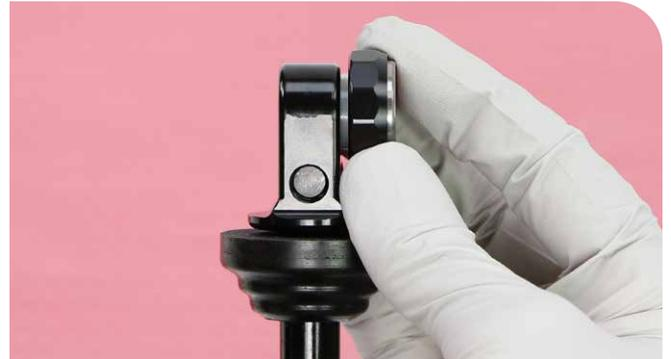
**3** Instale el adaptador de rodamiento roscado exterior (incluye un hoyuelo en cada lado hexagonal) en el ojal y enrósquelo en el rodamiento roscado interior.
