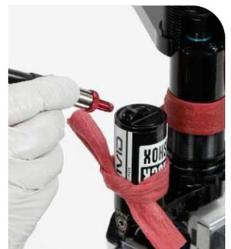
**25** Instale una junta tórica nueva en el tapón de la válvula de aire del depósito.
