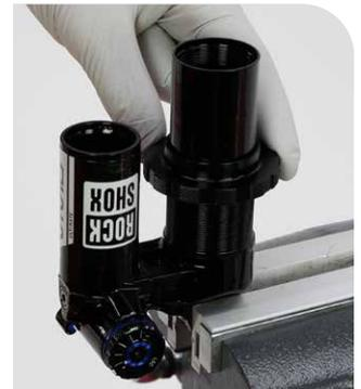
**3** Coloque una toalla de taller alrededor del cuerpo del amortiguador y del depósito para absorber el aceite.
