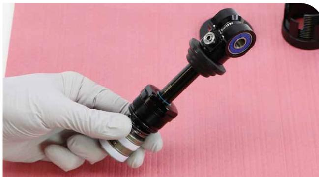
**3** Coloque la llave ajustable Counter Measure en el cabezal de sellado. No tape el orificio de purgado con la llave.
