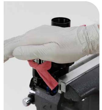
**4** Llene el depósito con más aceite y siga golpeando su parte superior hasta que dejen de salir burbujas del cuerpo del amortiguador.
