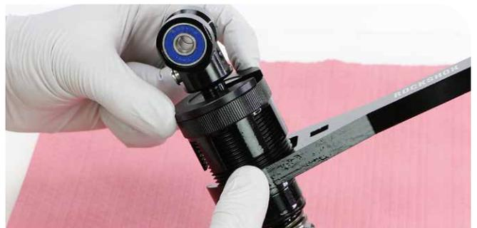
Clip de purgado y herramienta de compresión del resorte del cabezal de sellado Counter Measure
