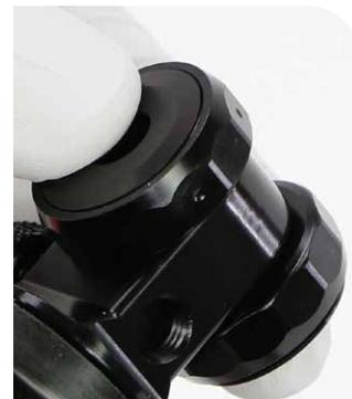
Un adaptador de rodamiento RockShox (26 mm, V2) nuevo incluye un rodamiento en el adaptador sin hoyuelo que no está completamente asentado y que se debe presionar y asentar en el adaptador antes de instalar el amortiguador en una bicicleta.
