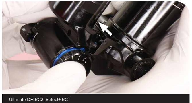
Retire el perno izquierdo y el conjunto del depósito.
