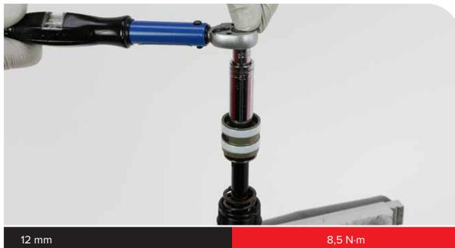
**25** Con los orificios de la válvula del pistón de retención orientados hacia el pistón, instale el pistón y las cuñas de retención.
