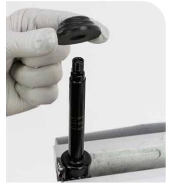
**10** Retire el reductor de recorrido (si está instalado).
