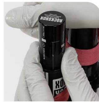
≈20 mm Herramienta de ajuste de altura del IFP
