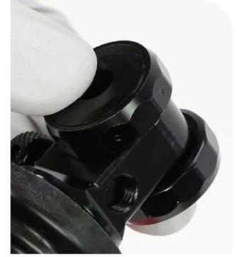
**8 Adaptador de rodamiento V2 nuevo:** Instale las cubiertas de los rodamientos y coloque el adaptador de rodamiento en el tornillo de banco.
