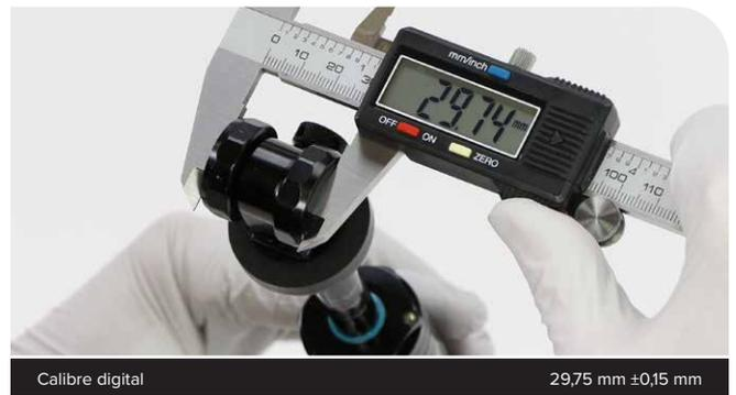
Si hay un adaptador de rodamiento instalado, retírelo antes de realizar el mantenimiento del amortiguador.
