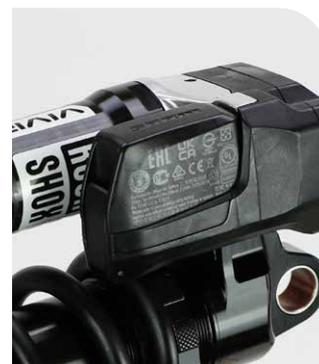
**5** Para confirmar que el módulo del amortiguador trasero funciona correctamente, instale la batería SRAM. El motor del módulo del amortiguador trasero debe completar un ciclo de encendido para ajustar el amortiguador de compresión hacia la posición abierta.
