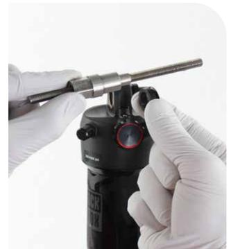
**4** Si no consigue sacar fácilmente el pasador del casquillo, vuelva a insertar la varilla roscada y el pasador de empuje a través del ojal del eje.
