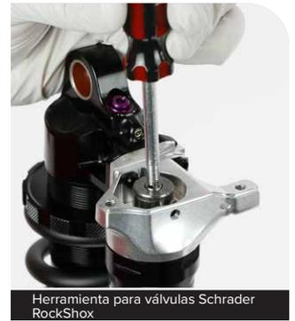
Herramienta para válvulas Schrader
