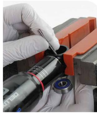
**4** Limpie los orificios del rodamiento.
