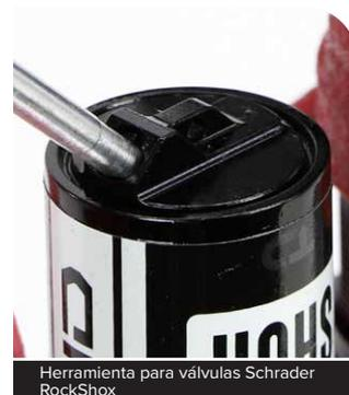
Herramienta para válvulas Schrader
