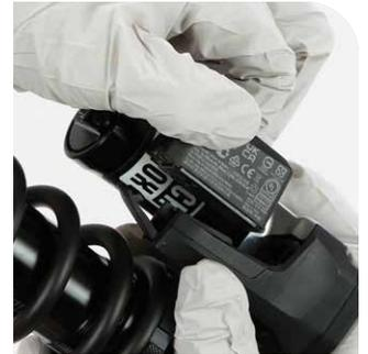
Extracción de la batería SRAM
