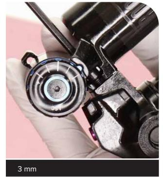
Desenrosque el perno oculto derecho del depósito (3 mm).
