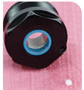
**16** Retire la junta antipolvo interior del cabezal de sellado y deséchela.
