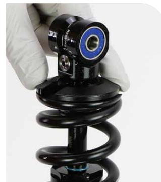
**5** Sujete el clip del resorte para que no gire. Gire el regulador de precarga del resorte hasta que el resorte helicoidal entre en contacto con el clip del resorte. Asegúrese de que no haya movimiento vertical entre el resorte helicoidal, el clip del resorte y el regulador de precarga del resorte.
