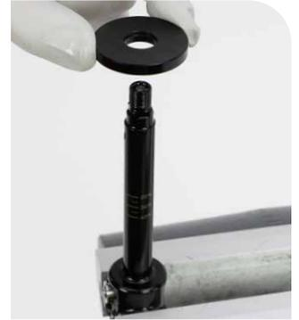
**11** Limpie el eje del amortiguador e inspecciónelo en busca de daños. Si el eje del amortiguador está dañado o desgastado, es necesario sustituirlo.
