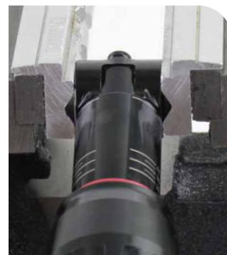
**2** Afloje el tornillo de banco, alinee la herramienta de prensa de rodamientos con el centro del rodamiento y apriete lentamente el tornillo de banco. Compruebe y confirme que la herramienta de prensa de rodamientos esté centrada y no montada sobre el borde del rodamiento.
