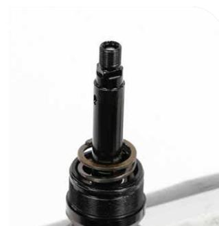
**23** Instale la placa superior en el eje del amortiguador.
