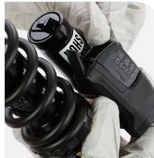
Instalación de la batería SRAM
