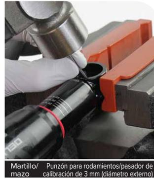
Martillo/ mazo    Punzón para rodamientos/pasador de calibración de 3 mm (diámetro externo)
