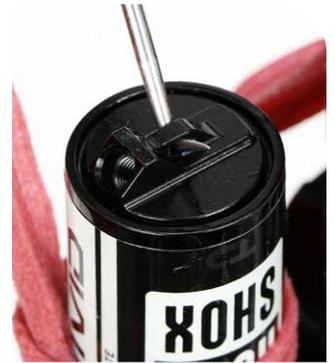
**23** Vuelva a instalar la válvula Schrader en la tapa del depósito del IFP.
