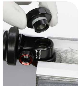
**3** Tire del amortiguador hacia arriba para retirar el otro adaptador de rodamiento.
