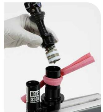
**7** Retire el tubo de plástico cortado del eje del amortiguador.
