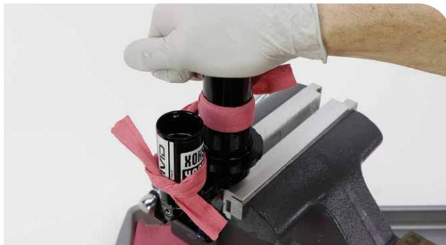
**7** Con la mano todavía apoyada firmemente en el cuerpo del amortiguador (no la retire), coloque la junta tórica del IFP en el depósito del IFP de manera uniforme, con el extremo engrasado de la junta hacia fuera/arriba.
