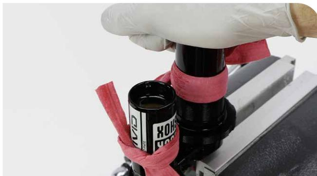
**9** Con la mano todavía cubriendo el cuerpo del amortiguador, golpee ligeramente el extremo del ojal del cuerpo del amortiguador y el depósito con el mango de una llave de plástico para purgar las burbujas de aire restantes.
