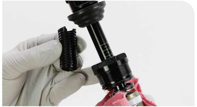
**8** Retire el amortiguador del tornillo de banco y vierta el aceite del cuerpo del amortiguador y del depósito en un recipiente para recoger el aceite.
