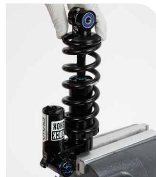
**6** Instale el regulador de rebote y gírelo hasta el ajuste original.
