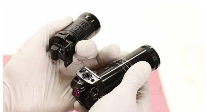
**3** Select+ RCT, Ultimate DH RC2: Desenrosque el perno expuesto izquierdo del depósito (3 mm).
