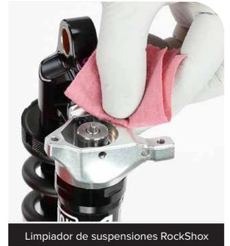
**5** Retire la junta tórica interior del módulo del amortiguador trasero y deséchela. Limpie la ranura de la junta tórica.
