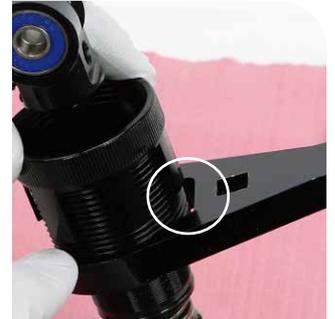
Herramienta de compresión del resorte del cabezal de sellado Counter Measure
