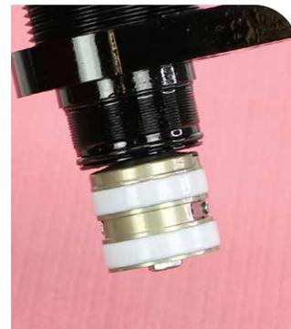
**8** Introduzca un punzón de plástico plano en la ranura del pistón de retención, debajo de la cuña inferior, y haga palanca suavemente en la cuña hacia arriba para que salgan las burbujas de aire atrapadas durante la instalación del pistón y el cabezal de sellado. Al elevar la cuña, se crea una vía de escape para el aceite y la presión del aceite, reduciendo la presión sobre el IFP durante la instalación.
