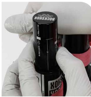
Herramienta de ajuste de altura del IFP
