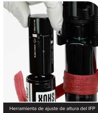
Herramienta de ajuste de altura del IFP
