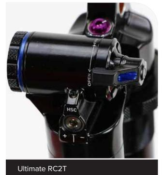
**Select+ RCT, Ultimate RC2T, Ultimate DH RC2:** Gire el mando del regulador de compresión de baja velocidad (LSC) en sentido antihorario hasta la posición de apertura total y cuente el número de clics. [Anote este número](#) como ayuda para la configuración posterior al mantenimiento.
