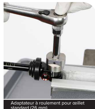
Adaptateur à roulement pour œillet standard (26 mm)
