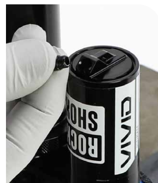
Outil RockShox pour valve Schrader
