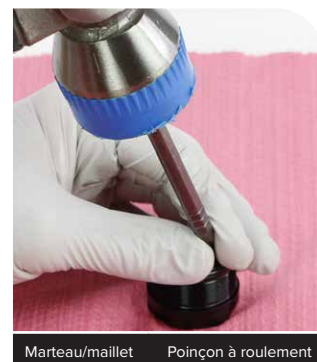
Marteau/maillet Poinçon à roulement
