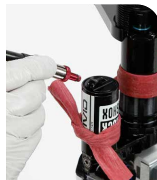
Adaptateur pour valve à air d'amortisseur arrière
