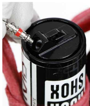
Outil RockShox pour valve Schrader
