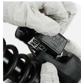
Retrait de la batterie SRAM
