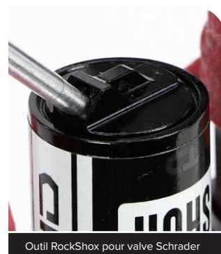
Outil RockShox pour valve Schrader
