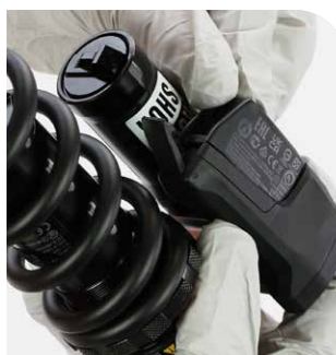
Installation de la batterie SRAM
