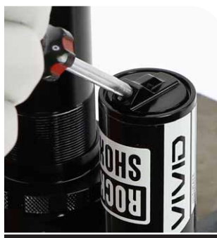
Outil RockShox pour valve Schrader
