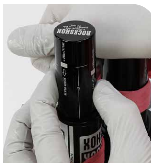
Outil pour la mesure de la hauteur du PFI
