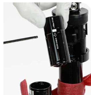
Outil pour la mesure de la hauteur du PFI
