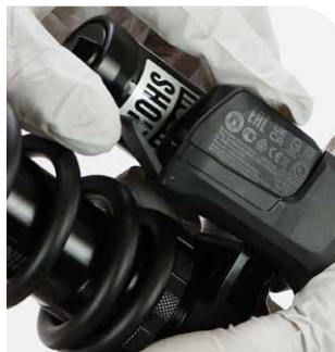
Retrait de la batterie SRAM
