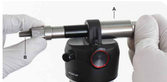
Outil pour bagues d'amortisseur arrière RockShox 1/2 po x 1/2 po
