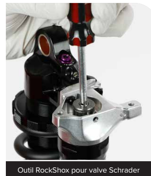
Outil RockShox pour valve Schrader
