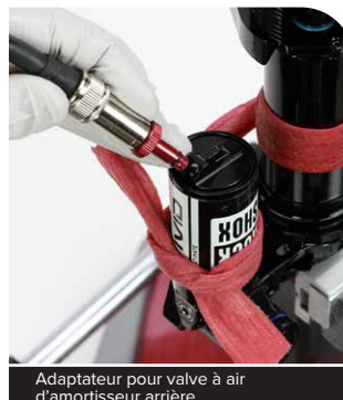
Adaptateur pour valve à air d'amortisseur arrière
