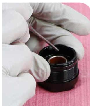
Marteau/maillet Poinçon à roulement
