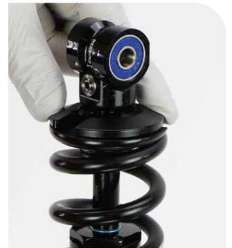
**5** Halten Sie den Federclip so in Position, dass er sich nicht dreht. Drehen Sie den Federvorspannungseinsteller, bis die Schraubenfeder den Federclip berührt. Stellen Sie sicher, dass zwischen der Schraubenfeder, dem Federclip und dem Federvorspannungseinsteller kein senkrechtes Spiel vorhanden ist.
