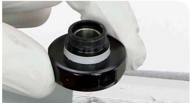
**4** Entfernen Sie die Lagerdeckel von den Lageradaptern.
