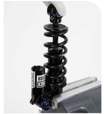
**4** Montieren Sie den Federclip.
