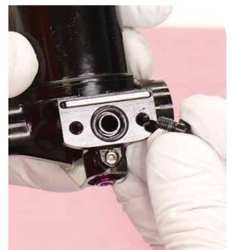
**4** Entfernen Sie den Ausrichtungsstift und den O-Ring des Ausgleichsbehälters.
