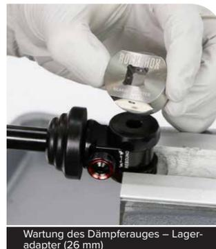
Wartung des Dämpferauges – Lageradapter (26 mm)
