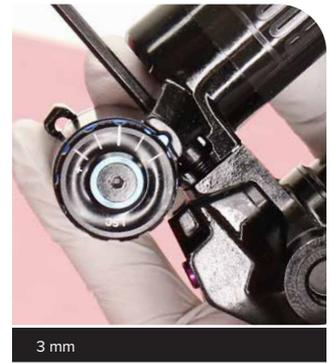
Schrauben Sie die rechte verdeckte Ausgleichsbehälterschraube (3 mm) heraus.
