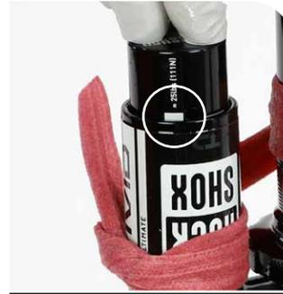
Entlüftungs-Prüfenster (33 mm, 35 mm, 39 mm oder 41 mm)
