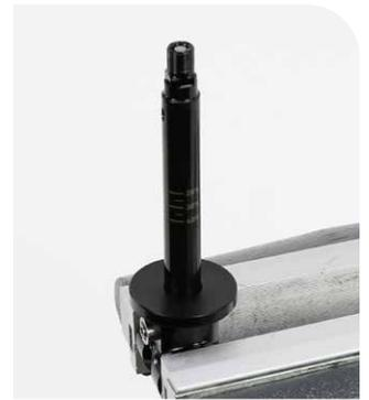
**13** Tragen Sie Schmierfett auf die innere Oberfläche eines neuen unteren Anschlagpuffers auf und montieren Sie ihn. Informationen zur Größe des Anschlagpuffers finden Sie in der folgenden Tabelle.
