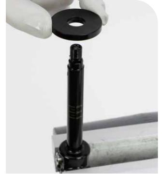
**11** Säubern Sie die Dämpferführungsstange und überprüfen Sie sie auf Beschädigungen. Wenn die Dämpferführungsstange beschädigt oder abgenutzt ist, muss sie ausgetauscht werden.
