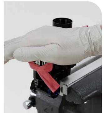
**4** Gießen Sie mehr Öl in den Ausgleichsbehälter und klopfen Sie weiter auf die Oberseite, bis keine Luftblasen mehr aus dem Dämpferkörper aufsteigen.
