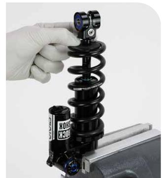
**3** Drehen Sie das Auge in die ursprüngliche Position.
