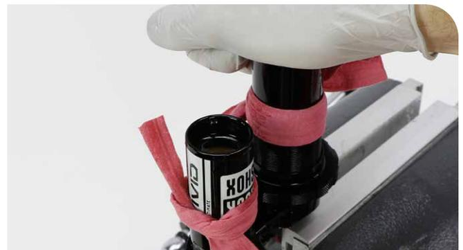
**9** Decken Sie den Dämpferkörper weiterhin mit der Hand ab und klopfen Sie mit dem Kunststoffgriff eines Werkzeugs leicht auf das Ende des Dämpferkörperauges und des Ausgleichsbehälters, um jegliche verbleibende Luftblasen zu entfernen.
