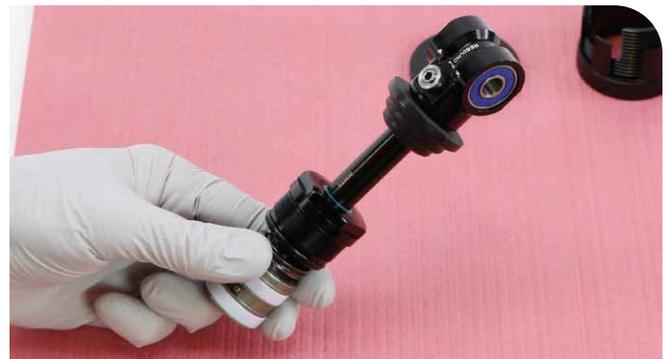
**3** Platzieren Sie den Counter Measure-Schlüssel auf dem Dichtkopf. Decken Sie den Entlüftungsstutzen nicht mit dem Schlüssel ab.
