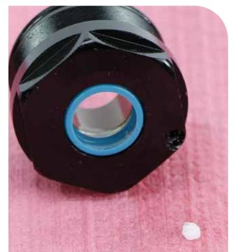
**16** Entfernen Sie die innere Dichtkopf-Abstreiferdichtung und entsorgen Sie sie.
