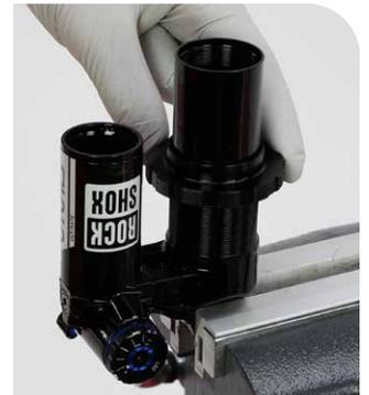
**3** Wickeln Sie ein Werkstatttuch um den Dämpferkörper und den Ausgleichsbehälter, um Öl aufzunehmen.
