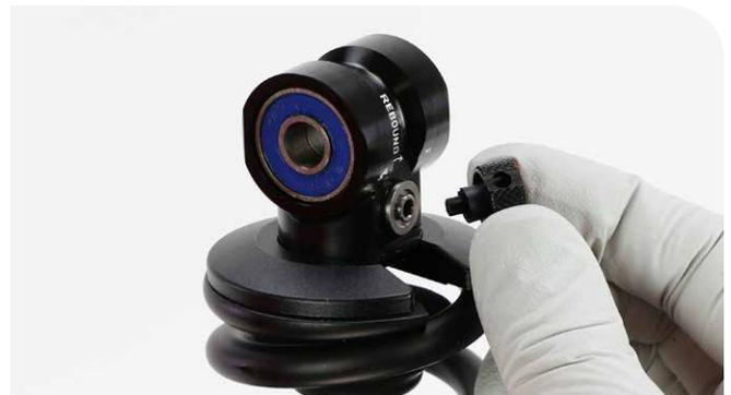
**2** Drehen Sie den Vorspannungseinsteller gegen den Uhrzeigersinn, bis der Federclip lose ist.
