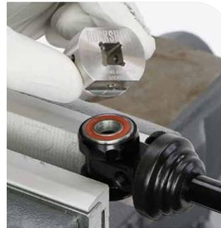
Wartung des Dämpferauges – Lageradapter (26 mm)
