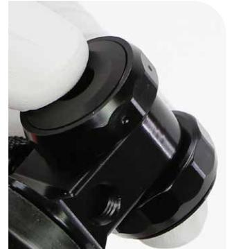
Ein neuer RockShox Lageradapter (26 mm V2) enthält ein Lager in dem Adapter ohne Vertiefung, das nicht vollständig montiert ist und in den Adapter eingepresst werden muss, bevor der Dämpfer an einem Fahrrad montiert werden kann.
