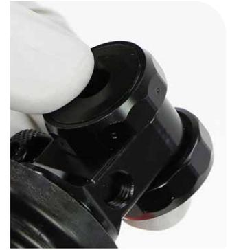
**8** Neuer V2-Lageradapter: Montieren Sie beide Lagerdeckel und platzieren Sie den Lageradapter im Schraubstock.
