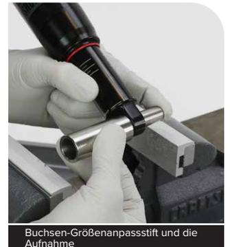
**3** Spannen Sie den Buchsen-Größenanpassstift und die Aufnahme in den Schraubstock ein.
