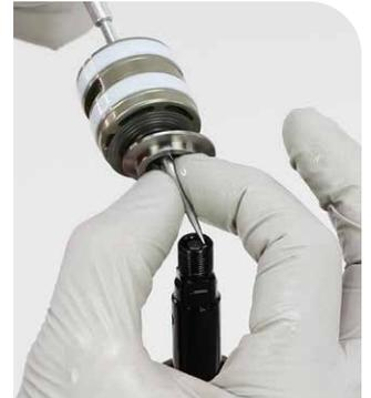
**7** Entfernen Sie die Dichtkopf-Baugruppe.
