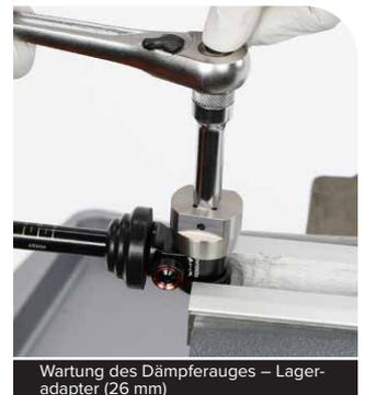
Wartung des Dämpferauges – Lageradapter (26 mm)
