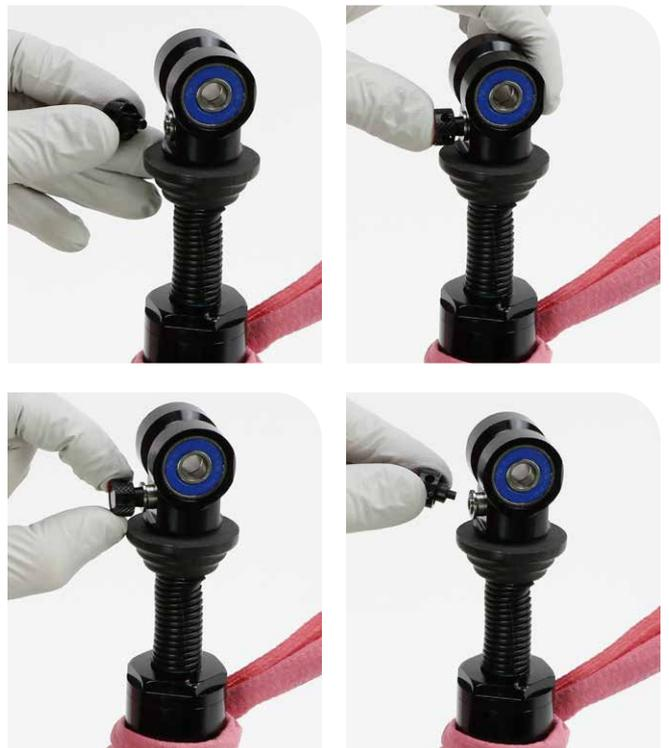
4 Platzieren Sie den Vivid Counter Measure-Schlüssel auf dem Dichtkopf.
