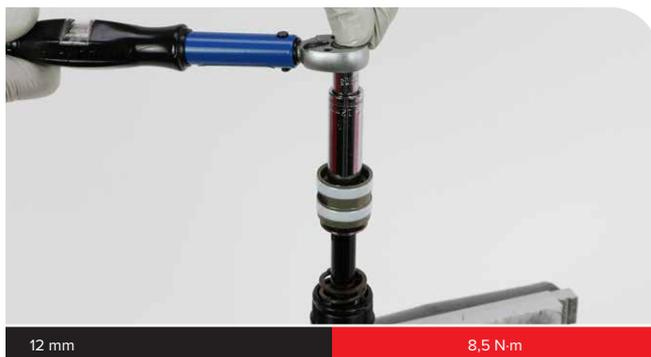
**25** Achten Sie darauf, dass die Öffnungen des Ölregelventils zum Kolben hin ausgerichtet sind, und montieren Sie das Ölregelventil und die Standardplättchen.
