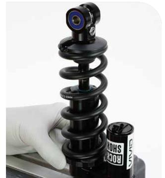
**3** Entfernen Sie den Federclip und die Feder.
