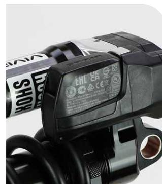
**5** Montieren Sie den SRAM-Akku, um die ordnungsgemäße Funktion des Hinterbaudämpfermoduls zu überprüfen. Der Motor des Hinterbaudämpfermoduls sollte sich ein- und ausschalten, sodass der Druckstufendämpfer auf die offene Position gestellt wird.
