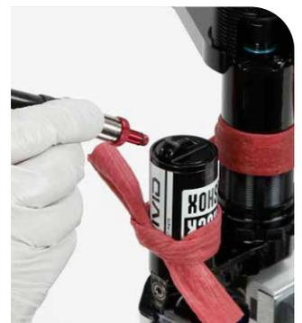
**25** Bringen Sie einen neuen O-Ring an der Luftventilkappe des Ausgleichsbehälters an.
