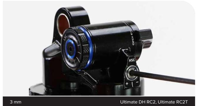
**Base R, Select RT, Select+ RCT, Ultimate DH RC2, Ultimate RC2T, Ultimate Flight Attendant:** Drehen Sie den Hydraulic Bottom Out-Einsteller (HBO) bis zum Anschlag gegen den Uhrzeigersinn in die vollständig offene (-) Position und zählen Sie dabei die Rasterungsklicks. [Notieren Sie sich diese Zahl](#) zur Unterstützung bei der Abstimmung nach der Wartung.
