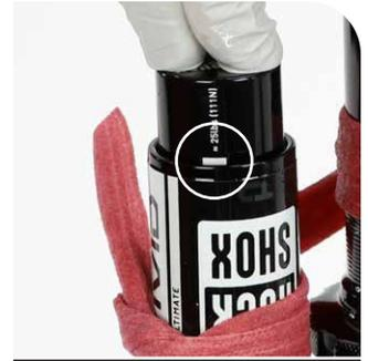
Entlüftungs-Prüfenster (33 mm, 35 mm, 39 mm oder 41 mm)
