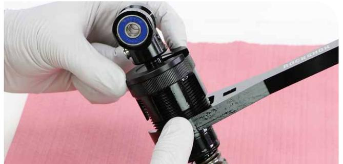
Entlüftungsclip und Counter Measure-Dichtkopffeder-Kompressionswerkzeug
