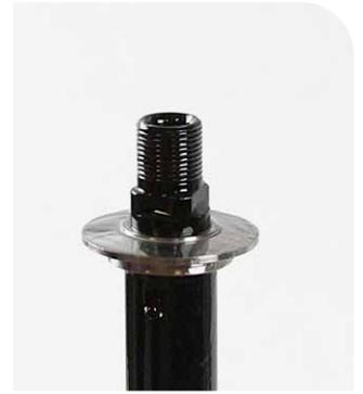
**27** Deslice la pila de cuñas de compresión desde la llave Allen hasta el eje del amortiguador.
