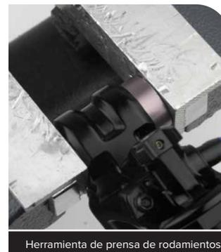
**3** Retire el amortiguador del tornillo de banco. Los rodamientos deben quedar aproximadamente a 1 mm por debajo del borde exterior del orificio de rodamiento.
