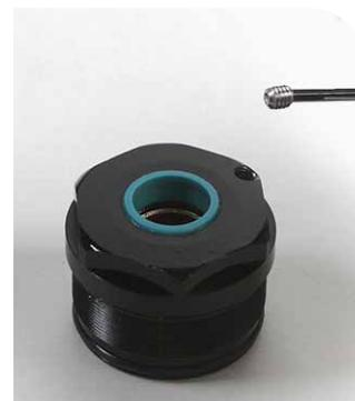
**17** Utilice un pasador de guía de 1,5 mm para empujar la bola de compresión de nailon hasta sacarla por el lado posterior del cabezal de sellado a través del orificio de purgado.
