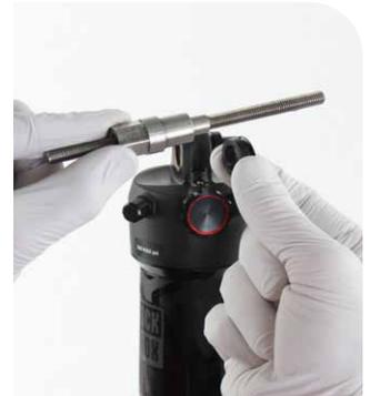
**4** Si no consigue sacar fácilmente el pasador del casquillo, vuelva a insertar la varilla roscada y el pasador de empuje a través del ojal del eje.
