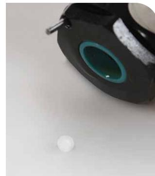
**18** Perfore y retire la junta antipolvo de la varilla.
