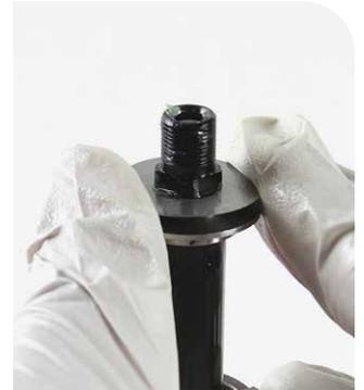
**28** Instale el pistón principal en el eje del amortiguador. Deslice la pila de cuñas de retención desde la llave Allen hasta el eje del amortiguador.
