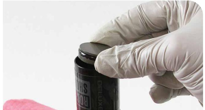
**8** Retire y deseche la junta tórica del pistón IFP. Instale una junta tórica nueva en el IFP. Aplique a la junta tórica grasa para juntas RockShox Dynamic Seal Grease.
