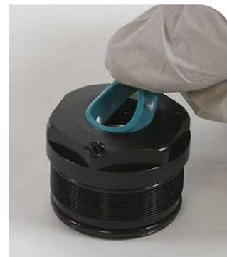
**19** Extraiga y deseche la junta tórica del cabezal de sellado; luego instale una junta tórica nueva.
