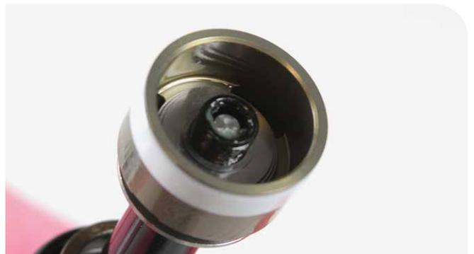
29 Enrosque la tuerca de retención en el eje del amortiguador y apriétela a 8,4 N•m.
