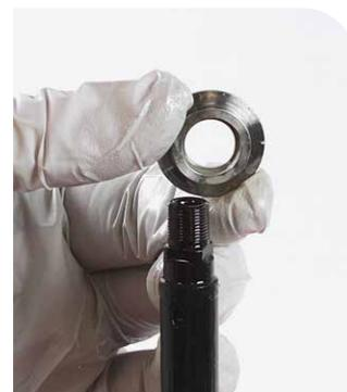
**14** Saque el cabezal de sellado del eje del amortiguador.
