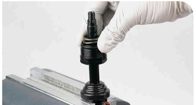
**26** Instale el plato superior en el eje del amortiguador.
