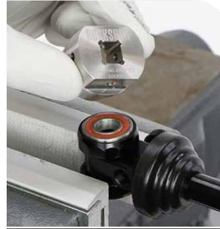
Adaptador de rodamiento del amortiguador trasero (26 mm)
