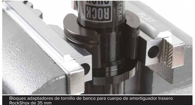
Bloques adaptadores de tornillo de banco para cuerpo de amortiguador trasero RockShox de 35 mm
