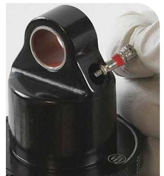
**7** Enrosque la herramienta adaptadora de válvula de aire del amortiguador trasero a una bomba para amortiguadores. Enrosque el adaptador de válvula de aire a la boquilla de llenado de aire del cuerpo del amortiguador.
