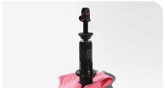
**3** Separe el tope inferior externo del cabezal de sellado.
