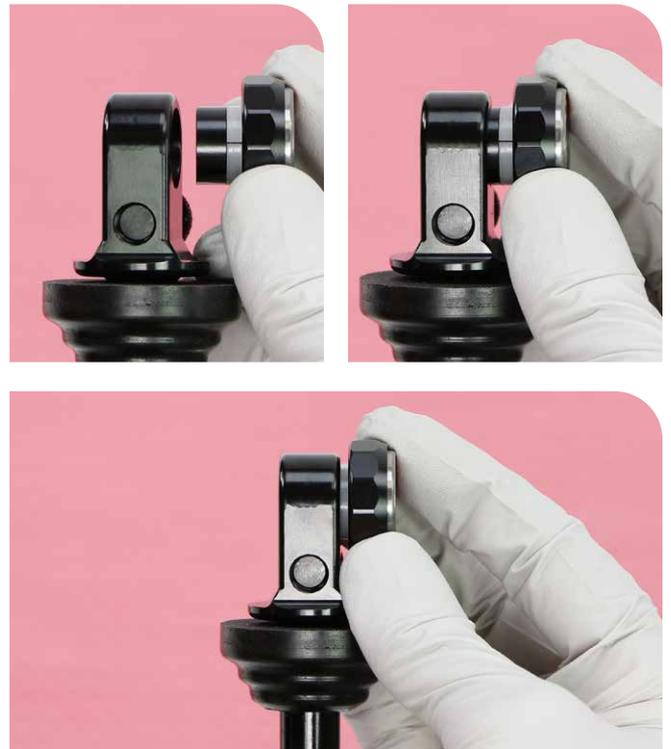
**3** Instale el adaptador de rodamiento roscado exterior (incluye un hoyuelo en cada lado hexagonal) en el ojal y enrósquelo en el rodamiento roscado interior.
