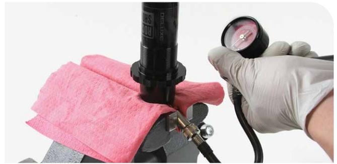
Herramienta RockShox adaptadora de válvula de aire
