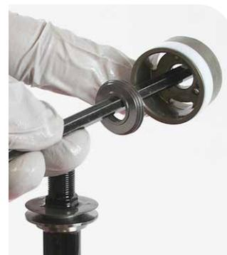
**12** Deslice las cuñas de compresión y el plato superior para sacarlos del eje y recogerlos con una llave Allen o un punzón.
