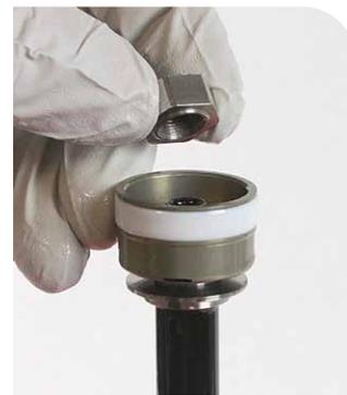
**11** Deslice las cuñas y el pistón para sacarlos del eje y recogerlos con una llave Allen o un punzón.
