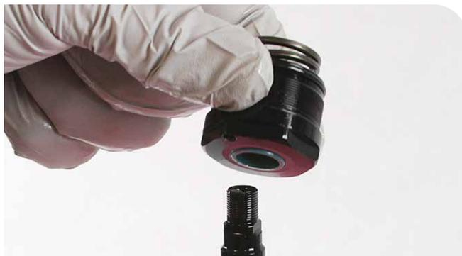
**15** Tire del muelle Counter Measure para sacarlo del cabezal de sellado.
