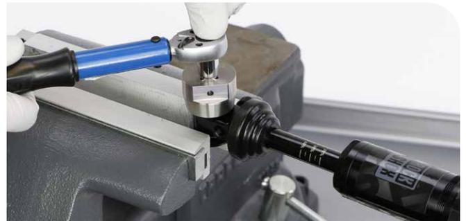
Wartung des Dämpferauges – Lageradapter (26 mm)
