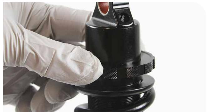
**3** Entfernen Sie die Federhalterung und die Feder.
