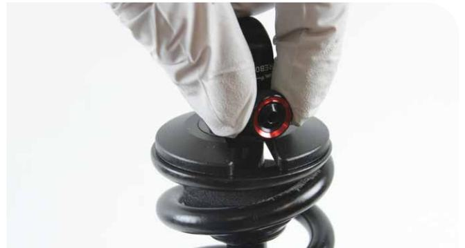
**2** Drehen Sie den Vorspannungseinsteller gegen den Uhrzeigersinn, bis ein großer Spalt zwischen dem Einsteller und der Feder entsteht.
