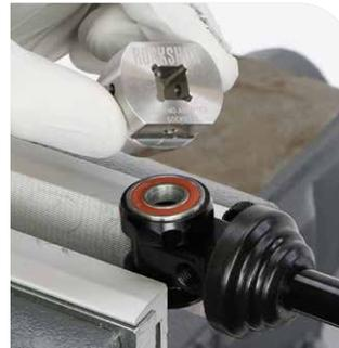
Wartung des Dämpferauges – Lageradapter (26 mm)
