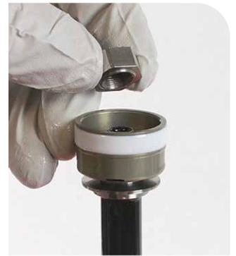
**11** Schieben Sie die Federplättchen und den Kolben von der Führungsstange auf einen kleinen Inbusschlüssel oder Dorn.
