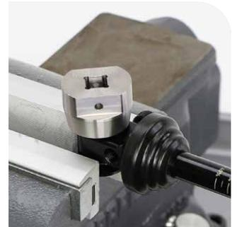
Wartung des Dämpferauges – Lageradapter (26 mm)
