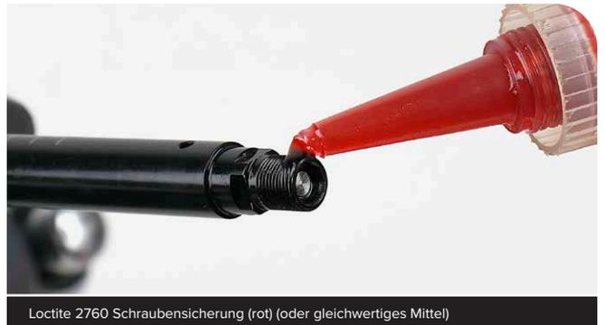
Loctite 2760 Schraubensicherung (rot) (oder gleichwertiges Mittel)
