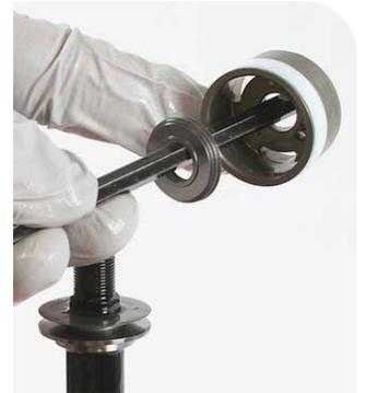
**12** Schieben Sie die Druckstufen-Federplättchen und die obere Anschlagplatte von der Führungsstange auf einen kleinen Inbusschlüssel oder Dorn.
