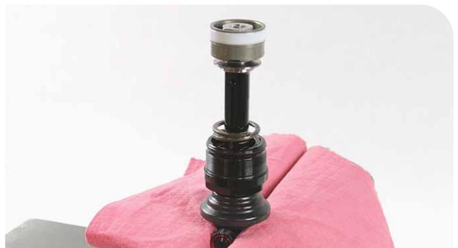
**10** Entfernen Sie die Hauptkolbenmutter.
