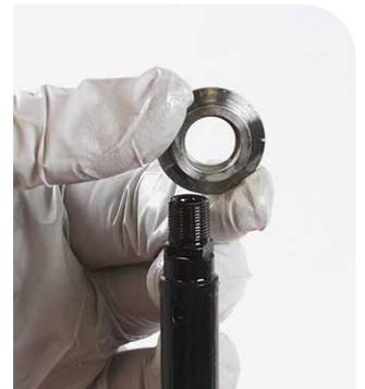
**14** Entfernen Sie den Dichtkopf von der Dämpferführungsstange.
