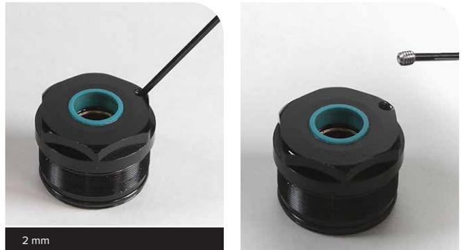
**17** Schieben Sie mit einem 1,5-mm-Führungsstift die Nylandruckkugel durch den Entlüftungsstutzen aus der Rückseite des Dichtkopfes heraus.
