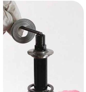
**13** Entfernen Sie die obere Anschlagplatte von der Führungsstange.
