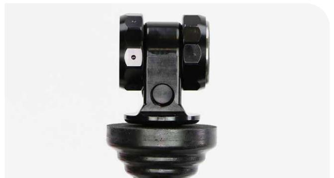
**7** Neuer- und Original-V1-Lageradapter und Original-V2-Lageradapter (falls vor der Wartung ausgebaut): Montieren Sie beide Lagerdeckel.
