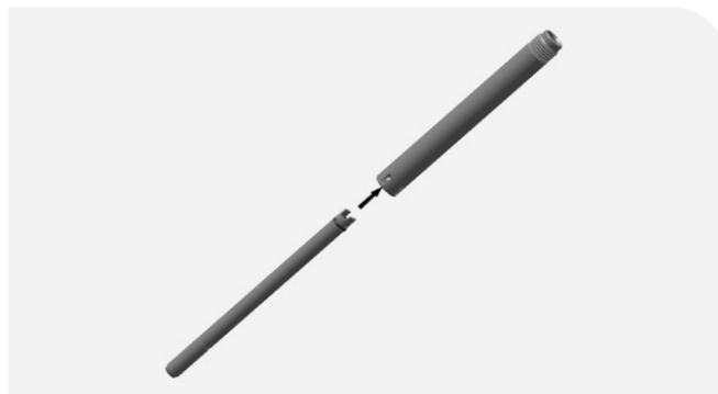
Tragen Sie Schmierfett auf den O-Ring der Zugstufenstange (A) auf.
