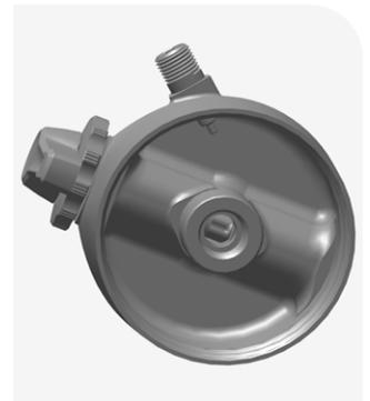
**6 RT3:** Entfernen Sie die Einsteller-Baugruppe (A) von der Dämpferführungsstange (B).
