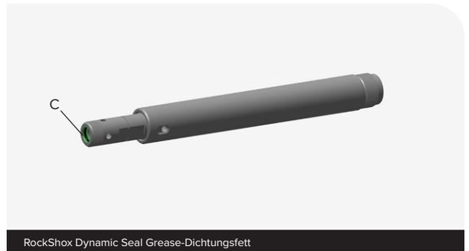
Schieben Sie die Einstellnadel-Baugruppe mit dem O-Ring zuerst bis zum Anschlag in das Auge/Gewindeende der Dämpferführungsstange.
