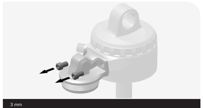
**3** **ALLE:** Entfernen Sie den Ausgleichsbehälteransatz.
