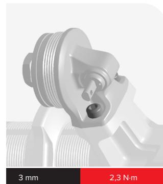
**4** **RT/Select+, RCT/Ultimate:** Montieren Sie den Hebel in der offenen Position.
