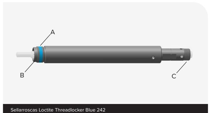
**3** Coloque el conjunto del eje del amortiguador en el ojal y enrósquelo a tope con la mano.
