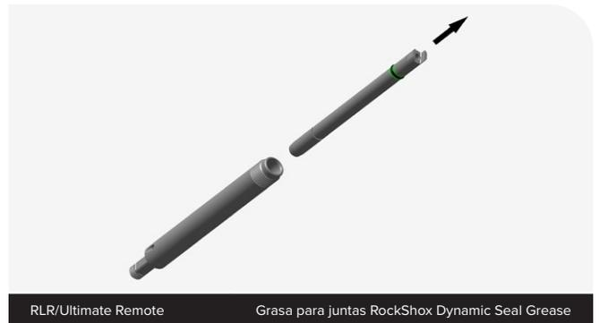
**RE:aktiv, RE:aktiv Thru Shaft, NUDE RL3/NUDE RLC3:** Desmonte el conjunto del ajustador (A) del eje del amortiguador (B).
