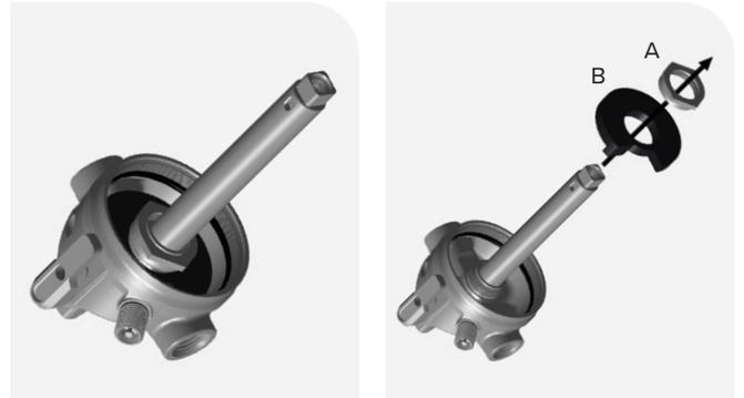
**3** **RL/Select+, RL/Ultimate, RLR/Select+, RLR/Ultimate Remote:** Sujete el eje del amortiguador en adaptadores para tornillo de banco RockShox (3 orificios, ranura de 10 mm) con las roscas hacia abajo, justo por debajo del ojal.
