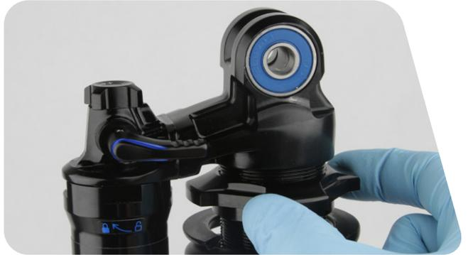
**29** Consulte los ajustes de rebote y compresión del amortiguador que anotó al iniciar el mantenimiento. Ajuste cada regulador con el número registrado de clics/vueltas.
