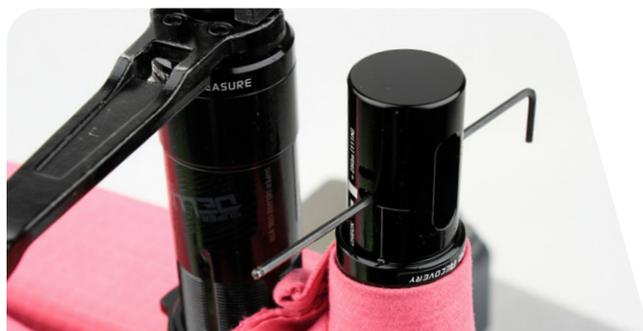
Herramienta de ajuste de altura del IFP
