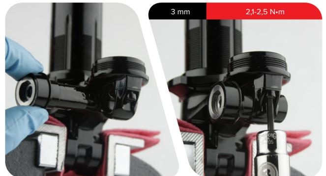
**14** Instale el resorte de bloqueo y la cuña de bloqueo en el soporte del depósito.
