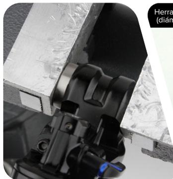
Herramienta de prensa de casquillos de 22 mm (diámetro externo) x 10 mm (diámetro interno)
