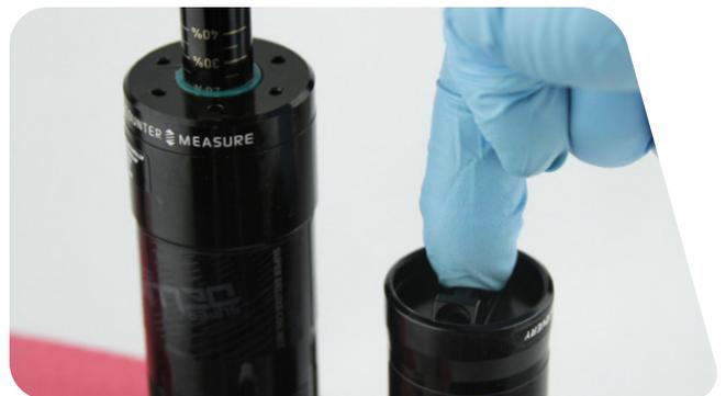
**5** Retire el anillo de retención del depósito del IFP.
