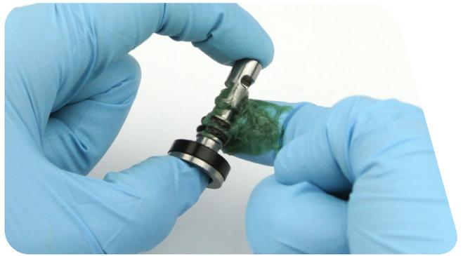
**9** Aplique una buena capa de grasa al interior y el exterior de un resorte de control remoto nuevo; a continuación, instale el resorte en la leva, con la cola del resorte insertada en el orificio correspondiente.
