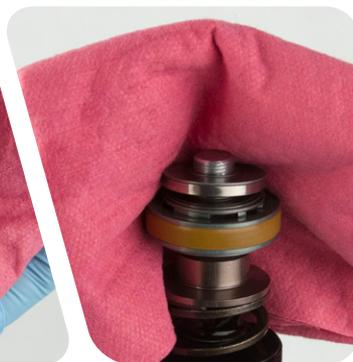
**14** Deslice el conjunto del pistón principal y la placa superior para sacarlos del eje y recogerlos con una llave Allen pequeña o un punzón.
