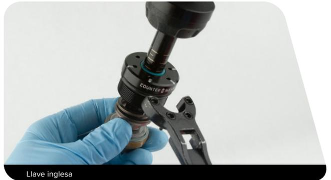
**2** Monte el compresor Counter Measure de modo que el tope 1 quede en el extremo del eje y apriete el perno de tope 1.
