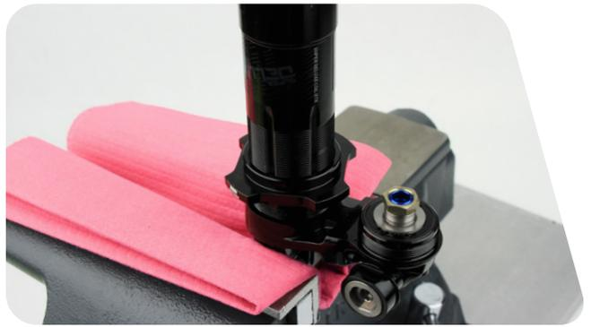
**4** Enrosque el depósito del IFP en el ojal. Apriete el depósito del IFP.
