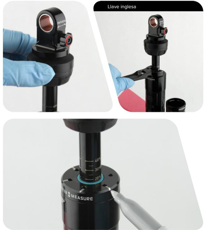
**10** Afloje y retire lentamente el conjunto del eje del cuerpo del amortiguador.
