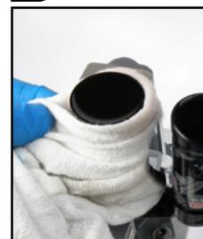
53. Fassen Sie die Führungsstangen-Baugruppe beim Dichtkopf, und schrauben Sie den Dichtkopf **langsam** von Hand auf den Dämpfer. Eingeschlossene Luft und überschüssiges Öl sollten durch die Kerben im Gewinde des Dichtkopfs austreten.
