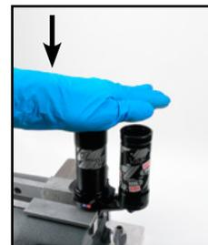
47. Nachdem der Großteil des Öls (jedoch nicht das ganze Öl) aus dem Dämpferkörper in den Ausgleichsbehälter gelaufen ist, klopfen Sie mit dem Handballen mehrmals von oben auf den Ausgleichsbehälter, damit das Öl zurück in den Dämpferkörper läuft. Dies hilft zusätzlich beim Entfernen von Luftblasen aus dem System. Achten Sie darauf, dass der Ölstand im Dämpferkörper oder Ausgleichsbehälter nicht so sehr abfällt, dass Luft in das System gelangen kann.
