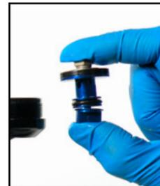
35. Trennen Sie den inneren Einsteller, die Rastkugel und die Rastfeder von der Lowspeed-Druckstufenventil-Baugruppe.
