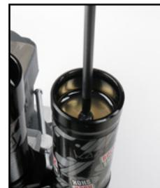
50. Füllen Sie weiteres Öl in den Dämpferkörper, bis der Ölstand 3 mm unter dem oberen Rand liegt.
