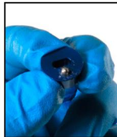
40. Tragen Sie Fett auf die Rastfeder auf und setzen Sie sie in den inneren Einsteller ein. Tragen Sie erneut Fett auf die Rastfeder auf und platzieren Sie die Rastkugel auf der Feder.
