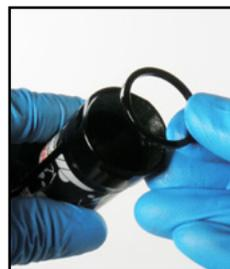
29. Verwenden Sie einen Dorn, um den Gleitring und die Vierkantdichtung des IFP zu entfernen und zu ersetzen.
