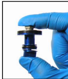
42. Führen Sie die Low-speed-Druckstufenventil-Baugruppe vorsichtig mit dem inneren Einsteller zuerst in den Dämpferkörper ein. **Führen Sie die Low-speed-Druckstufenventil-Baugruppe mit dem Finger an die richtige Position.**
