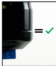
43. Schrauben Sie den IFP-Ausgleichsbehälter von Hand auf den Dämpferkörper, bis er fest sitzt. Ziehen Sie den Ausgleichsbehälter mit einem 31-mm-Flachschlüssel oder einem Bandschlüssel mit 11,3 N•m an. Zwischen dem IFP-Ausgleichsbehälter und dem Dämpferkörper verbleibt ein schmaler, sichtbarer Spalt. Das ist in Ordnung.
