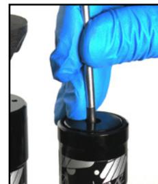
7. Entfernen Sie mit einem T-10 TORX®-Schlüssel die Einfüllkappe von der Kappe des IFP-Ausgleichsbehälters und lassen Sie die Luft ab, indem Sie das Ventil betätigen. Verwenden Sie ein Schrader-Ventileinsatzwerkzeug, um den Einsatz des Schrader-Ventils zu entfernen.
