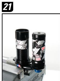
22. Drücken Sie mit einem Finger die Kappe des IFP-Dichtkopfes bis zum Anschlag in den IFP-Ausgleichsbehälter.
