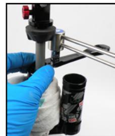
54. Fahren Sie damit fort, den Dichtkopf nach unten zu schrauben, bis der O-Ring den Dämpferkörper berührt. Ziehen Sie den Dichtkopf mit dem 24-mm-Stiftschlüssel mit 33,9 N·m an. Halten Sie den 24-mm-Stiftschlüssel mit einer Hand fest, während Sie ihn mit der anderen Hand drehen.
