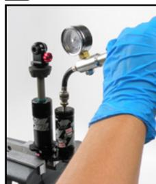
die Einfüllkappe in die Kappe des IFP-Ausgleichsbehälters.
