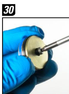
31. Verwenden Sie einen Dorn, um den O-Ring der IFP-Entlüftungsschraube zu entfernen und zu ersetzen.
