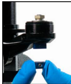
34. Drücken Sie die Lowspeed-Druckstufenventil-Baugruppe mit den Fingern zusammen, und schieben Sie sie vorsichtig nach oben und aus dem Sockel des IFP-Ausgleichsbehälters.
