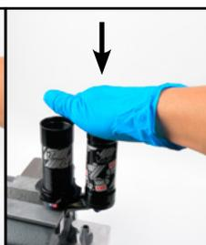
Fahren Sie damit fort, auf die Oberseite des Dämpferkörpers und des Ausgleichsbehälters zu klopfen, bis auf beiden Seiten keine Luftblasen mehr aufsteigen.
