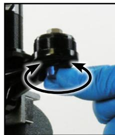
**Die Low-speed-Druckstufenventil-Baugruppe muss bündig mit der Oberseite des IFP-Ausgleichsbehälters abschließen. Achten Sie darauf, den O-Ring während des Einbaus nicht zu beschädigen.**
