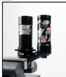
45. **Nur Kage RC:** Drehen Sie den Lowspeed-Druckstufeneinsteller bis zum Anschlag gegen den Uhrzeigersinn.
