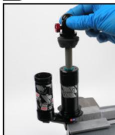
55. Drehen Sie das Führungsstangenauge und die Führungsstange, um das Führungsstangenauge auf das Dämpferkörperauge auszurichten.
