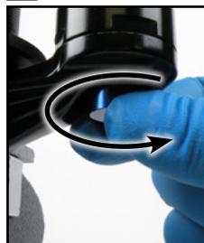
46. Befüllen Sie den Dämpferkörper vollständig mit RockShox 3 WT-Federungsöl. Öl beginnt in den IFP-Ausgleichsbehälter abzulaufen. Klopfen Sie mit dem Handballen mehrmals auf das obere Ende des Dämpferkörpers, damit das Öl in den Ausgleichsbehälter fließt. Dies hilft auch beim Entfernen von Luftblasen aus dem System.
