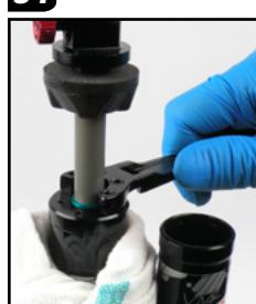
扭矩扳手应按 90 度角度连接 24 mm 销子螺丝扳手，以获得准确的扭矩读数。
