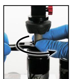
8. 用 SRAM 24 mm 销子螺丝扳手旋松并旋下阻尼器密封头。
