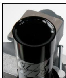
52. 将密封头抵住轴组件上的活塞。将活塞以 45 度角放入减震器身顶部油液中。转动轴 / 活塞组件 2-3 次，使活塞组件中的空洞充满油液。继续转动轴组件将其垂直对齐，然后将组件轻轻插入减震器身。这一过程将在组装过程中最大程度减少残留空气。
