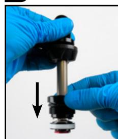
53. 握住轴组件的密封头，并用手指将密封头缓缓旋到减震器上。残留空气和油液会通过密封头螺纹锯齿逸出。
