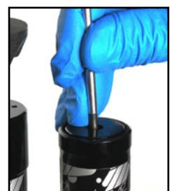
7. 用 T10 TORX® 扳手卸下 IFP 储油罐盖上的注油盖，并压下阀门释放空气。用美式嘴阀工具卸下美式嘴阀核。
