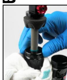
54. 继续向下旋转密封头，直到密封头 O 型圈接触减震器身。用 24 mm 销子螺丝扳手工具将密封头紧固至 33.9 N·m。用一只手紧紧握住 24 mm 销子螺丝扳手，同时用另一只手紧固。
