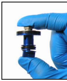
42. 将低速压缩阀组件小心地插入减震器身，内部旋钮在前。
