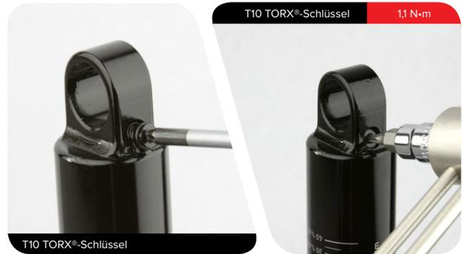
**18** Entfernen Sie die IFP-Entlüftungsschraube vom IFP.
