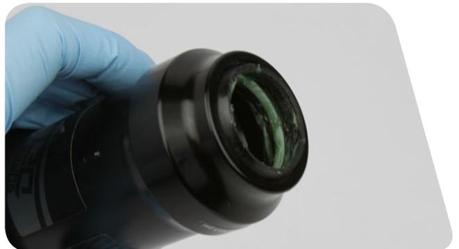
**10** Entfernen Sie die Dichtung der Dichtkopf/Luftkolben-Baugruppe und die Gleitringe.
