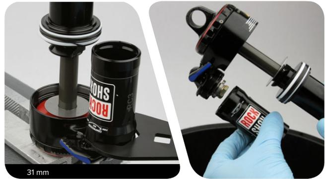
**8** Schieben Sie den IFP aus dem IFP-Ausgleichsbehälter.
