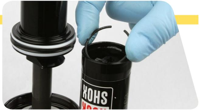
**25** Ziehen Sie die Kappe des IFP-Ausgleichsbehälters nach oben, damit sie am Sprengring anliegt.
