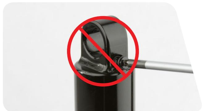
**2** Verwenden Sie ein Schrader-Ventileinsatzwerkzeug, um den Ventileinsatz aus dem Ventil des IFP-Ausgleichsbehälters zu entfernen.
