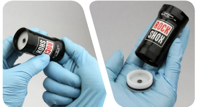
**9** Entfernen Sie die IFP-Entlüftungsschraube.
