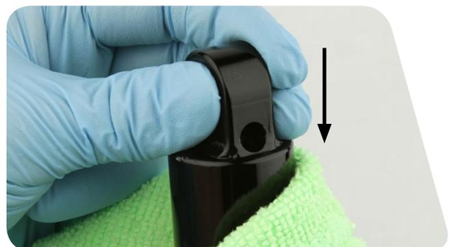
**16** Wenn der Dämpferkörper vollständig heruntergedrückt ist und dennoch Luftblasen vorhanden sind, bringen Sie die Dämpfer-Entlüftungsschraube wieder an, entfernen Sie die IFP-Entlüftungsschraube und wiederholen Sie die Schritte 11 bis 15, bis keine Luftblasen mehr vorhanden sind.
