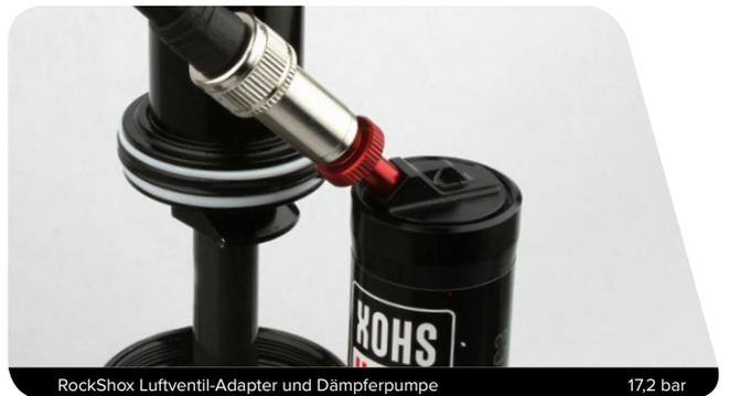
RockShox Luftventil-Adapter und Dämpferpumpe
