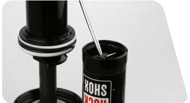
**26** Bauen Sie das Schrader-Ventil wieder in die Kappe des IFP-Ausgleichsbehälters ein.
