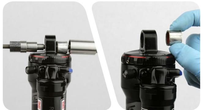
Bevor Sie Ihren Hinterbau-Dämpfer warten, bauen Sie ihn gemäß den Anweisungen des Fahrradherstellers aus dem Fahrradrahmen aus. Nachdem Sie den Dämpfer aus dem Fahrrad ausgebaut haben, entfernen Sie die Befestigungsteile, bevor Sie zur Wartung übergehen (siehe Abschnitt [Wartung der Befestigungsteile und Buchsen](#)).
