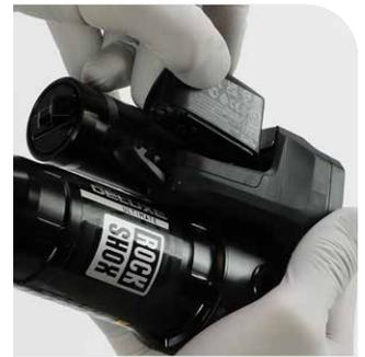
Extracción de la batería SRAM
