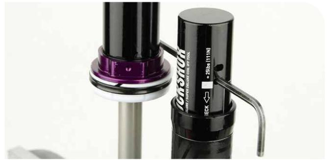
Herramienta de ajuste de altura del IFP
