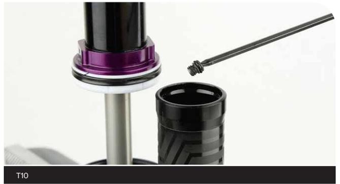
Enrosque la herramienta extractora del IFP RockShox en el IFP; a continuación, retire la herramienta y el IFP del depósito.
