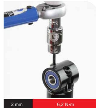
Coloque los guardapolvos del rodamiento cuando el amortiguador esté instalado de nuevo en la bicicleta.
