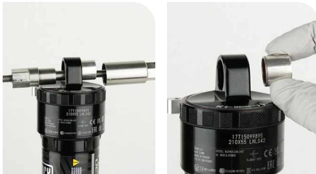
**Actualización opcional (solo cuadros con soporte de rodamiento):** Ojal estándar a adaptador de rodamiento. Continúe con [Instalación del ojal estándar en el adaptador de rodamiento](#).
