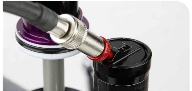
Bomba para amortiguadores y herramienta adaptadora para válvulas de aire RockShox
