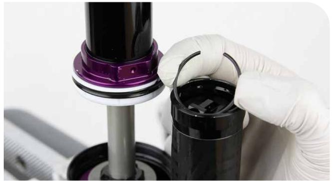
**5** Quite la tapa del depósito del IFP del propio depósito.
