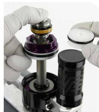
Cubra el depósito con una toalla cuando empuje el IFP hacia abajo para evitar que el aceite salga por el orificio de purgado del IFP.
