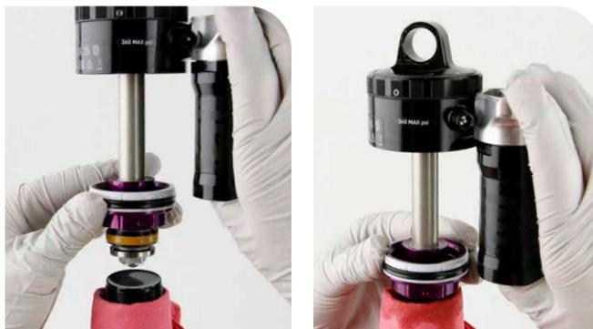
11 Apriete el cabezal de sellado/pistón neumático.
