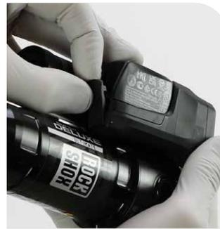
Extracción de la batería SRAM
