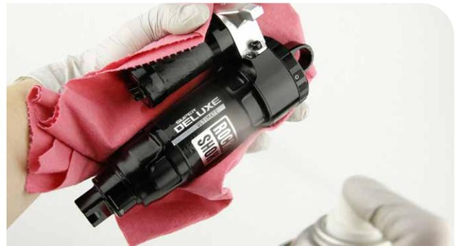
**8** Instale la junta tórica del indicador de hundimiento.
