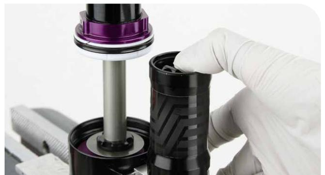
**4** Retire el anillo de retención del depósito del IFP.
