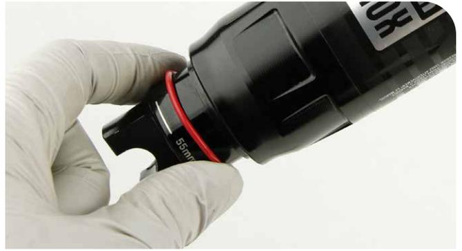
**9** Aplique suficiente presión al amortiguador como para extender su cuerpo en toda su longitud, unos 3,5 bar.
