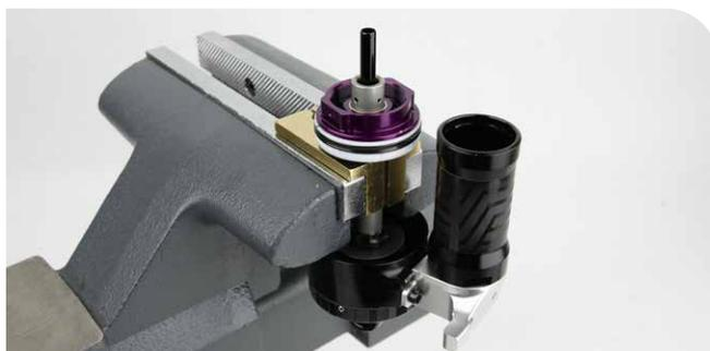
Bloque adaptador de tornillo de banco para amortiguadores traseros RockShox
