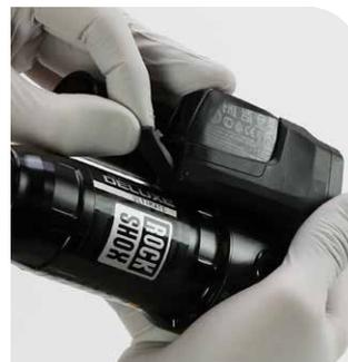
Instalación de la batería SRAM
