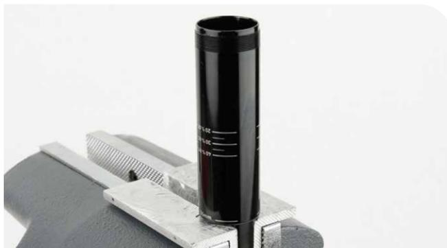
9 Vierta aceite para suspensiones RockShox 7wt en el cuerpo del amortiguador hasta llegar a la parte superior.
