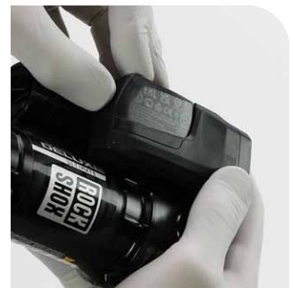
Instalación de la batería SRAM
