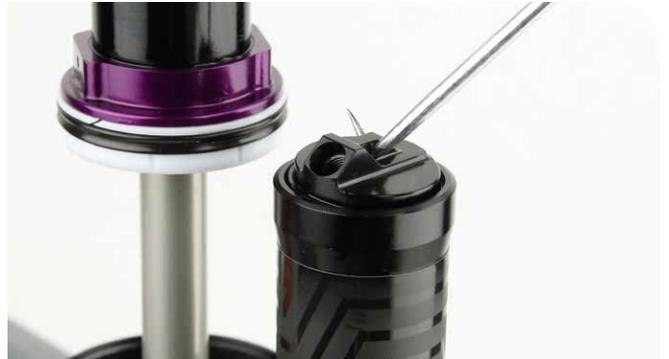
**6** Retire la junta tórica de la tapa del depósito del IFP.
