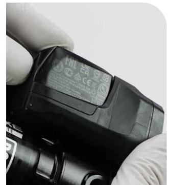
**5** Para confirmar que el módulo del amortiguador trasero funciona correctamente, instale la batería SRAM. El motor del módulo del amortiguador trasero debe ejecutar un ciclo de encendido para ajustar el amortiguador de compresión hacia la posición abierta.
