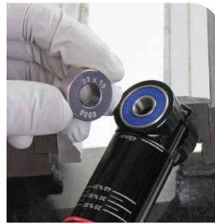
Herramienta de prensa de rodamientos de 22 mm (diámetro exterior) x 10 mm (diámetro interior)
