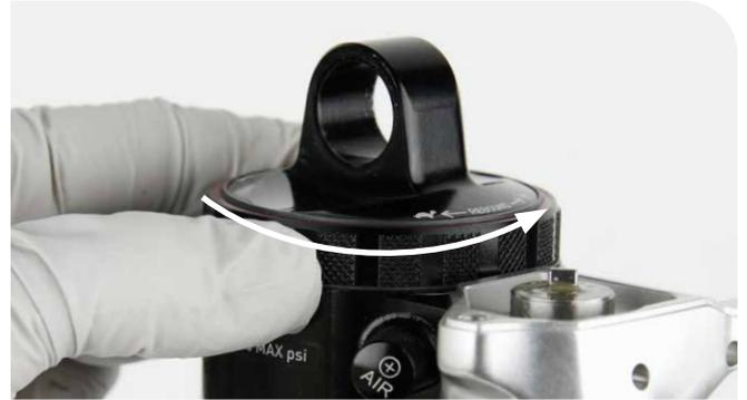
**2** Registre el ajuste de presión de aire como ayuda para la configuración posterior al mantenimiento.
