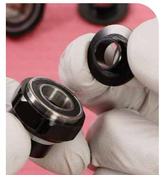
**2** Vérifiez que la rondelle d'écrasement est parfaitement installée dans la cannelure de l'adaptateur.
