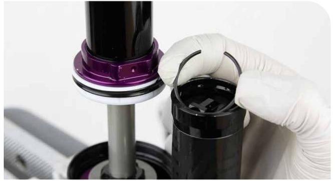
**5** Retirez le capuchon du réservoir du PFI situé sur le réservoir du PFI.
