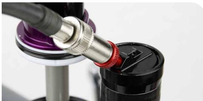
Adaptateur pour valve à air RockShox et pompe pour amortisseur
