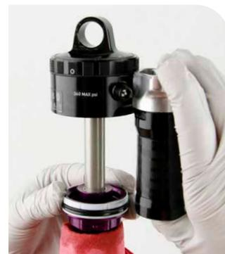
11 Serrez l'unité tête d'étanchéité/piston à air.
