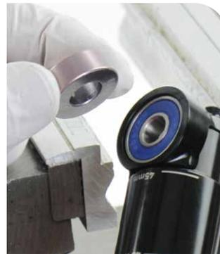
**3** Insérez une entretoise neuve dans l'œillet puis installez un roulement neuf dans l'autre emplacement.
