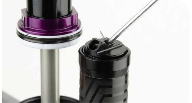
**6** Retirez le joint torique du capuchon du réservoir du PFI.
