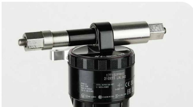
**4** Maintenez le receveur en place à l'aide d'une clé de 13 mm.
