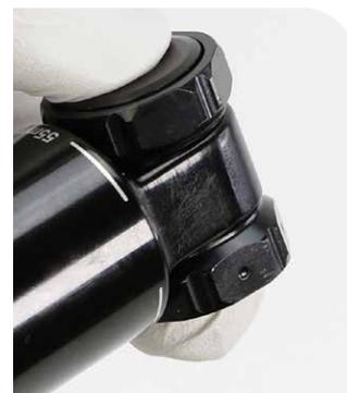
**7 Adaptateur à roulement neuf** : installez les deux protections des roulements et positionnez l'adaptateur à roulement dans l'étau.
