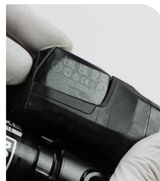
**5** Pour vérifier le bon fonctionnement du module de l'amortisseur arrière, installez la batterie SRAM. Le moteur du module de l'amortisseur arrière doit effectuer la mise sous tension et faire passer la cartouche de compression en position ouverte.
