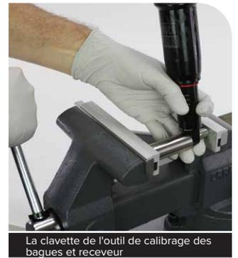
La clavette de l'outil de calibrage des bagues et receveur
