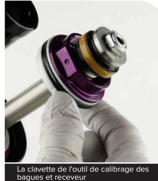
La clavette de l'outil de calibrage des bagues et receveur
