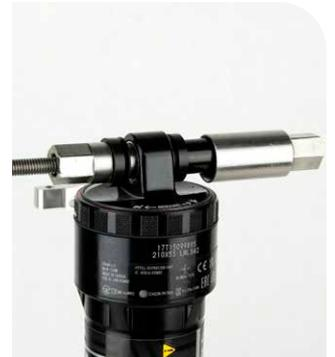
**4** Si la clavette de la bague ne se retire pas facilement, dévissez la clavette de pression de la tige filetée pour retirer l'entretoise de butée, puis remettez en place la clavette de pression sur la tige filetée.
