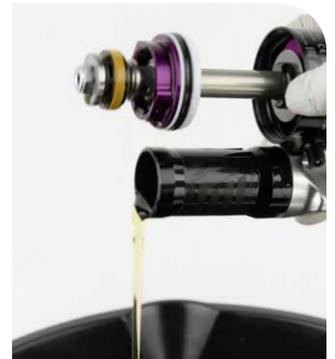
**7** Retirez l'amortisseur hors de l'étau, puis faites coulisser l'unité tête d'étanchéité/piston à air jusqu'à ce qu'elle se bloque à l'extrémité de la tige de la cartouche d'amortissement.
