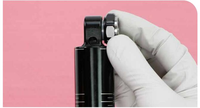
**3** Installez l'adaptateur à roulement avec filetage externe (avec poinçon sur ses bords hexagonaux) dans l'œillet et vissez-le dans le roulement avec filetage interne.
