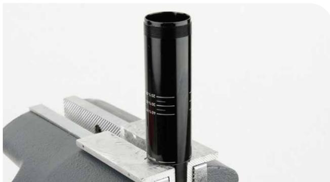
9 Versez de l'huile de suspension 7wt dans le corps de la cartouche d'amortissement jusqu'à ce qu'il soit plein.
