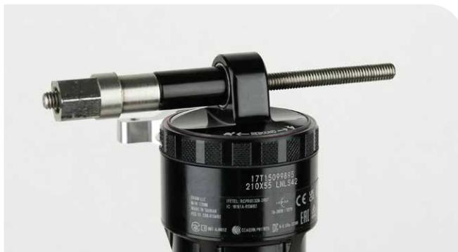
**3** Vissez l'extrémité ouverte et large du receveur sur la tige jusqu'à ce qu'il vienne en appui contre l'œillet.
