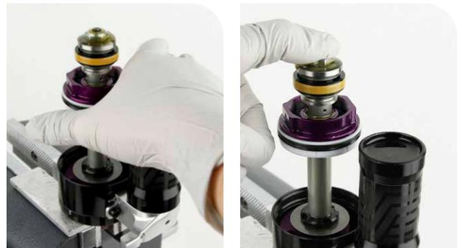
**5** Avec votre doigt toujours positionné sur l'ouverture de la tige de la cartouche d'amortissement, versez de l'huile de suspension 7wt dans le réservoir du PFI jusqu'à ce que son niveau affleure avec le haut du réservoir.
