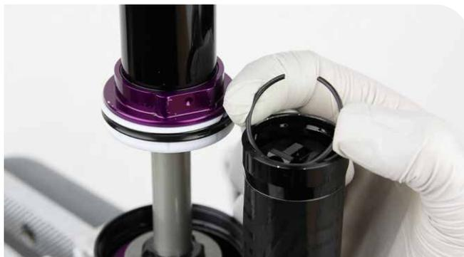
**5** Entfernen Sie die Kappe des IFP-Ausgleichsbehälters vom IFP-Ausgleichsbehälter.
