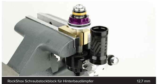
RockShox Schraubstockblock für Hinterbaudämpfer
