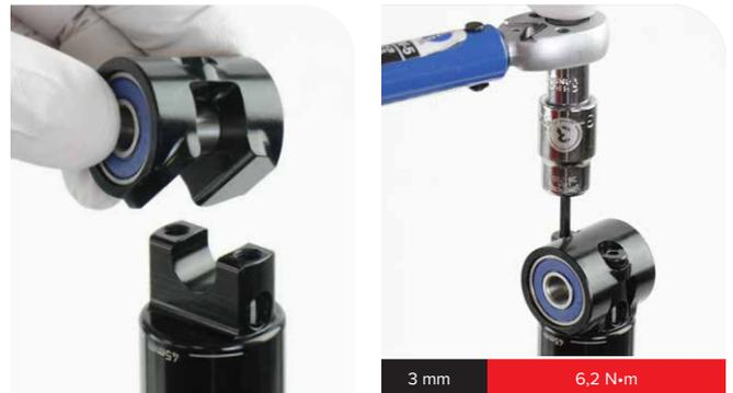
Bringen Sie die Staubabdeckungen der Lager wieder an, wenn der Dämpfer wieder in das Fahrrad eingebaut wird.
