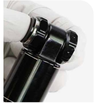
Ein neuer Lageradapter (23 mm) enthält ein Lager in dem Adapter ohne Vertiefung, das nicht vollständig montiert ist und in den Adapter eingepresst werden muss, bevor der Dämpfer in ein Fahrrad eingebaut werden kann.
