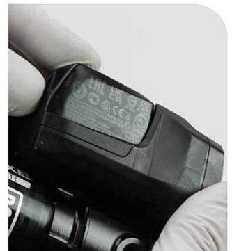
**5** Um zu überprüfen, ob das Hinterbaudämpfermodul ordnungsgemäß funktioniert, montieren Sie den SRAM-Akku. Der Motor des Dämpfermoduls sollte einen Neustart durchführen, sodass der Druckstufendämpfer in die offene Position gestellt wird.
