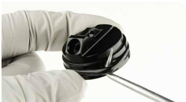
**7** Entfernen Sie die Entlüftungsschraube.
