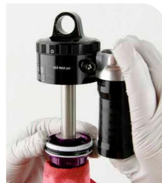
11 Ziehen Sie den Dichtkopf/Luftkolben an.
