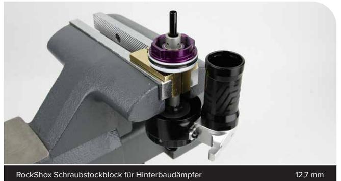
**13** Setzen Sie die Hauptkolben-Baugruppe, die Sie in Schritt 4 entfernt haben, auf die Dämpfer-Führungsstange auf.
