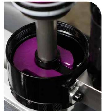
Schieben Sie die untere Anschlägscheibe und den Anschlagpuffer wieder nach unten.
