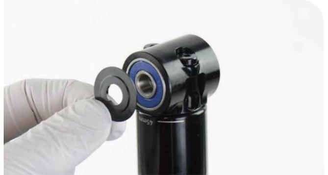
**2 Dämpferaugs:** Spannen Sie das Auge in Schraubstockblöcken aus Aluminium oder Kunststoff fest in einen Schraubstock ein. Platzieren Sie das Auge sicher auf einer flachen Oberfläche.
