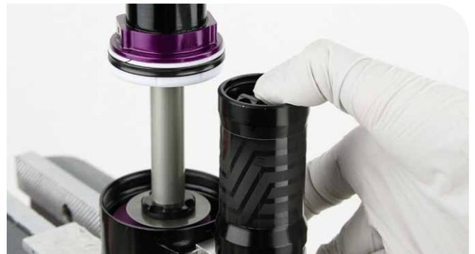
**4** Entfernen Sie den Sicherungsring vom IFP-Ausgleichsbehälter.
