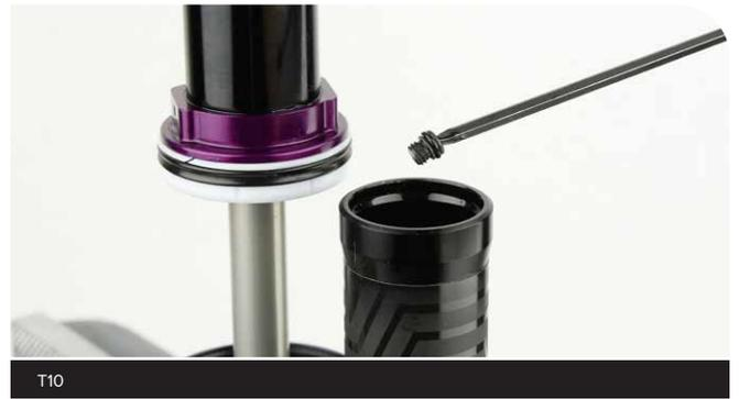
Schrauben Sie den RockShox-IFP-Abzieher in den IFP und ziehen Sie dann den IFP-Abzieher und den IFP aus dem Ausgleichsbehälter.
