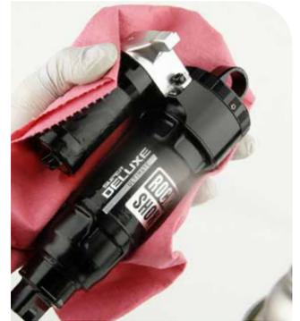
Ersetzen Sie den O-Ring bzw. die Dichtung durch ein neues Teil aus dem Wartungssatz. Entfernen Sie den O-Ring bzw. die Dichtung mit den Fingern oder einem Dorn.
