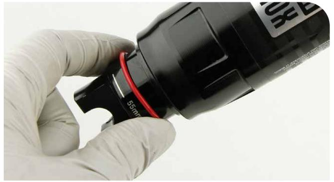
**9** Beaufschlagen Sie den Dämpfer mit ausreichend Druck, um den Dämpferkörper auf die volle Länge auszufahren, etwa 3,5 bar.
