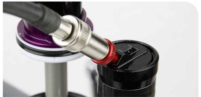
RockShox Luftventil-Adapter und Dämpferpumpe
