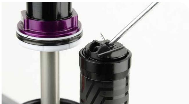
**6** Entfernen Sie den O-Ring der Kappe des IFP-Ausgleichsbehälters. Montieren Sie einen neuen O-Ring.
