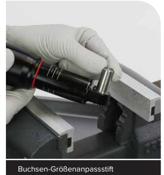
**2** Positionieren und halten Sie auf der gegenüberliegenden Seite der Buchse die Aufnahme für den Buchsen-Größenanpassstift gegen die Buchse.
