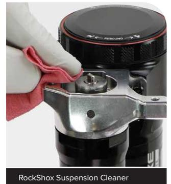
**5** Entfernen Sie den inneren O-Ring vom Hinterbaudämpfermodul und entsorgen Sie ihn. Säubern Sie die O-Ring-Nut.
