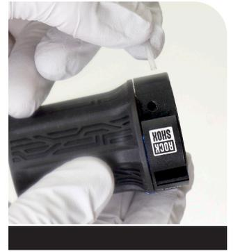
**6** Retire y deseche la junta tórica del acelerador.
