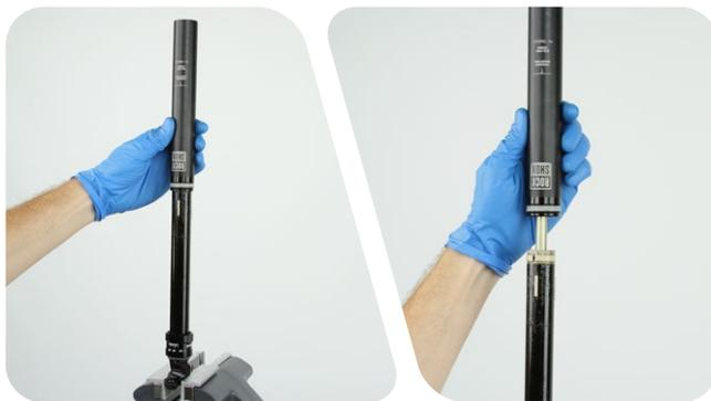
**11** Retirez la bague en mousse ainsi que le joint torique de talonnage. Nettoyez l'intérieur et l'extérieur de la tige inférieure avec un chiffon et de l'alcool isopropylique, puis mettez-la de côté.
