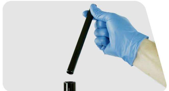
**3** Retirez le piston flottant interne (PFI) situé dans la tige supérieure. Introduisez un par un entre sept et neuf serre-câbles en plastique (leur taille est indifférente) à l'intérieur de la tige supérieure et à travers le centre du PFI.
