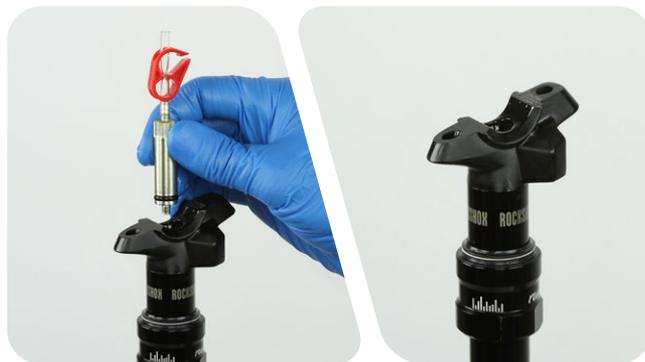
**10** L'excès de liquide contenu dans la tige supérieure doit être retiré.
