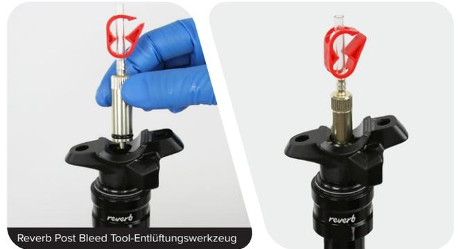
Schließen Sie die Entlüftungsschlauchklemme.
