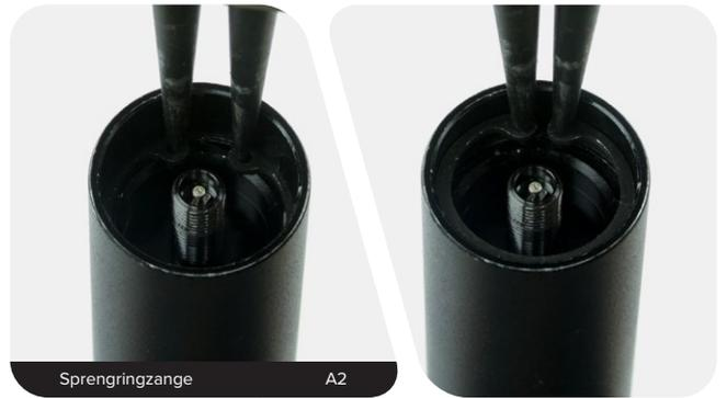
**B1:** Heben Sie das abgeschrägte Ende des Sicherungsringes an und entfernen Sie den Sicherungsring von der Sattelstütze.
