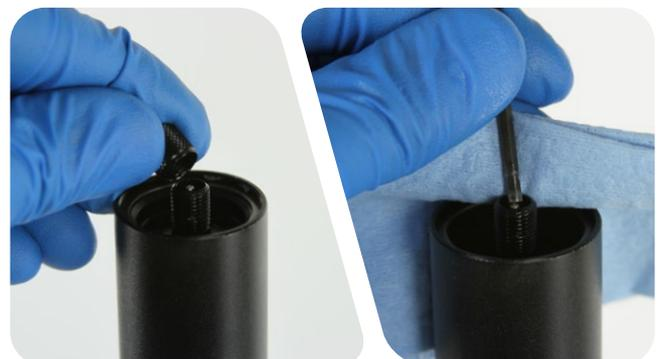
**5** **A2:** Entfernen Sie den Sicherungsring von der unteren Sattelstütze.
