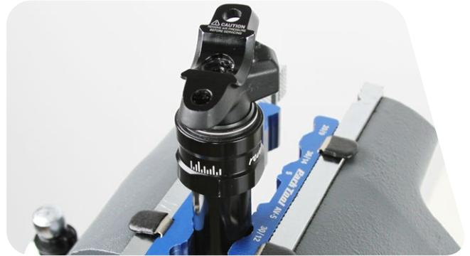
Entfernen Sie den Sicherungsring von der Tellerventil-Abdeckung.
