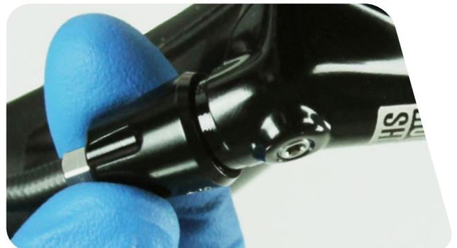
**5** Entfernen Sie die Fernbedienungshebel-Baugruppe vom Fahrradlenker.
