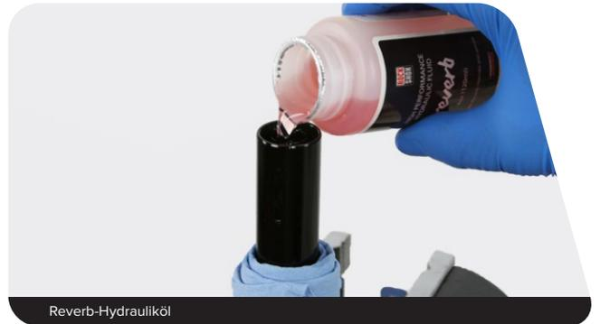
Entfernen Sie mit dem Finger etwaige Luftblasen von der Oberfläche des Öls.
