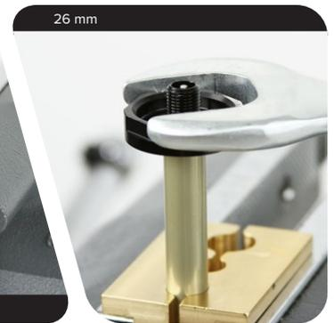
Lösen und entfernen Sie die Luftventil-Grundplatte von der inneren Führungsstange.
