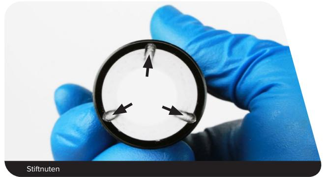
Halten Sie die Messingstifte in Position und schieben Sie die untere Sattelstütze nach unten, bis die Stifte darin fassen. Schieben Sie die untere Sattelstütze weiter nach unten über die Messingstifte.
