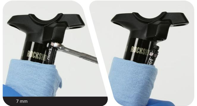
**7** Schieben Sie den Leitungsnippel und die Leitung durch die Reverb-Leitungsführung.
