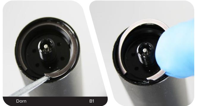
**6** Schieben Sie die untere Sattelstütze nach unten, um die Luftventil-Grundplatte freizulegen.
