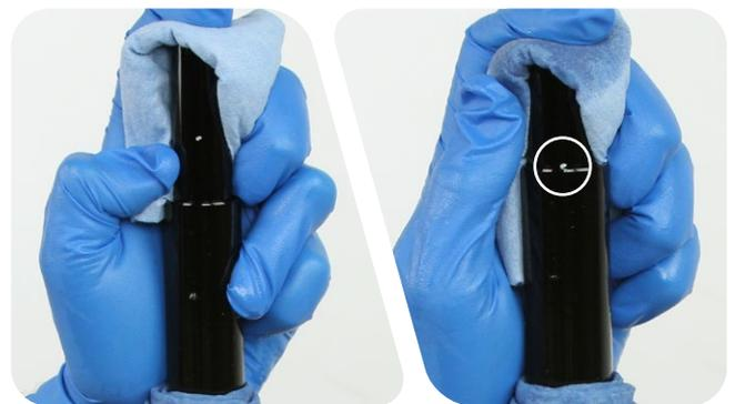
**10** Entfernen Sie das IFP Height Tool langsam von der oberen Sattelstütze.
