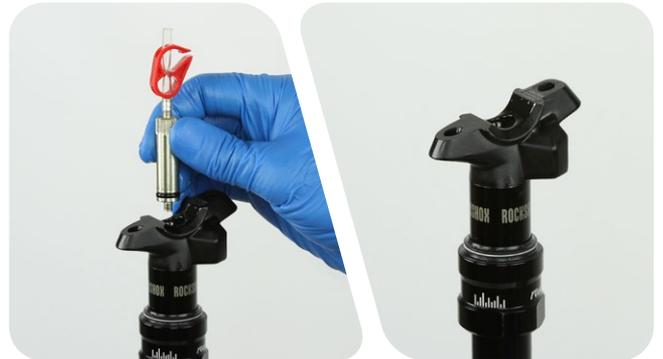
**10** Überschüssiges Öl muss aus der oberen Sattelstütze entfernt werden.
