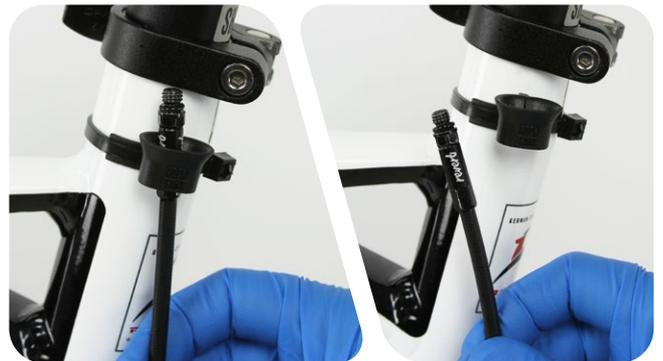
**8** Entfernen Sie die Sattelstütze aus dem Fahrradrahmen.
