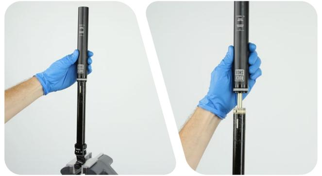
**11** Retire el anillo de gomaespuma y la junta tórica de tope. Limpie el interior y el exterior del tubo inferior con alcohol isopropílico y una toalla de taller, y déjelo a un lado.
