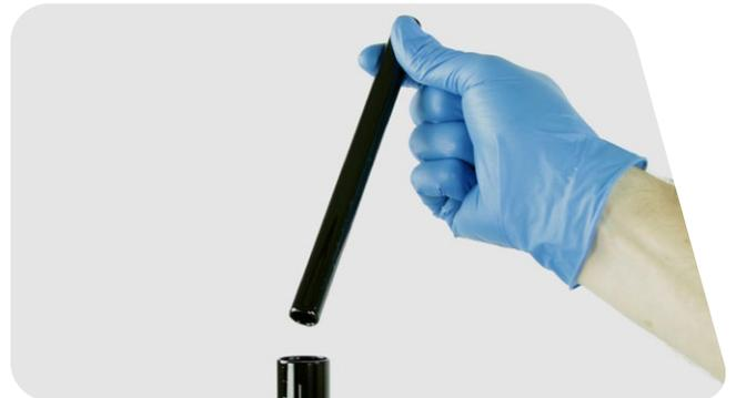
**3** Extraiga el pistón flotante interior (IFP) del tubo superior. Inserte de siete a nueve bridas de plástico para cables (el tamaño de la brida puede variar), de una en una, en el tubo superior y a través del centro del pistón IFP.
