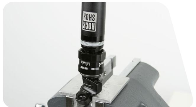
**10** Deslice hacia arriba el conjunto del tubo inferior y extráigalo del tubo superior.
