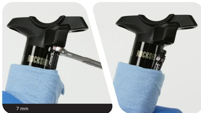
**7** Tire del conector del manguito y del propio manguito a través de la guía de manguito Reverb.
