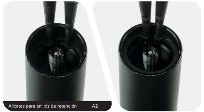
**B1:** Levante el extremo ondulado del anillo de retención y retire éste del tubo.
