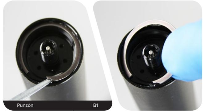
**6** Deslice hacia abajo el tubo inferior de la tija para dejar visible la placa base de la válvula de aire.
