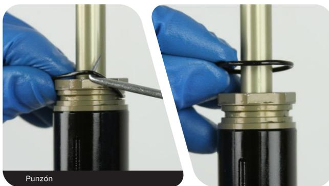
**3** Retire el conjunto de la tapa superior del tubo superior.
