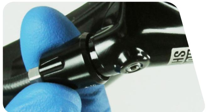
**5** Retire del manillar el conjunto de la palanca de control remoto.
