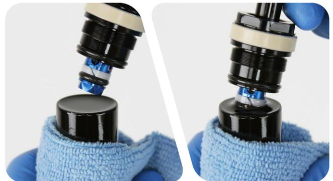
**B1** : enfoncez la tête d'étanchéité à l'intérieur de la tige supérieure et vissez-la à la main dans la tige supérieure.
