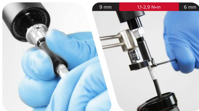
**Raccord cannelé avec écrou réducteur de tension** : positionnez l'extrémité plate du raccord cannelé dans la partie creuse du bouchon de la valve champignon. Vissez l'écrou réducteur de tension sur le bouchon de la valve champignon et serrez-le au couple recommandé. Retirez le serre-câble.
