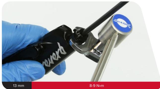
**∞** **Rappel à distance standard** : vissez le raccord cannelé du levier du rappel à distance sur la durite hydraulique. Maintenez l'extrémité de la durite en place et tournez le levier du rappel à distance dans le sens des aiguilles d'une montre tout en poussant le raccord cannelé du levier du rappel à distance dans la durite. Arrêtez lorsque la durite est bien serrée sur le raccord cannelé.
