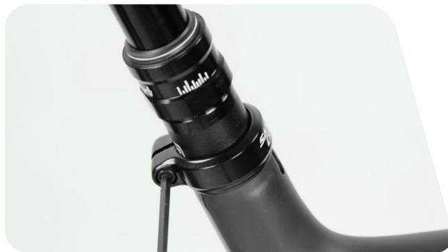
**11** Retirez la tige de selle fixée sur le tube de selle tout en repoussant la durite hydraulique dans son orifice à l'intérieur du cadre du vélo.
