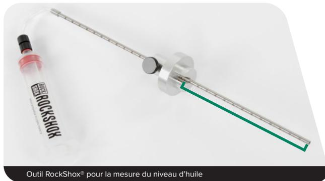
**2** Introduisez la jauge de niveau d'huile dans la came interne et évacuez le liquide en trop contenu dans la came interne en tirant sur le piston de la seringue. Lorsqu'il n'est plus nécessaire d'aspirer le liquide à l'intérieur de la came interne avec la seringue, retirez la jauge de la came interne.
