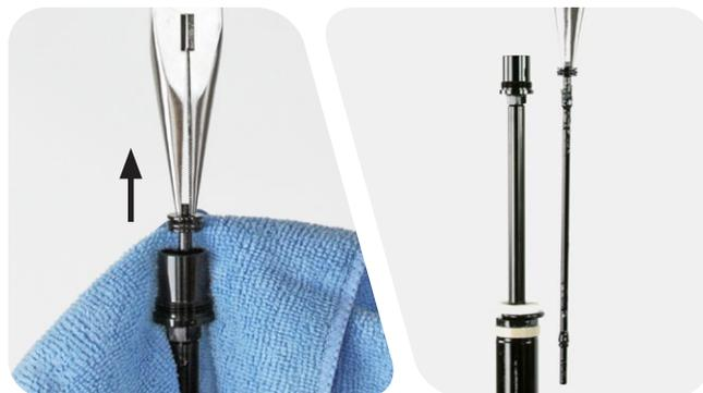
**4** Enroulez un chiffon autour de la tige supérieure sous la tête d'étanchéité.
