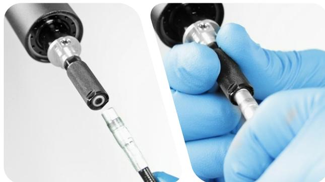
Vissez le coupleur de la durite dans le coupleur Connectamajig en tournant le collier du coupleur dans le sens des aiguilles d'une montre. Avec une clé plate de 6 mm, maintenez le raccord de la durite en place et serrez le collier du coupleur Connectamajig au couple recommandé.
