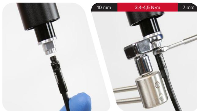
**Coupleur de durite Connectamajig™ (illustré à l'étape 2)** : connectez le coupleur de la durite au coupleur Connectamajig. Avec les doigts, poussez le raccord de durite Connectamajig dans le coupleur Connectamajig jusqu'à ce qu'il se bloque.
