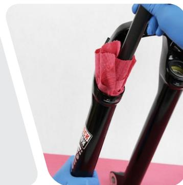
Remplacez le joint ou joint torique par un neuf fourni dans le kit d'entretien. Avec vos doigts ou une pointe, retirez le joint ou joint torique usagé.
