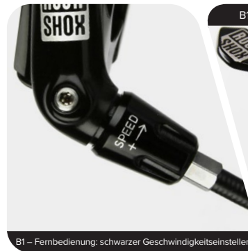
B1 – Fernbedienung: schwarzer Geschwindigkeitseinsteller
