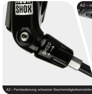
A2 – Fernbedienung: schwarzer Geschwindigkeitseinsteller
