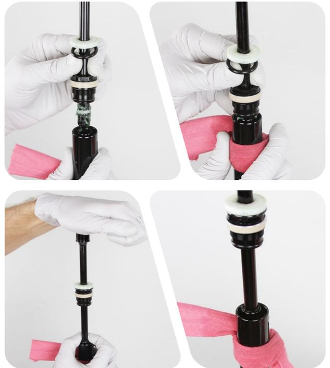
Le bord supérieur du piston principal (A) et le bord supérieur du tube du PFI (B) doivent être à la même hauteur.
