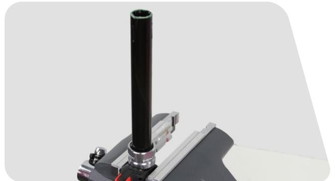
**1** Enduisez complètement les surfaces internes et externes du tube du PFI avec du liquide hydraulique pour tige de selle.
