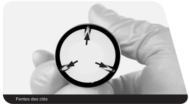
Maintenez bien en place toutes les clés et faites coulisser la tige inférieure vers le bas jusqu'à ce qu'elle s'engage dans les clés. Continuez à faire coulisser la tige inférieure vers le bas par-dessus les clés en laiton.
