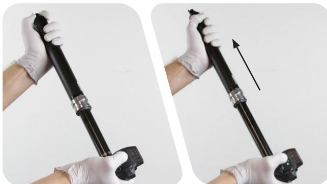
Lorsque la tige de selle est parfaitement déployée, appuyez **une fois de plus** sur le bouton AXS pour fermer la valve interne et verrouiller la tige de selle dans sa position d'extension complète.
