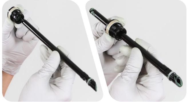
**4** Installez un joint torique de talonnage neuf et une bague en mousse neuve sur la came interne.
