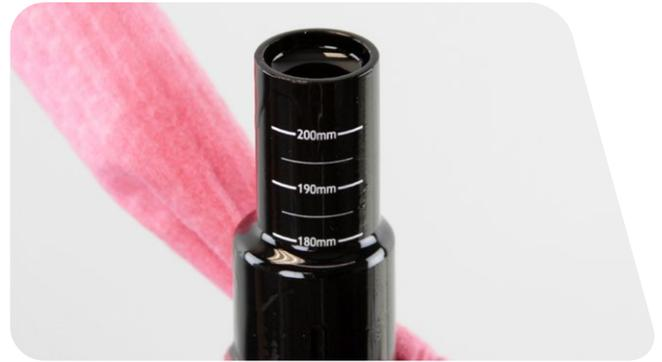
**9** Aspirez l'excédent de liquide restant au centre de l'outil du PFI avec une seringue de purge RockShox. Le reste du liquide doit affleurer avec le haut du tube du PFI.
