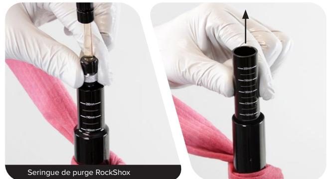
Retirez l'outil de réglage de la hauteur d'insertion du PFI hors de la tige supérieure.
