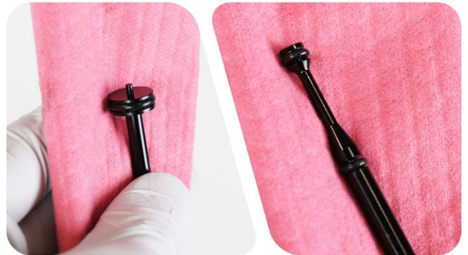
Retirez et jetez **uniquement** le joint torique situé sur l'extrémité fine (A) de la valve champignon. Nettoyez la cannelure du joint torique avec un chiffon propre non pelucheux. Mettez en place un joint torique neuf.
