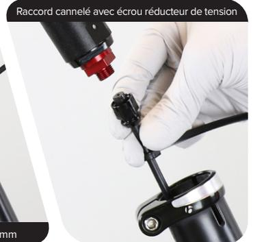
**Connectamajig** : dévissez et retirez le coupleur de la durite (A) hors du collier coupeur Connectamajig (B). L'entretien peut être réalisé avec l'unité du coupleur Connectamajig (C) toujours en place.
