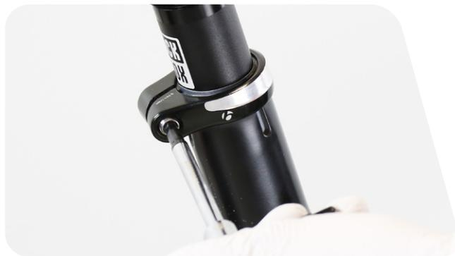
**8** Retirez la tige de selle fixée sur le tube de selle tout en repoussant la durite hydraulique dans son orifice à l'intérieur du cadre du vélo.
