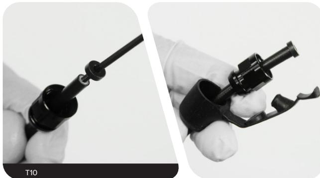
**4c** Rappel à distance Reverb 1x : insérez le raccord cannelé dans le rappel à distance et vissez l'écrou réducteur de tension sur le rappel à distance.
