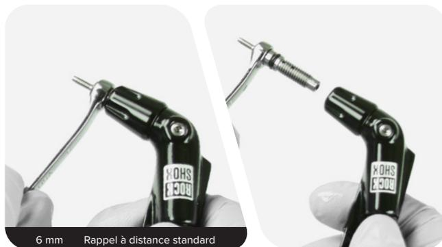
Mettez un raccord cannelé **neuf** en place et serrez-le.
