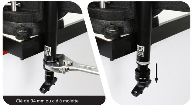
**6** Retirez l'unité de la tige supérieure puis déposez-la sur un chiffon propre.
