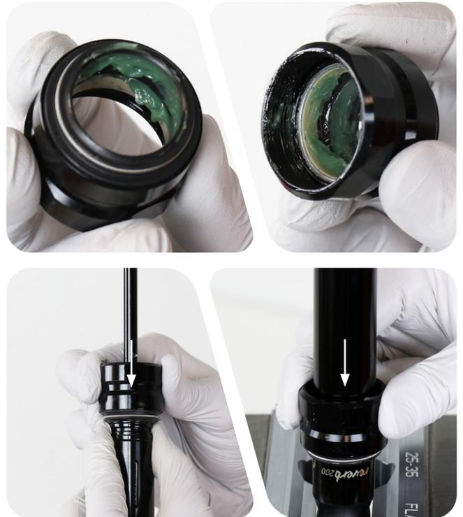
**6** Installez un joint torique neuf sur la tête d'étanchéité.
