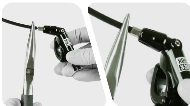
**4b** Rappel à distance Reverb 1x : insérez l'écrou réducteur de tension sur la durite.
