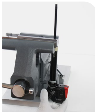
Piston à air dévissé de la tige à air
