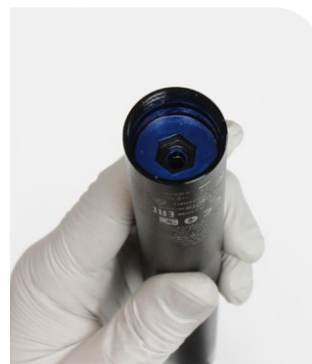
Tige à air dévissée de la tête de la tige de selle
