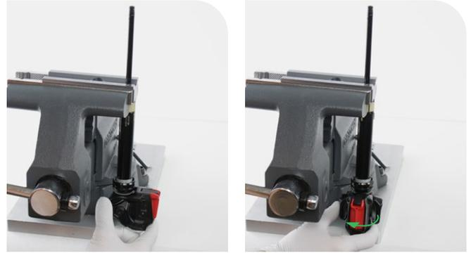
Saque el eje neumático de los bloques adaptadores de tornillo de banco.
