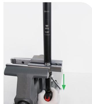
**9** Confirme que la válvula de asiento está instalada y que **NO** está completamente enganchada en el pistón neumático antes de instalar la junta tórica.
