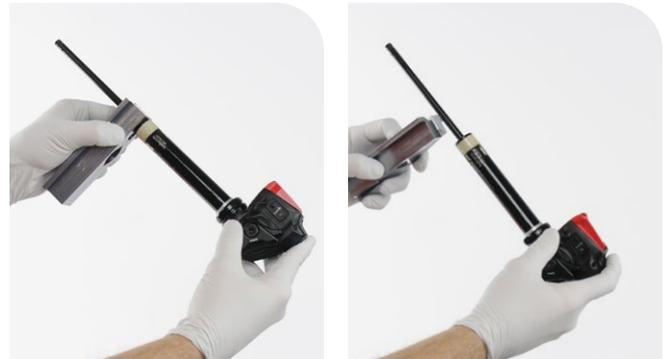
Desenrosque completamente el eje neumático y retírelo.
