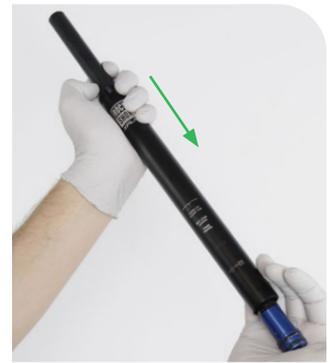
Retire el pistón neumático y la almohadilla superior del cabezal de sellado.
