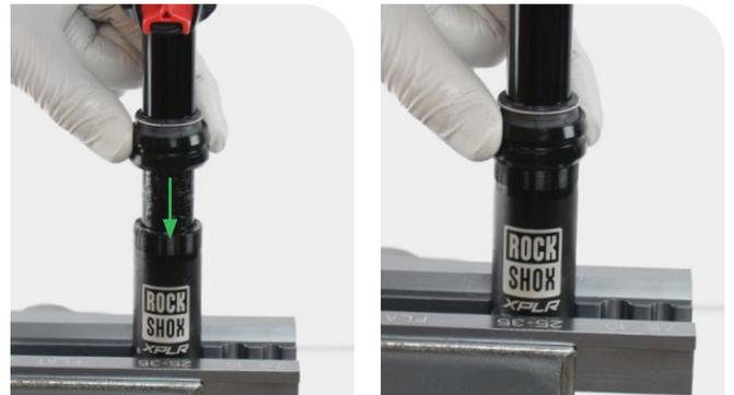
Envuelva una toalla de taller alrededor del conjunto del collarín/junta antipolvo para agarrarlo cuando empiece a enroscarse. Presione firmemente hacia abajo y enrosque con cuidado y a mano el collarín en el tubo inferior. Continúe hasta que el collarín quede apretado con la mano.
