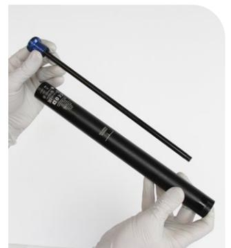
Empuje el cabezal de sellado y la almohadilla superior con una varilla para sacarlos del tubo inferior.
