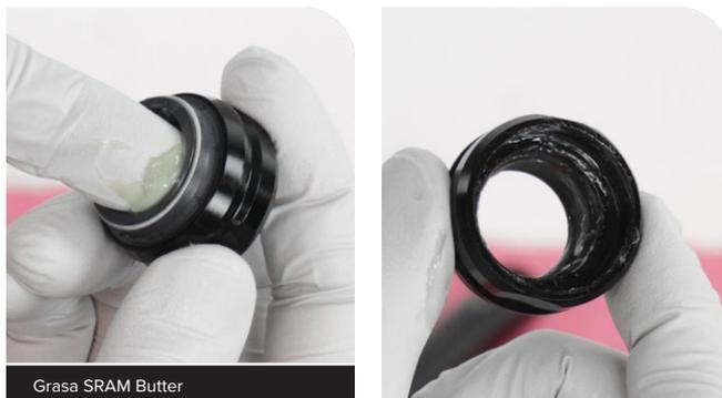
**8** Instale con cuidado el conjunto de collarín/junta antipolvo en el tubo superior. Empuje la junta antipolvo más allá del collarín del casquillo y dentro del tubo superior. Deslice el collarín hasta que se detenga contra el cabezal de la tija de sillín.
