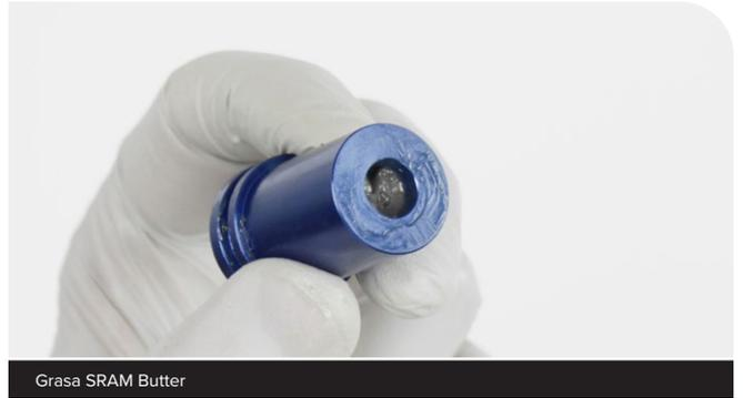
**5** Aplique grasa a la junta tórica exterior y vuelva a instalarla en el cabezal de sellado.
