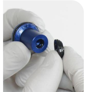
**9b** Si el eje neumático (A) se desenrosca del conjunto del tubo superior/cabezal de la tija de sillín (B), el eje neumático, el cabezal de sellado y el pistón neumático ensamblados se quedarán dentro del tubo inferior (C) al retirar el conjunto del tubo superior/cabezal de la tija de sillín del tubo inferior.
