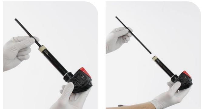
Empuje el cabezal de sellado, la almohadilla superior y el pistón neumático con una varilla para sacarlos del tubo inferior.
