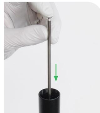
Presione la válvula de asiento en el eje neumático hasta que la parte superior de la válvula quede aproximadamente a 10 mm del pistón neumático. La parte superior de la válvula de asiento **no** debe hacer contacto con el pistón neumático.
