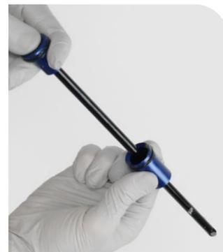
Deslice el cabezal de sellado hasta que se detenga contra el pistón neumático.
