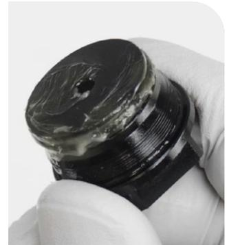
**11** Confirme que la válvula de asiento está instalada antes de colocar el tapón de aire.
