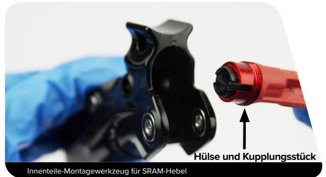
**6** Entfernen Sie die Hülse und das Kupplungsstück aus dem SRAM-Montagewerkzeug und trennen Sie dann von Hand die Hülse und das Kupplungsstück.
