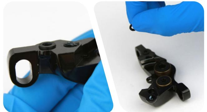
**8** Entfernen Sie die Kolben aus beiden Bremssattelgehäuse-Hälften.
