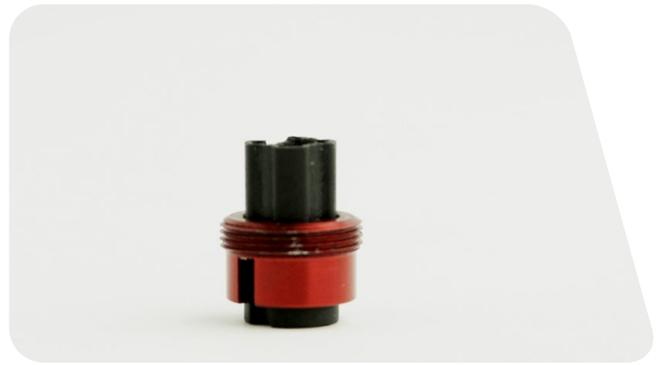
**5** Setzen Sie die Hülse und das Kupplungsstück in den Schlitz des Innenteile-Montagewerkzeugs für SRAM-Hebel ein.
