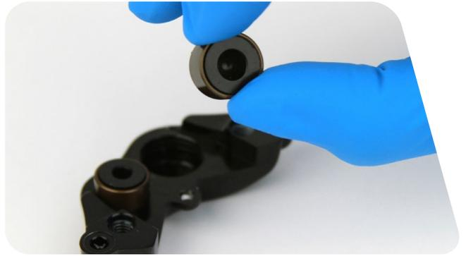
**9** Entfernen Sie mit einem Dorn die Dichtungen aus beiden Bremssattelgehäuse-Hälften. Setzen Sie in beide Bremssattelgehäuse-Hälften neue Dichtungen ein.
