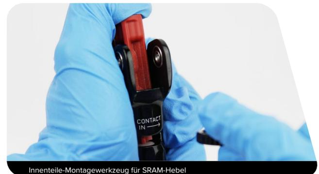
Innenteile-Montagewerkzeug für SRAM-Hebel
