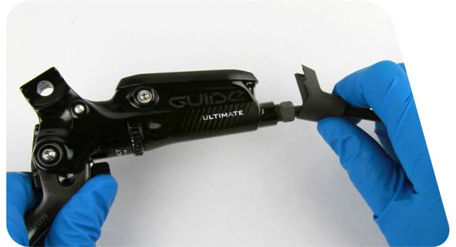
**3** Lösen Sie die Überwurfmutter mit einem offenen 8-mm-Ringschlüssel von der Leitung und ziehen Sie dann die Bremsleitung und den Klemmring vom Hebelkörper ab.
