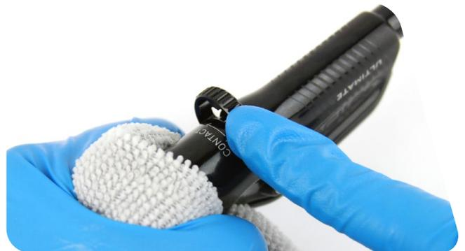
**8** Entfernen Sie die Kolben-Baugruppe vom Hebelkörper.
