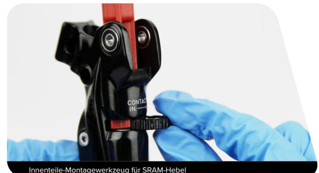
Innenteile-Montagewerkzeug für SRAM-Hebel
