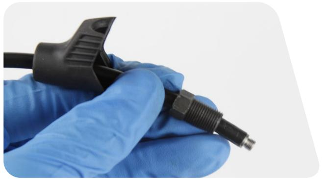
**13** Schrauben Sie den Klemmring gegen den Uhrzeigersinn auf den Leitungsnippel, bis er bündig mit dem Leitungsnippel abschließt oder etwas darunter sitzt.
