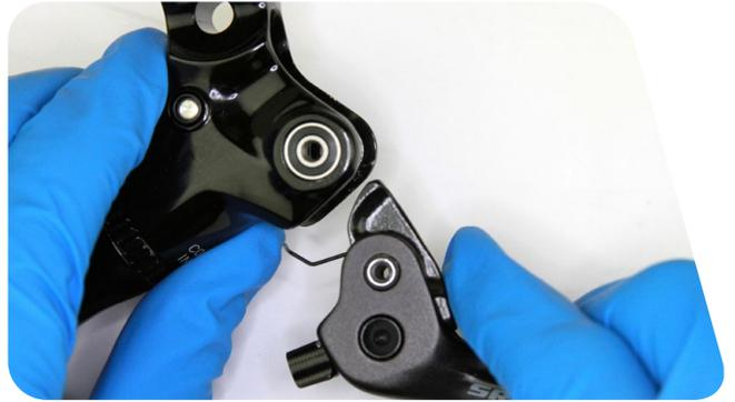
*Stellen Sie sicher, dass die Hebelrückstellfeder ordnungsgemäß im Hebel sitzt. Das nach außen weisende Ende der Feder muss gegen den Hebelgriff drücken, während das nach innen weisende Ende der Feder am Hebelkörper anliegen muss. Wenn die Rückstellfeder nicht ordnungsgemäß sitzt, funktioniert die Einstellvorrichtung für die Reichweite im Hebelgriff nicht.*
