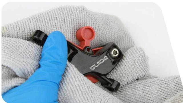
Nehmen Sie eine Sichtprüfung vor. Wenn O-Ringe über die Außenkanten der Bremsleitungsaufnahme und der Achsschraube hervorsteht, entfernen und erneuern Sie sie. Wiederholen Sie danach das Einbauverfahren.
