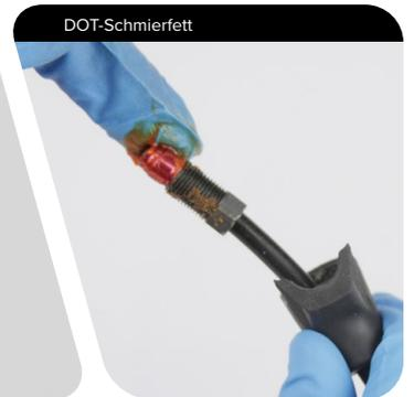
**14** Setzen Sie den Klemmring und die Mutter in den Hebel ein.
