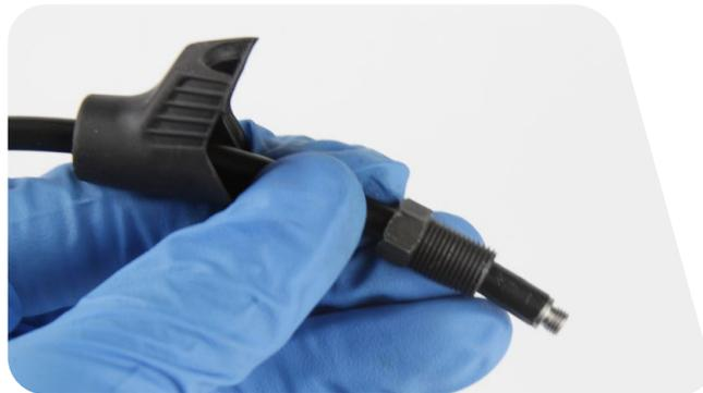
**13** Enrosque a tope en sentido antihorario el racor de compresión al conector del manguito, hasta dejarlo al ras o ligeramente por debajo del conector.
