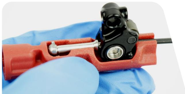
Herramienta de montaje de las piezas internas de la maneta SRAM Llave Allen de 2 mm
