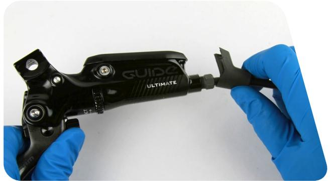
**3** Utilice una llave para tuercas abocinadas de 8 mm para desenroscar la tuerca de compresión del manguito y, a continuación, tire del manguito de freno y del adaptador de compresión desde el cuerpo de la maneta de freno.
