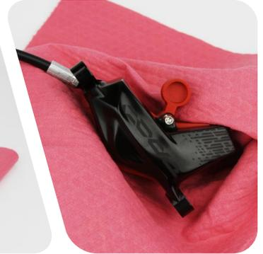
Sustituya la junta tórica o de estanqueidad por otras nuevas del kit de mantenimiento. Utilice los dedos, una brida o un punzón para perforar y retirar la junta tórica o de estanqueidad antiguas.
