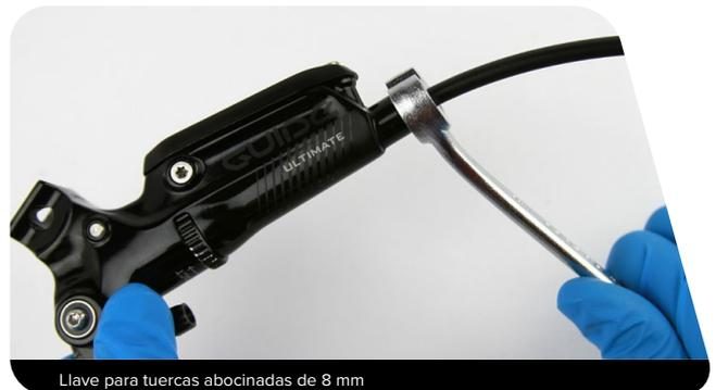
**4** Vierta el líquido de frenos en una bandeja para recoger el aceite. Oprima el brazo de la maneta para hacer salir del cuerpo de la maneta todo el líquido de frenos sobrante.
