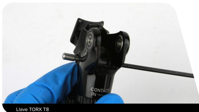
**3** Deslice el extremo de una llave TORX T8 a través del orificio del SwingLink y, a continuación, saque el SwingLink del cuerpo de la maneta.
