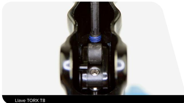
**2** Utilice el extremo de una llave TORX T8 para empujar el pasador de pivote del SwingLink y sacarlo del cuerpo de la maneta.
