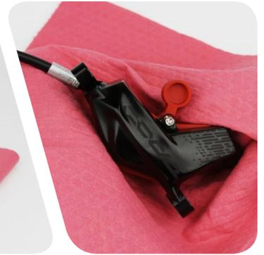
Ersetzen Sie den O-Ring oder die Dichtung durch ein neues Teil aus dem Wartungssatz. Entfernen Sie die alte Dichtung oder den O-Ring mit den Fingern, einem Kabelbinder oder einem Dorn.
