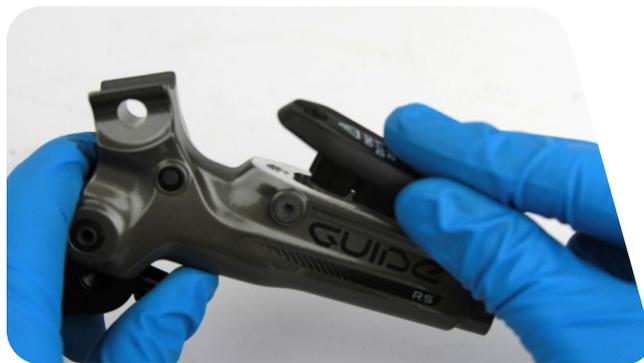
**13** À l'aide d'une clé dynamométrique équipée d'une douille TORX® T10, serrez tous les boulons du capuchon du réservoir à un couple compris entre 1,1 et 1,3 N·m.
