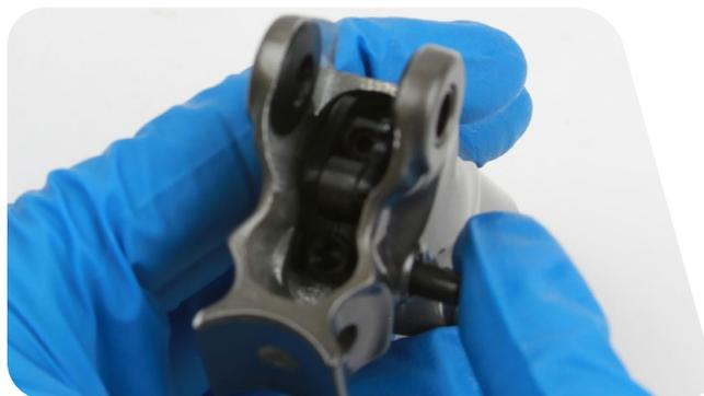
**5** Appliquez une petite quantité de Loctite® Threadlocker Blue 242® sur le filetage du boulon de maintien de la goupille du SwingLink™.
