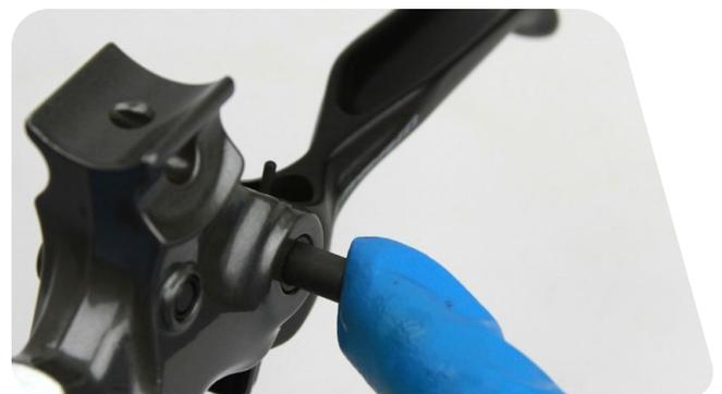
**8** Appliquez une petite quantité de Loctite® Threadlocker Blue 242® sur le boulon de maintien.
