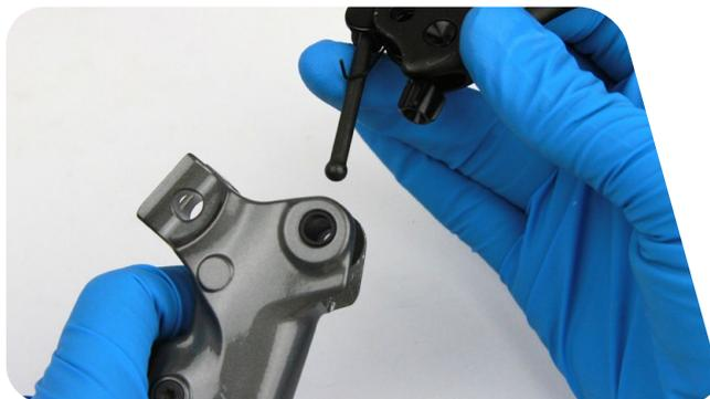
*Assurez-vous que le ressort de retour de la poignée est correctement mis en place dans le levier. L'extrémité externe du ressort doit venir en appui contre la poignée du levier alors que l'extrémité interne du ressort doit venir en appui contre le corps du levier. Si le ressort de retour n'est pas correctement installé, vous ne pourrez pas régler la course de la poignée du levier.*
