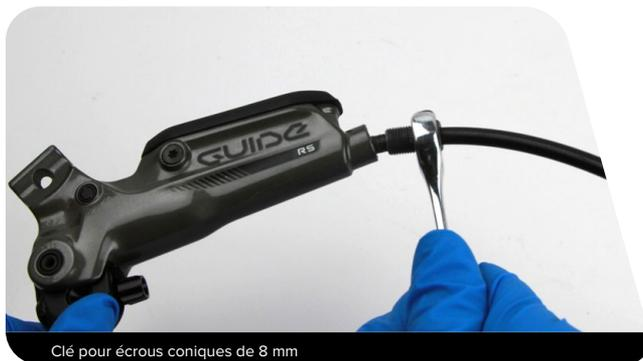
Clé pour écrous coniques de 8 mm
