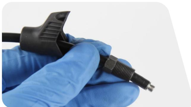
**13** Vissez l'olive de compression sur le raccord cannelé dans le sens inverse des aiguilles d'une montre jusqu'à ce qu'elle affleure avec le raccord cannelé ou qu'elle soit légèrement plus basse.
