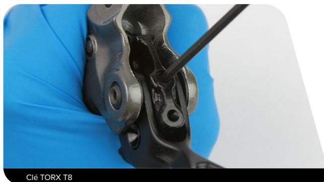
**11** À l'aide d'une clé TORX® T8, poussez la goupille pivot pour la retirer.
