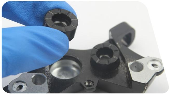
**9** Retirez les joints des pistons situés à l'intérieur de chaque moitié du corps de l'étrier. Mettez en place des joints neufs à l'intérieur de chaque moitié du corps de l'étrier.
