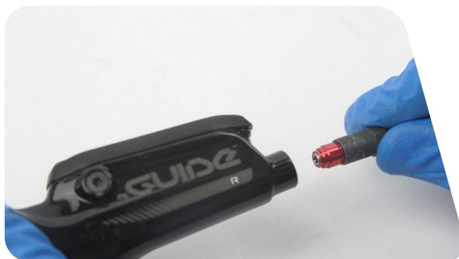
**15** A l'aide d'une clé dynamométrique équipée d'une douille articulée pour écrou conique, serrez l'écrou de compression à un couple de 8 N·m.
