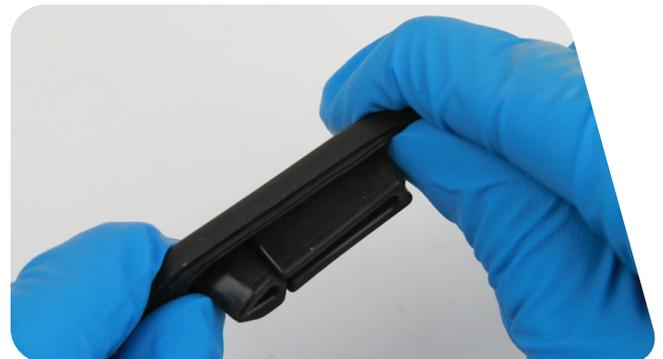
**12** Installez l'unité vessie/capuchon du réservoir sur le corps du levier.
