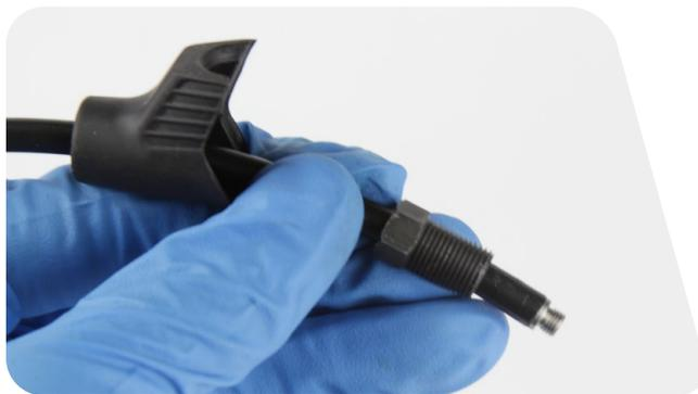
**17** Vissez l'olive de compression sur le raccord cannelé dans le sens inverse des aiguilles d'une montre jusqu'à ce qu'elle affleure avec le raccord cannelé ou qu'elle soit légèrement plus basse.
