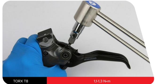
**10** À l'aide d'une clé TORX T8, installez une cheville de fixation du boulon neuve.
