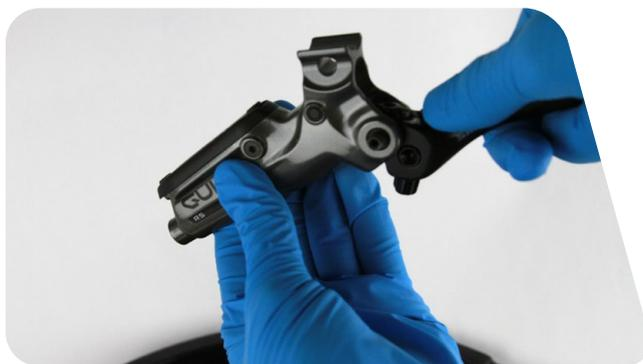
**5** Retirez les boulons du capuchon du réservoir.
