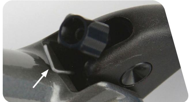
**7** Alignez la came et la poignée du levier avec les trous du corps du levier puis enfoncez la clavette du pivot à travers les trous.
