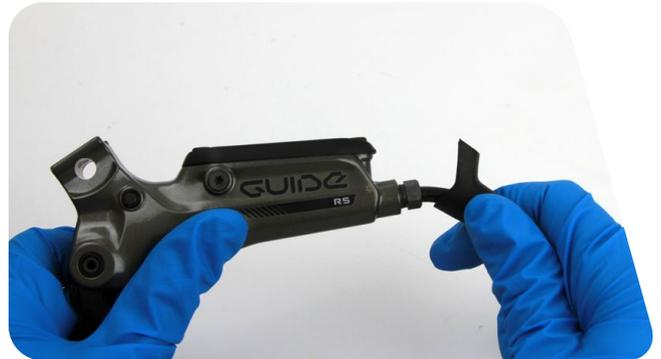
**3** Schrauben Sie die Überwurfmutter der Leitung lose und ziehen Sie dann die Bremsleitung und die Überwurfmutter vom Hebelkörper ab.
