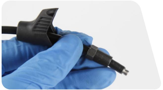
**17** Schrauben Sie den Klemmring gegen den Uhrzeigersinn auf den Leitungsnippel, bis er bündig mit dem Leitungsnippel abschließt oder etwas darunter sitzt.
