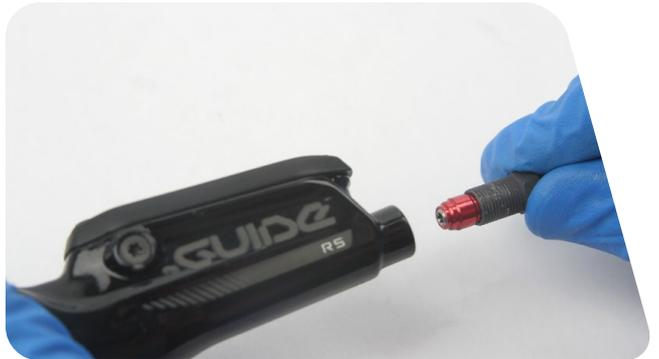
**19** Ziehen Sie die Überwurfmutter mit einem Drehmomentschlüssel und einem Hahnenfußaufsatz mit 8 N·m an.
