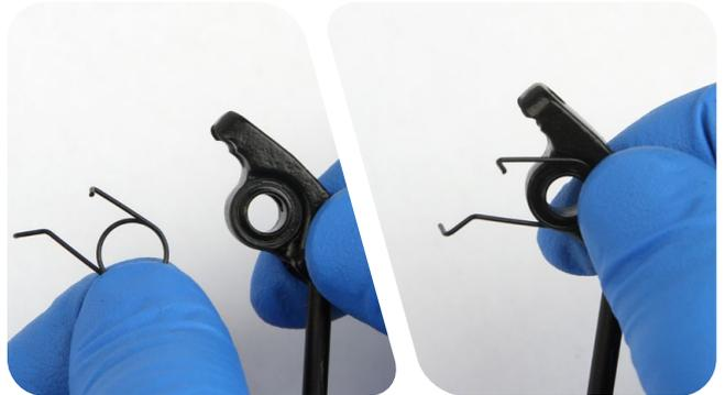
Halten Sie Nocke/Druckstange/Hebelrückstellfeder/Unterlegscheibe in Position, montieren Sie die Baugruppe auf dem Hebelgriff und fahren Sie mit Schritt 2 fort.
