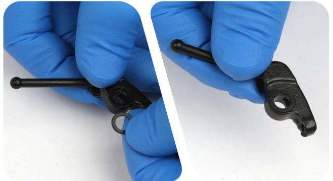
Montieren Sie die Hebelrückstellfeder auf der Nocken/Druckstangen-Baugruppe.
