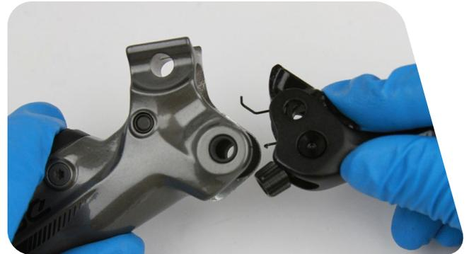
*Stellen Sie sicher, dass die Hebelrückstellfeder ordnungsgemäß im Hebel sitzt. Das nach außen weisende Ende der Feder muss gegen den Hebelgriff drücken, während das nach innen weisende Ende der Feder am Hebelkörper anliegen muss. Wenn die Rückstellfeder nicht ordnungsgemäß sitzt, können Sie die Reichweite des Hebelgriffs nicht einstellen. Der Reichweiten-Einsteller muss in der Mitnehmerbohrung sitzen. Ist dies nicht der Fall, können Sie die Reichweite nicht einstellen.*
