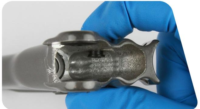
**5** Drücken Sie dann mit einer langen Innensprengzange den Hebelkörper nach unten und entfernen Sie den Sprengring.
