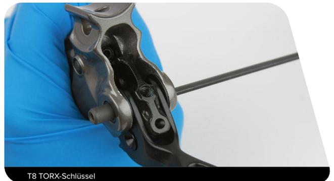
**12** Entfernen Sie den Hebelgriff vom Hebelkörper.
