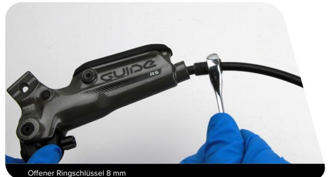
**4** Lassen Sie die Bremsflüssigkeit in eine Ölauffangwanne ab. Ziehen Sie den Hebelgriff, um die restliche Bremsflüssigkeit aus dem Hebelkörper herauszudrücken.
