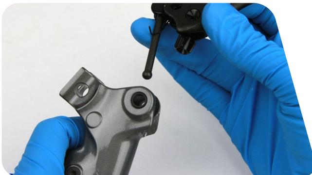
*Stellen Sie sicher, dass die Hebelrückstellfeder ordnungsgemäß im Hebel sitzt. Das nach außen weisende Ende der Feder muss gegen den Hebelgriff drücken, während das nach innen weisende Ende der Feder am Hebelkörper anliegen muss. Wenn die Rückstellfeder nicht ordnungsgemäß sitzt, können Sie die Reichweite des Hebelgriffs nicht einstellen.*
