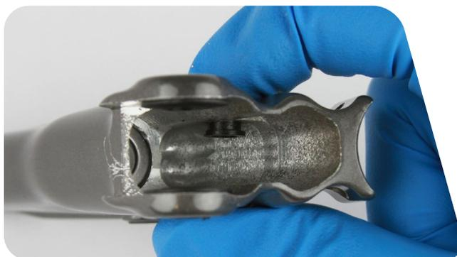
**5** Utilice unas tenazas de punta larga para aplicar presión hacia abajo al cuerpo de la maneta y extraer el aro de fijación.
