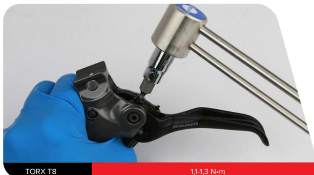
**10** Utilice una llave TORX T8 para instalar un nuevo tapón para el tornillo de sujeción.
