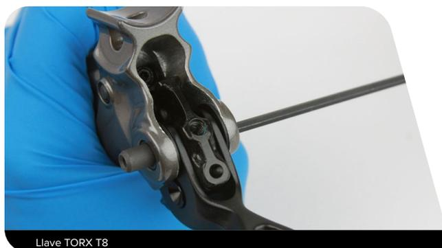
**12** Retire el brazo de la maneta para desprenderlo del cuerpo de la maneta.
