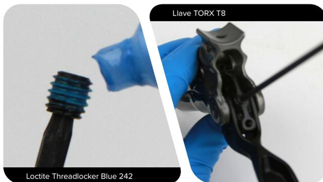
**9** Utilice una llave TORX® T8 para enroscar el perno de apriete al cuerpo de la maneta. Utilice una llave dinamométrica con cabezal TORX T8 para apretar el perno con un par de entre 1,1 y 1,3 N·m.
