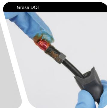
**18** Aplique grasa SRAM® DOT a la tuerca de compresión e instale el racor de compresión y la tuerca en la maneta.
