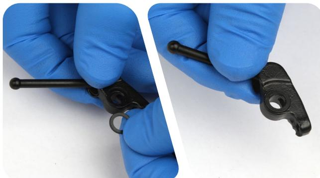
Instale el muelle recuperador de la maneta en el conjunto leva/biela de empuje.
