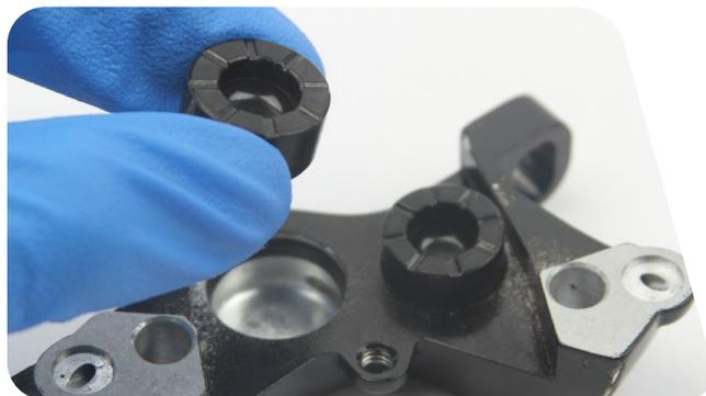
9 Extraiga las juntas de pistón de cada una de las mitades del cuerpo de la pinza de freno. Instale juntas nuevas dentro de cada mitad del cuerpo de la pinza de freno.
