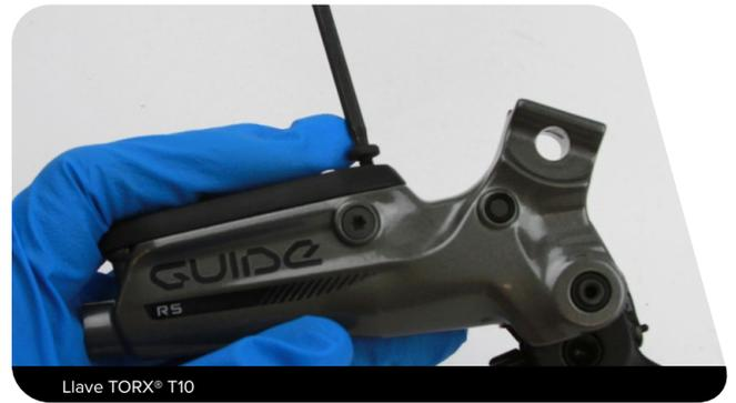
**6** Retire la tapa del depósito y la cámara flexible del cuerpo de la maneta.
