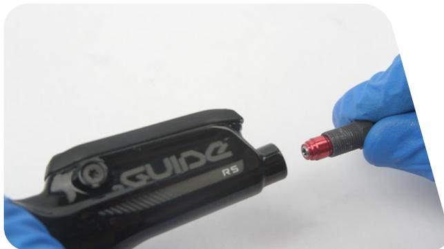
**19** Utilice una llave de pata de cuervo para tuercas abocinadas junto con una llave dinamométrica para apretar la tuerca de compresión a 8 N·m.
