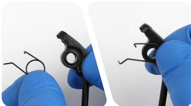
Manteniendo sujeto en su sitio el conjunto leva/biela de empuje/ muelle recuperador de la maneta/arandela, colóquelo sobre la hoja de la maneta y continúe con el paso 2.
