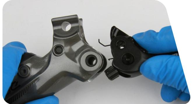
*Asegúrese de que el muelle recuperador de la maneta está correctamente asentado en la maneta. El extremo más exterior del muelle debe presionar contra el brazo de la maneta, mientras que el extremo más interior debe presionar contra el cuerpo de la maneta. Si el resorte de retorno no se coloca correctamente, no podrá ajustar el alcance del brazo de la maneta. El regulador de alcance debe quedar asentado en el orificio de la leva. Si no queda bien asentado, no podrá ajustar el alcance.*
