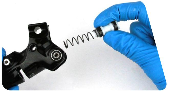
**9** Vaporisez de l'alcool isopropylique sur le corps du levier ainsi que sur la poignée du levier, puis nettoyez-les avec un chiffon.
