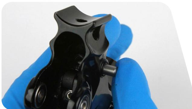
**11** Appliquez une petite quantité de Loctite Threadlocker Blue 242 sur le boulon de maintien.
