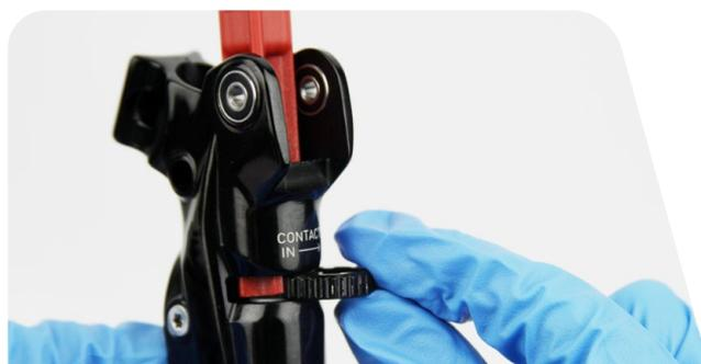
Outil SRAM pour l'assemblage des pièces internes du levier
