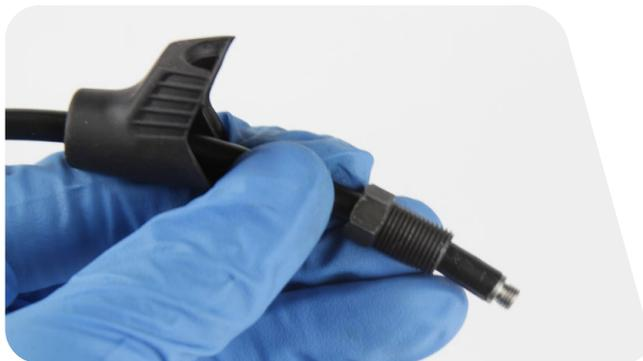
**12** Vissez l'olive de compression sur le raccord cannelé dans le sens inverse des aiguilles d'une montre jusqu'à ce qu'elle affleure avec le raccord cannelé ou qu'elle soit légèrement plus basse.
