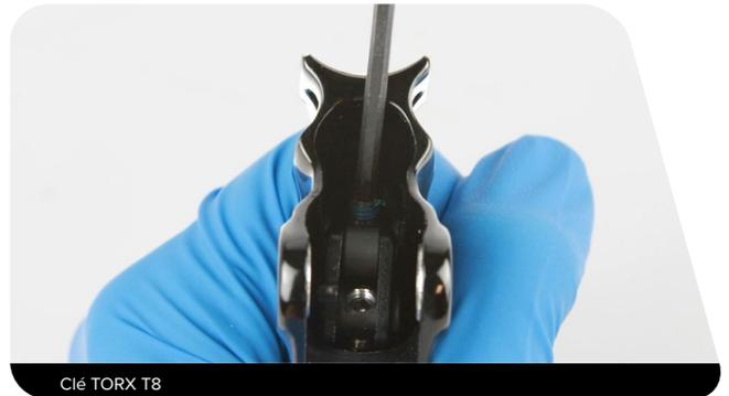
**2** À l'aide d'une clé TORX T8, poussez la clavette du pivot SwingLink hors du corps du levier.
