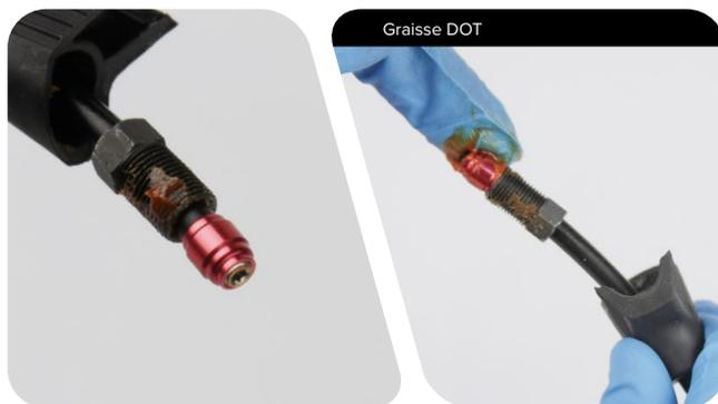
**13** Appliquez de la graisse SRAM DOT sur l'écrou de compression et installez le raccord de compression avec son écrou sur le levier.
