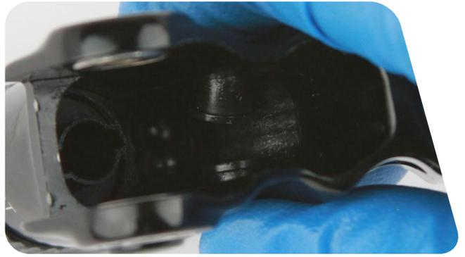
**5** À l'aide d'un outil d'assemblage pour pièces internes du levier SRAM, dévissez le manchon du piston ainsi que le coupleur. Insérez l'outil SRAM pour l'assemblage des pièces internes du levier Guide dans le corps du levier puis alignez la fente de l'outil avec le manchon du piston. Utilisez l'outil pour dévisser le manchon et retirer le manchon et le coupleur.
