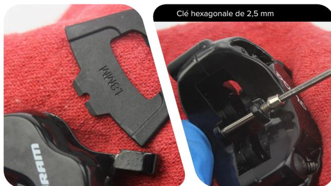
**5** À l'aide d'une clé TORX T25, retirez les deux boulons du corps de l'étrier.
