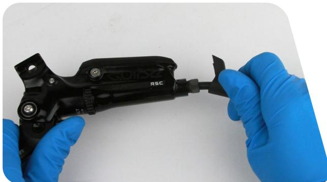
**3** À l'aide d'une clé pour écrous coniques de 8 mm, retirez l'écrou de compression de la durite.
