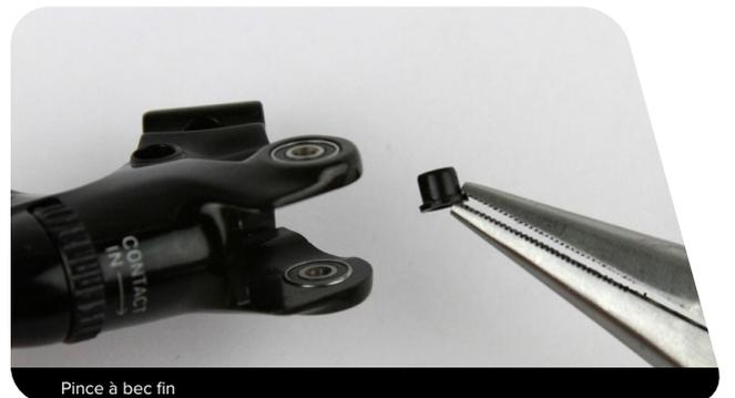
**7** Installez le SwingLink sur l'outil d'assemblage pour pièces internes du levier SRAM afin de régler la longueur de la tige poussoir sur le SwingLink.
