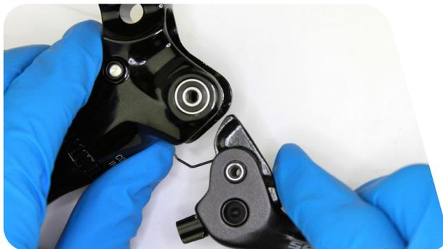
*Assurez-vous que le ressort de retour de la poignée est correctement mis en place dans le levier. L'extrémité externe du ressort doit toucher la poignée du levier alors que l'extrémité interne du ressort doit être en appui contre le corps du levier. Si le ressort de retour n'est pas correctement installé, vous ne pourrez pas régler la course de la poignée du levier.*
