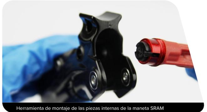
Herramienta de montaje de las piezas internas de la maneta SRAM
