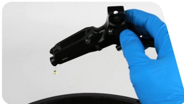
**10** Separe la cámara flexible de la tapa del depósito.
