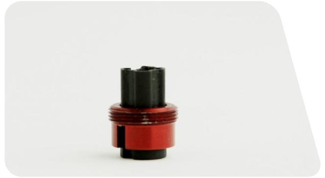
**5** Utilice la herramienta de montaje de las piezas internas de la maneta SRAM para acoplar y enroscar el manguito y el acoplador en el conjunto del pistón.
