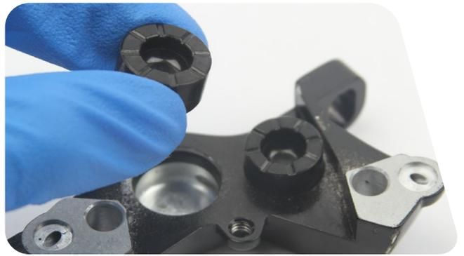
**9** Utilice un punzón para extraer las juntas de pistón de cada mitad del cuerpo de la pinza de freno. Instale juntas nuevas dentro de cada mitad del cuerpo de la pinza de freno.
