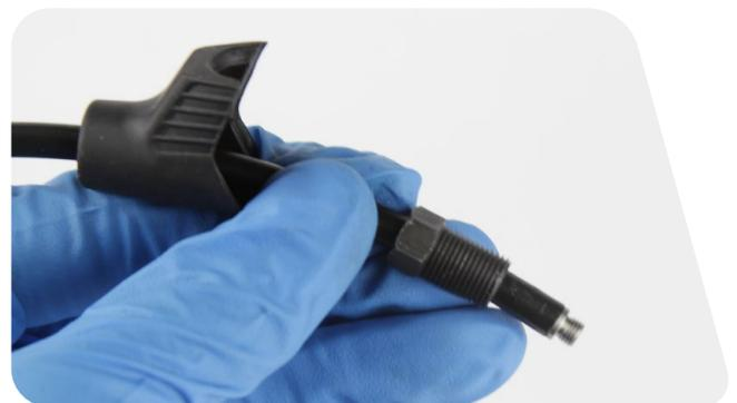
**12** Enrosque a tope en sentido antihorario el racor de compresión al conector del manguito, hasta dejarlo al ras o ligeramente por debajo del conector.
