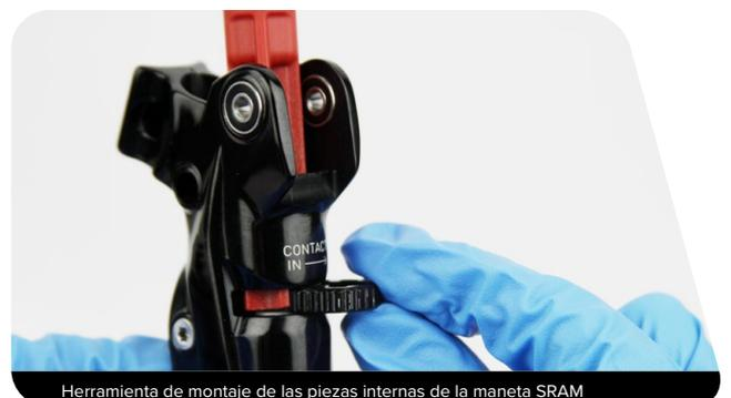
**4** Coloque el manguito en el acoplador.
