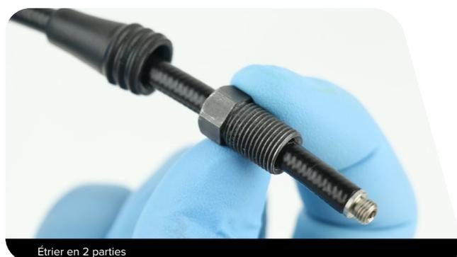
**Étrier en 2 parties :** Vissez l'olive de compression sur le raccord cannelé dans le sens inverse des aiguilles d'une montre jusqu'à ce qu'elle affleure avec le raccord cannelé ou qu'elle soit légèrement plus basse.
