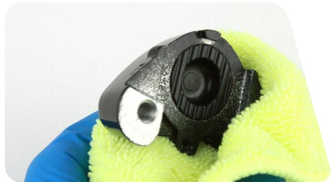
**3** À l'aide d'une pointe, retirez le joint torique situé dans la moitié interne de l'étrier puis installez un joint torique neuf.
