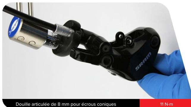
Douille articulée de 8 mm pour écrous coniques
