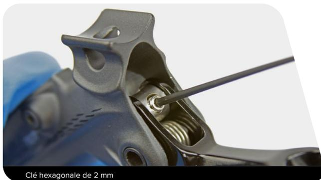
**TLM/TL** : posez le corps du levier sur le rebord d'une table de manière à ce que la clavette du pivot soit dans le vide, tournée vers le bas, puis insérez l'outil de maintenance SRAM pour pivot du levier dans la fente de la clavette du pivot.
