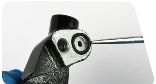
**4** À l'aide d'une pointe, retirez le joint torique situé sur l'olive de la durite pincée.
