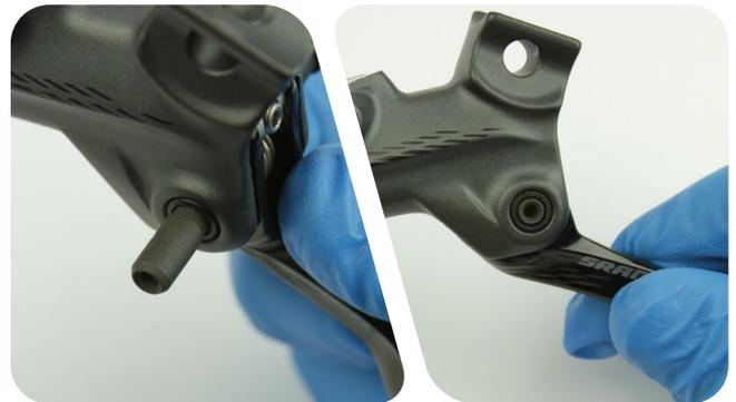
**5** **Ultimate** : à l'aide d'une clé dynamométrique équipée d'une douille TORX T10, serrez les deux boulons du pivot à un couple compris entre 1,2 N·m.
