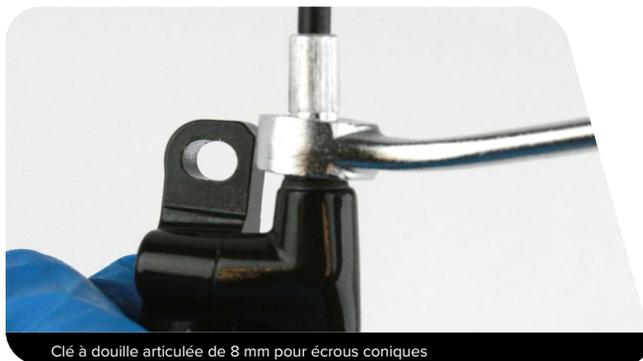
Clé à douille articulée de 8 mm pour écrous coniques
