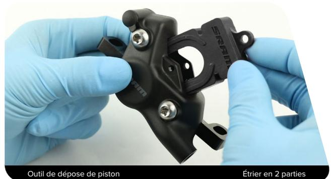
**Étrier monobloc :** Insérez l'outil de désinstallation des pistons de 21 mm pour étrier monobloc SRAM puis, à l'aide d'une clé hexagonale de 2,5 mm, mettez en place le boulon de maintien des plaquettes dans l'étrier.
