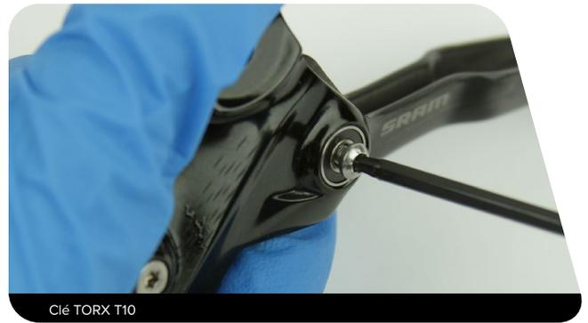
**TLM/TL** : insérez la clavette sur l'outil de maintenance SRAM pour pivot du levier à travers les douilles du corps du levier, du ressort du levier et de la bague du ressort.
