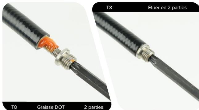
**Étrier en 2 parties :** mettez l'écrou de compression en place sur la durite.
