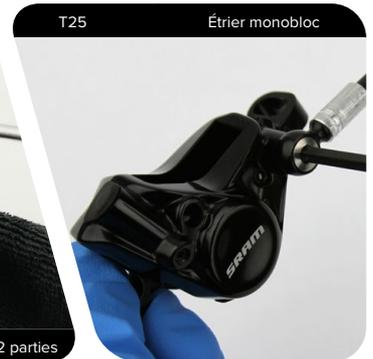
**2 Étrier en 2 parties :** insérez l'outil de démontage des pistons de l'étrier Level/AXS.
