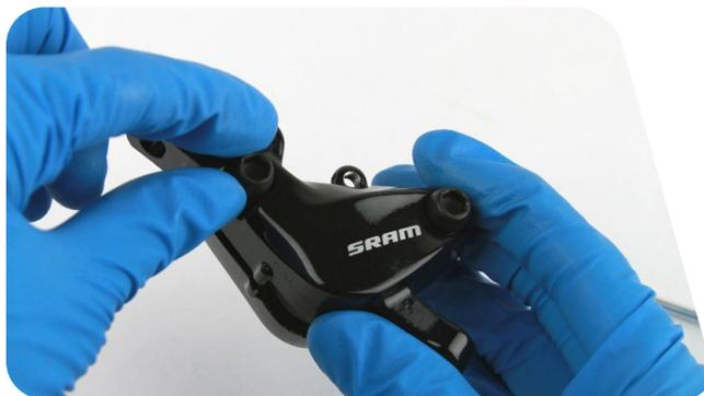
**6** À l'aide d'une clé dynamométrique équipée d'une douille hexagonale de 5 mm, serrez chaque boulon à un couple compris entre 11 N·m.
