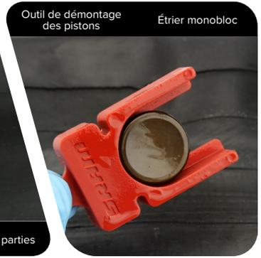
**6** Insérez la cale pour piston Level de manière à ce qu'elle rentre parfaitement dans l'emplacement du piston retiré et qu'elle affleure avec l'intérieur de l'étrier.
