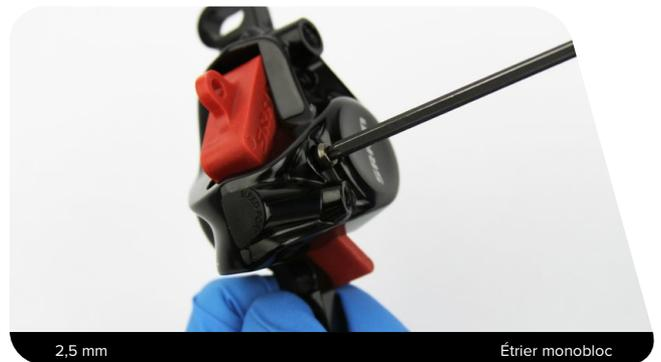
**5** Retirez le piston ainsi que l'outil de démontage des pistons hors de l'étrier.
