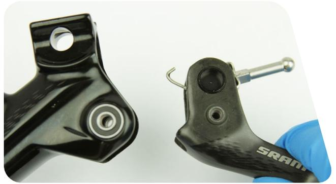
**TLM/TL** : le ressort et la bague du ressort vont se déloger de la poignée du levier. Insérez une bague de ressort neuve dans le ressort.
