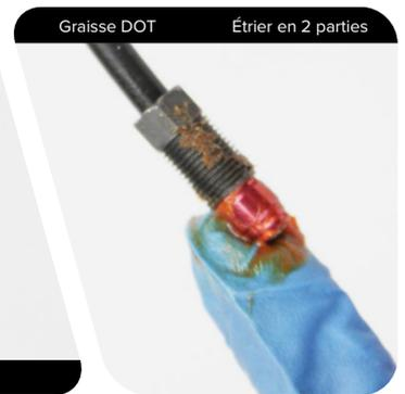
**Étrier en 2 parties :** installez la durite dans l'étrier tout en vissant à la main l'écrou de compression dans l'étrier. Serrez l'écrou de compression.
