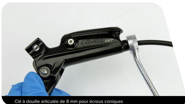
Clé à douille articulée de 8 mm pour écrous coniques
