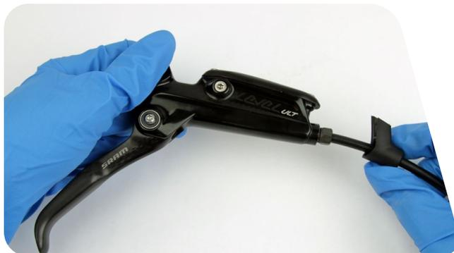
**3** À l'aide d'une clé à douille articulée de 8 mm pour écrous coniques, dévissez l'écrou de compression de la durite, puis retirez la durite de frein ainsi que l'olive de compression hors du corps du levier de frein.
