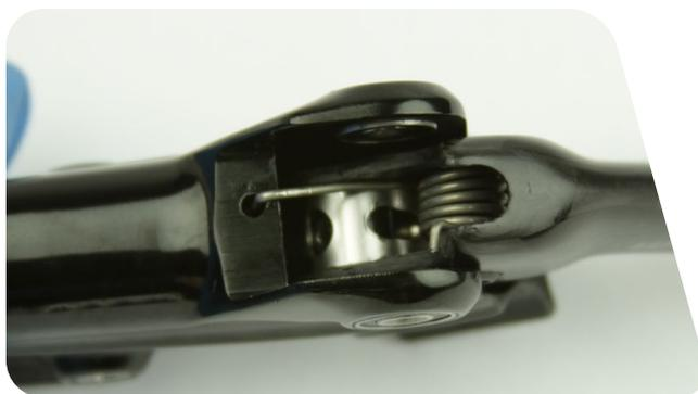
**4** **Ultimate** : veillez à ce que les trous du ressort, de la bague du ressort et de la poignée du levier soit bien alignés avec les trous des boulons du pivot à l'intérieur du corps du levier.
