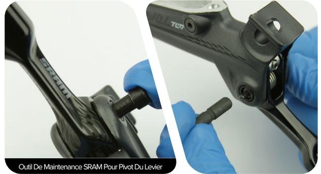
Poussez la clavette du pivot à travers le corps du levier de manière à ce qu'elle affleure avec chaque côté du corps du levier.
