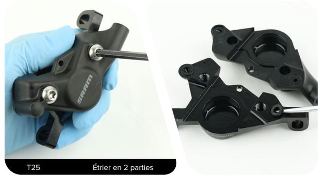
**13** Retirez les joints des pistons de chaque alésage de piston.
