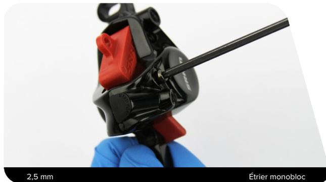
**10** Retirez l'outil de démontage des pistons, le piston ainsi que la cale pour piston hors de l'étrier.
