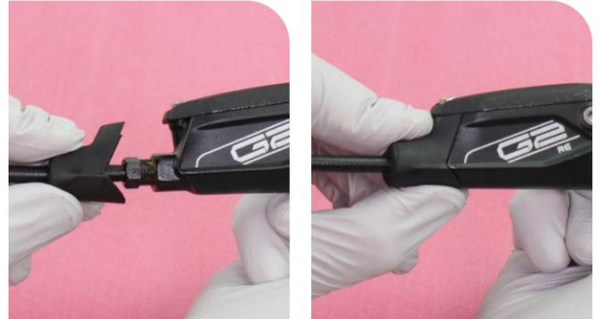
Pulverice alcohol isopropílico sobre el cuerpo de la maneta y límpiela con una toalla de taller.
