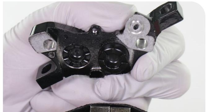
**6** Coloque plana de nuevo la mitad de la pinza de freno sobre el tornillo de banco y la alfombrilla, con el orificio de líquidos del cuerpo de la pinza sobresaliendo del borde del tornillo de banco.
