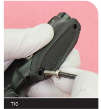
**6** Saque la tapa del depósito y la cámara flexible del cuerpo de la maneta.
