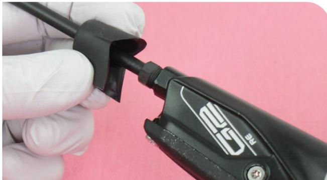
**3** Extraiga la tuerca de compresión del manguito. Saque el manguito de freno y el racor de compresión del cuerpo de la maneta de freno.
