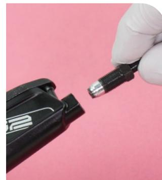
**4** Vierta el líquido de frenos en un recipiente para recoger el aceite. Apriete el brazo de la maneta para bombear el líquido de frenos fuera del cuerpo de la maneta.
