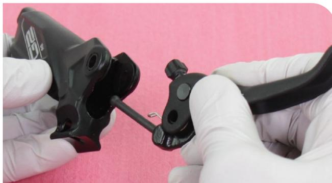
**3** Alinee la leva de la varilla empujadora y el brazo de la maneta con los orificios de pivote del cuerpo de la maneta; a continuación, introduzca el pasador de pivote en el orificio de pivote y utilícelo para alinear el conjunto de la leva de la varilla empujadora con el orificio de pivote de la maneta.
