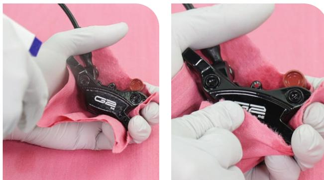
Compruebe visualmente el trabajo. Si alguna de las juntas tóricas sobresale del adaptador de banjo o del perno de banjo, retire y sustituya las juntas tóricas y repita el proceso de instalación.
