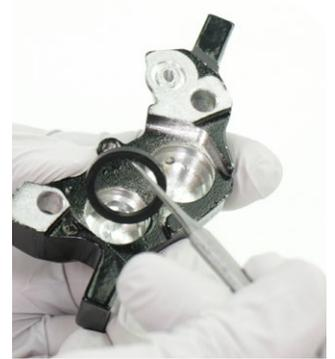
9 Pulverice alcohol isopropílico en cada mitad del cuerpo de la pinza de freno y limpie los orificios del pistón.
