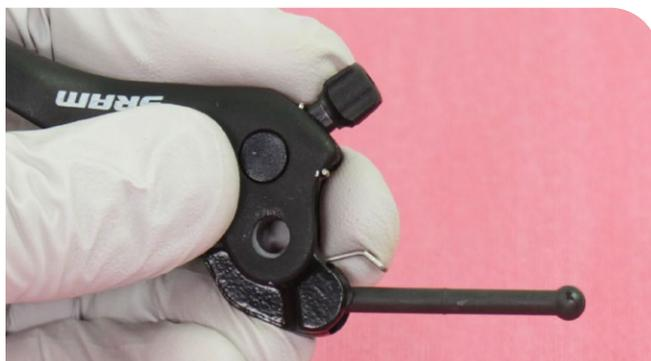
Introduzca el pasador del tornillo de ajuste de alcance en el orificio de la leva.
