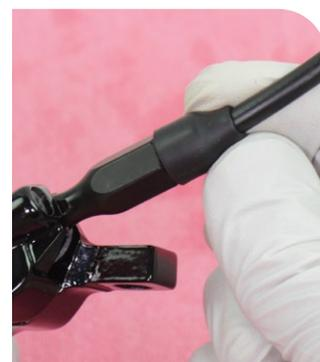
**15** Inserte el bloque de purgado en la pinza de freno.
