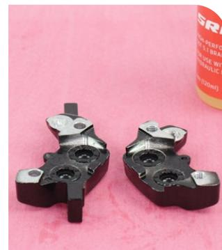
**2** Aplique líquido de frenos DOT 5.1 a cada junta tórica nueva de la pinza de freno e instale las juntas tóricas en cada mitad del cuerpo de la pinza.
