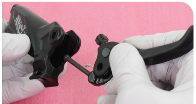
**3** Richten Sie den Druckstangen-Mitnehmer und den Hebelgriff auf die Hebelgelenkbohrungen im Hebelkörper aus und schieben Sie dann den Gelenkstift durch eine der Gelenkbohrungen. Verwenden Sie ihn, um die Druckstangen-Mitnehmer-Baugruppe auf die Hebelgelenkbohrung auszurichten.
