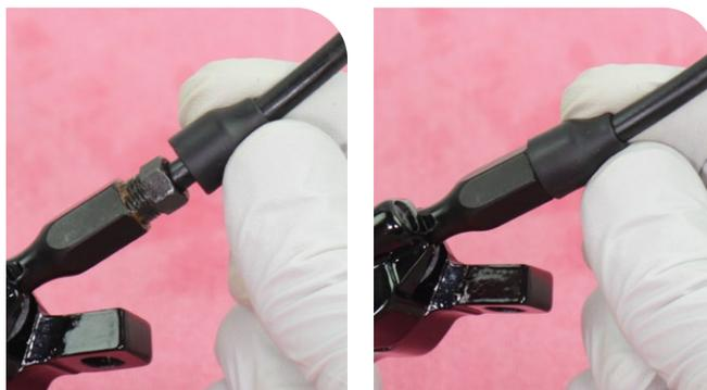
**15** Setzen Sie den Entlüftungsblock in den Bremssattel ein.
