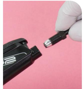
**4** Lassen Sie die Bremsflüssigkeit in eine Ölauffangwanne ab. Ziehen Sie den Hebelgriff, um die Bremsflüssigkeit aus dem Hebelkörper zu pumpen.
