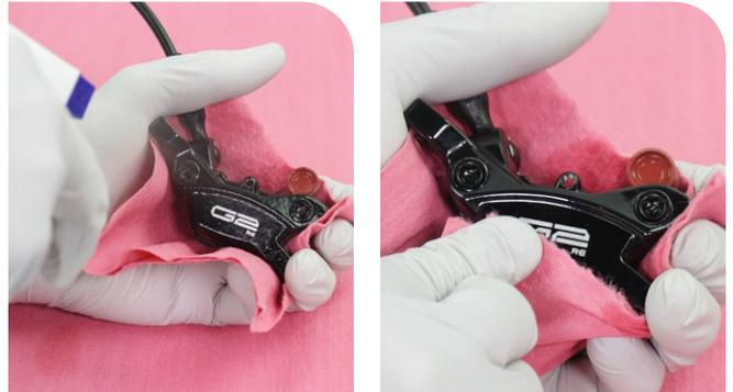
Führen Sie eine Sichtprüfung durch. Wenn O-Ringe über die Außenkanten der Leitungsaufnahme und der Achsschraube hervorstehen, entfernen und erneuern Sie sie. Wiederholen Sie danach das Einbauverfahren.
