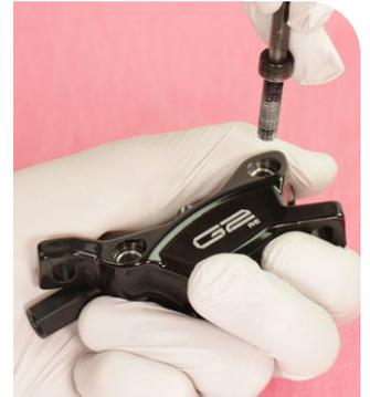
Trennen Sie die Bremssattelhälften und entfernen Sie die Leitungsaufnahme.
