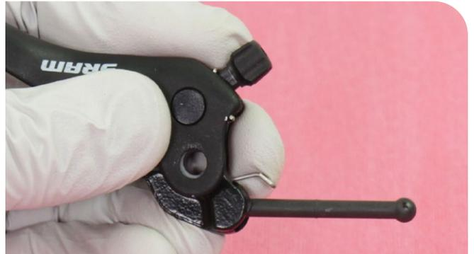
Setzen Sie den Schraubstift für die Griffweiteneinstellung in die Bohrung in der SwingLink-Nocke ein.
