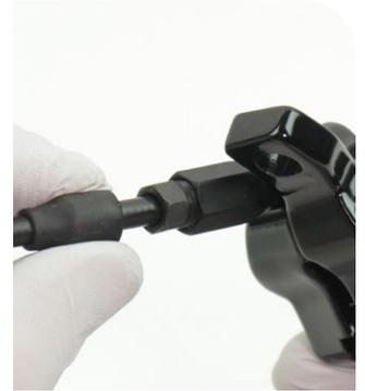
Entfernen Sie die Überwurfmutter und die Leitung.
