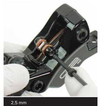
**3** Entfernen Sie die Bremsbeläge vom Bremssattel.
