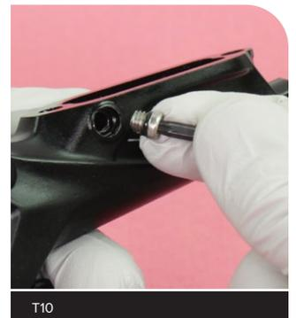
**9** Entfernen Sie die O-Ringe von den Entlüftungsschrauben und entsorgen Sie die O-Ringe.
