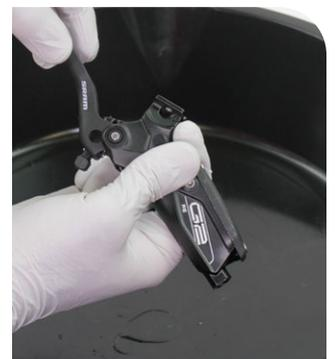
**5** Entfernen Sie die Schrauben des Ausgleichsbehälterdeckels.
