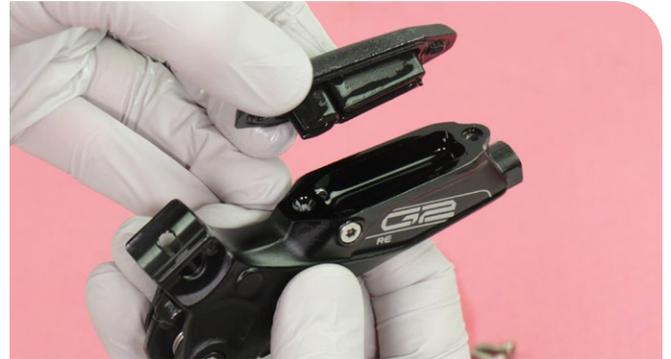
**7** Lassen Sie die verbleibende Bremsflüssigkeit aus dem Bremshebelkörper in eine Ölauffangwanne ablaufen.
