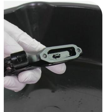
**8** Entfernen Sie die beiden Hebel-Entlüftungsschrauben.
