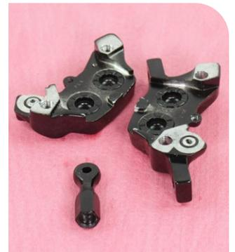
**3** Entfernen und entsorgen Sie die O-Ringe der Leitungsaufnahme.
