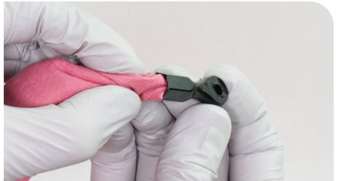
Säubern Sie jede Bremsattelschraube.
