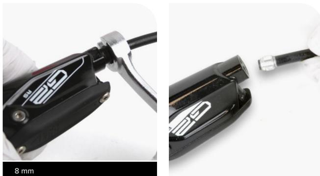
**4** Déversez le liquide de frein dans un récipient prévu à cet effet. Actionnez la poignée du levier de frein pour vider le liquide de frein restant à l'intérieur du corps du levier.
