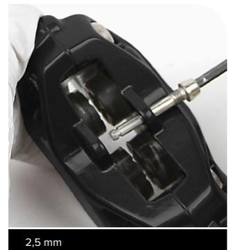
**6** Retirez le soufflet en caoutchouc situé sur l'écrou de compression.
