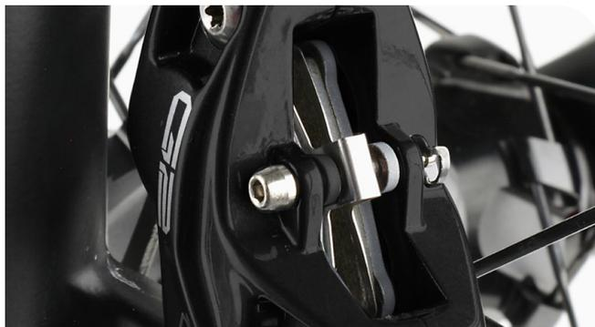
**9** Actionnez le levier de frein jusqu'à ce que le point de contact soit stable et que la course du levier soit acceptable.
