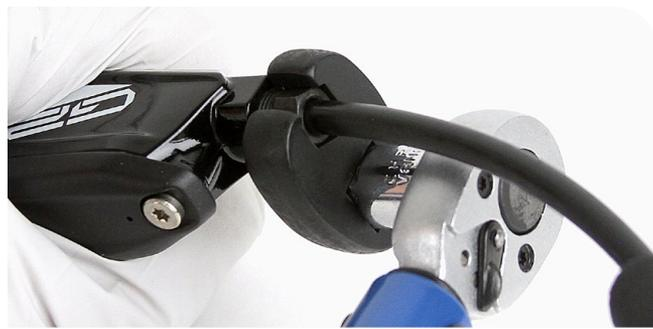
Clé pour écrous coniques de 8 mm
