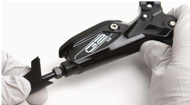
**3** Retirez l'écrou de compression de la durite. Tirez sur la durite de frein et sur l'olive de compression pour les retirer du corps du levier de frein.
