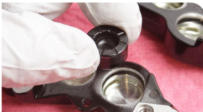
**12** Retirez les joints des pistons situés à l'intérieur de chaque moitié du corps de l'étrier. Mettez en place des joints neufs à l'intérieur de chaque moitié du corps de l'étrier.
