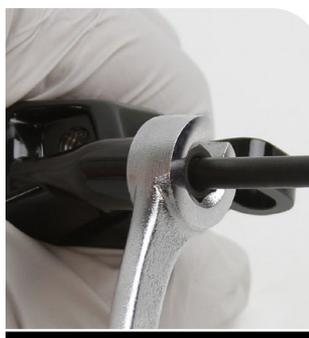
Clé pour écrous coniques de 8 mm
