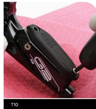
**6** Retire la tapa del depósito y la cámara flexible del cuerpo de la maneta.
