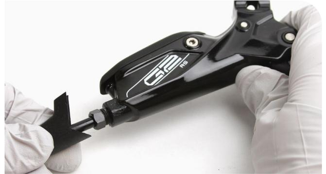
**3** Quite la tuerca de compresión del manguito. Tire del manguito de freno y el adaptador de compresión para sacarlos del cuerpo de la maneta de freno.
