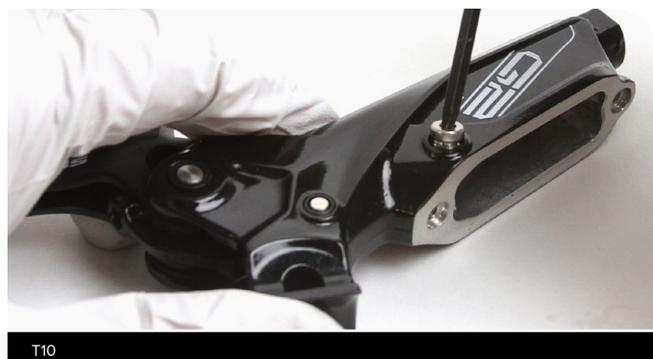
**9** Separe la cámara flexible de la tapa del depósito.
