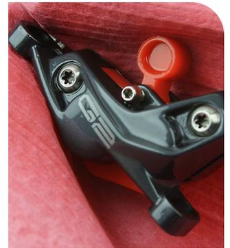
Sustituya la junta tórica o de estanqueidad por otra nueva del kit de mantenimiento. Utilice los dedos, una brida o un punzón para perforar y retirar la junta tórica o de estanqueidad antigua.
