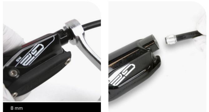
**4** Vierta el líquido de frenos en una bandeja para aceite. Apriete el brazo de la maneta para bombear el exceso de líquido de frenos del interior del cuerpo de la maneta.
