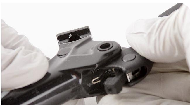
**3** Alinee la leva y el brazo de la maneta con los orificios del cuerpo de la maneta y, a continuación, inserte el pasador de pivote por los orificios empujándolo hacia dentro.
