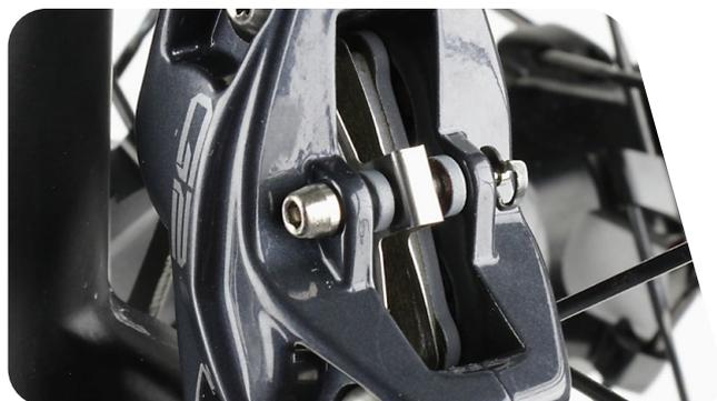
**9** Ziehen Sie den Bremshebel, bis der Kontaktpunkt fest und der Hebelweg akzeptabel ist.
