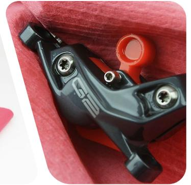
Ersetzen Sie den O-Ring oder die Dichtung durch ein neues Teil aus dem Wartungssatz. Entfernen Sie den alten O-Ring oder die alte Dichtung mit den Fingern, einem Kabelbinder oder einem Dorn.
