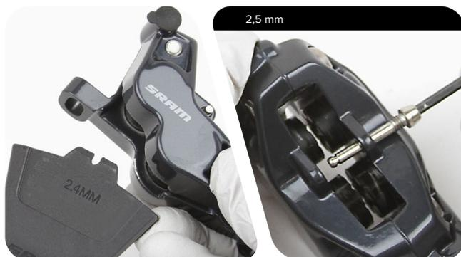
**7** Entfernen Sie alle Bremssattelgehäuse-Schrauben.
