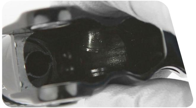
**5** Lösen Sie die Kolbenhülse und das Kupplungsstück mit dem SRAM-Montagewerkzeug für Bremshebel-Innenteile. Führen Sie das Innenteile-Montagewerkzeug für SRAM-Hebel in den Hebelkörper ein und richten Sie den Schlitz im Werkzeug an der Kolbenhülse aus. Lösen Sie mit dem Werkzeug die Hülse und entfernen Sie dann die Hülse und das Kupplungsstück.
