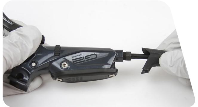
**3** Entfernen Sie die Bremsleitungs-Überwurfmutter. Ziehen Sie die Bremsleitung und den Klemmring vom Bremshebelkörper ab.
