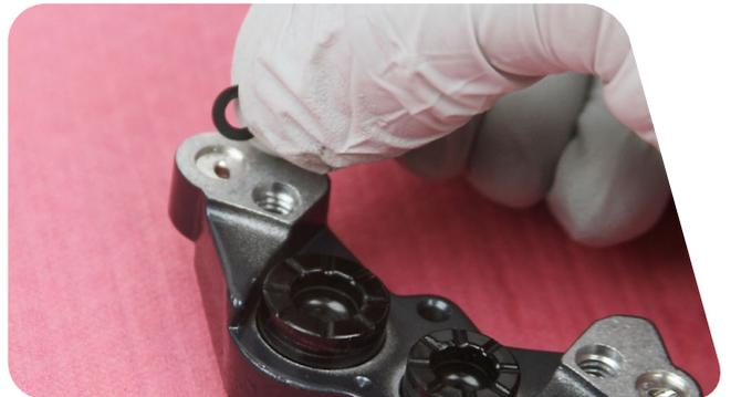
**10** Entfernen Sie die Kolben aus beiden Bremssattelgehäuse-Hälften.
