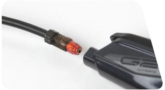
**6** Ziehen Sie die Überwurfmutter mit einem Drehmomentschlüssel und einem Hahnenfußaufsatz mit 8 N·m an.
