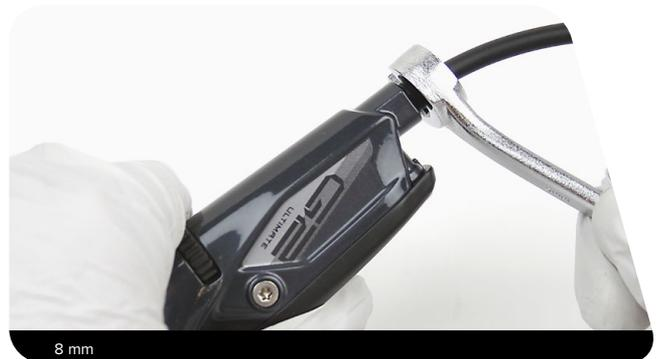
**4** Lassen Sie die Bremsflüssigkeit in eine Ölauffangwanne ab. Betätigen Sie den Hebelgriff, um die überschüssige Bremsflüssigkeit aus dem Hebelkörper herauszupumpen.
