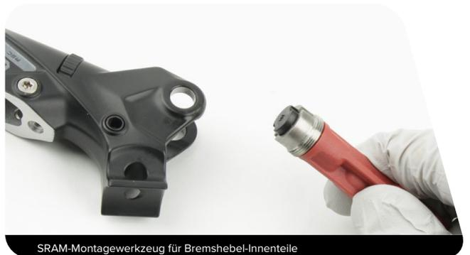
**6** Entfernen Sie die Hülse von Hand von dem Kupplungsstück. Sprühen Sie Isopropyl-Alkohol auf die Hülse und das Kupplungsstück und säubern Sie sie mit einem Werkstatttuch.
