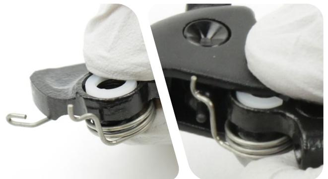
**3 G2 Ultimate:** Tragen Sie ein wenig Loctite Threadlocker Blue 242 auf jede Gelenkschraube auf.
