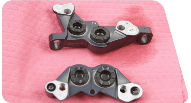
**9** Entfernen Sie beide Bremssattel-O-Ringe von der Innenseite des Bremssattels.
