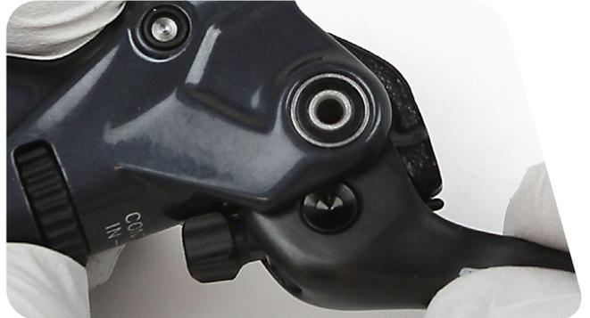
*Stellen Sie sicher, dass die Hebelfeder ordnungsgemäß im Hebel sitzt. Das nach außen weisende Ende der Feder muss gegen den Hebelgriff drücken, während das nach innen weisende Ende der Feder am Hebelkörper anliegen muss. Wenn die Feder nicht ordnungsgemäß sitzt, können Sie die Griffweite des Hebelgriffs nicht einstellen.*
