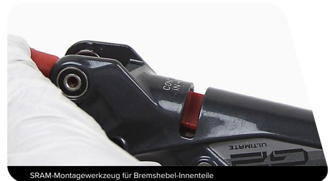
*Drücken Sie den Kontaktpunkt-Einstellknopf nach unten und entfernen Sie das Montagewerkzeug für Bremshebel-Innenteile*
