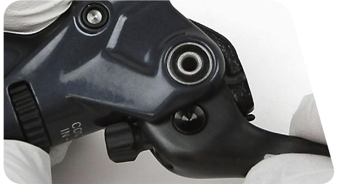
*Asegúrese de que el muelle de retorno de la maneta está correctamente asentado en la maneta. El extremo más exterior del muelle debe presionar contra el brazo de la maneta, mientras que el extremo más interior debe presionar contra el cuerpo de la maneta. Si el muelle de retorno no se asienta correctamente, no podrá ajustar el alcance del brazo de la maneta.*
