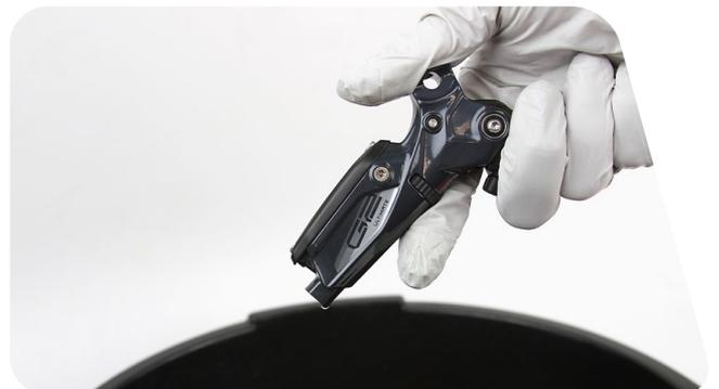
**5** Retire el perno de la tapa del depósito más cercano al brazo de la maneta.
