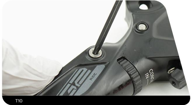
**11** Separe la cámara flexible de la tapa del depósito.
