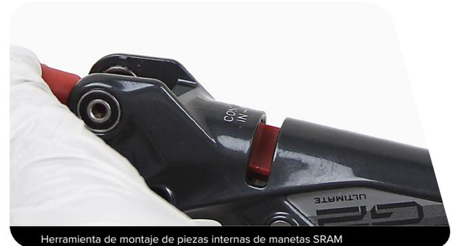
*Presione hacia abajo el mando de ajuste de contacto y retire la herramienta de montaje de piezas internas de la maneta.*
