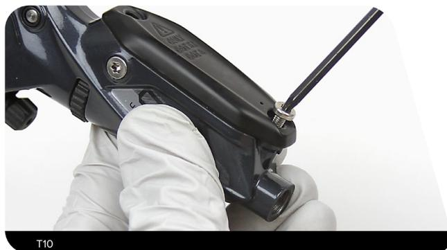
**8** Retire la tapa del depósito y la cámara flexible del cuerpo de la maneta.
