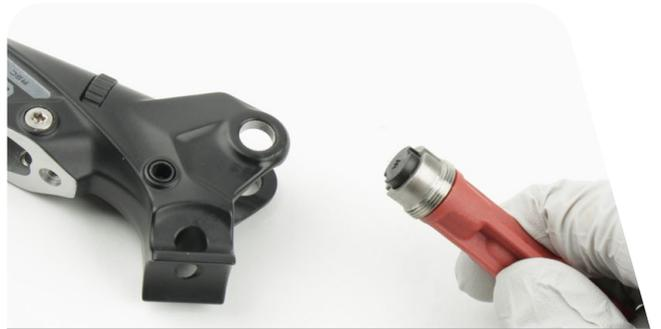
Herramienta de montaje de piezas internas de manetas SRAM
