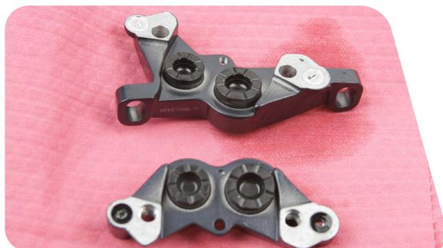
**9** Retire las dos juntas tóricas de la pinza de freno del lado interior de la pinza.
