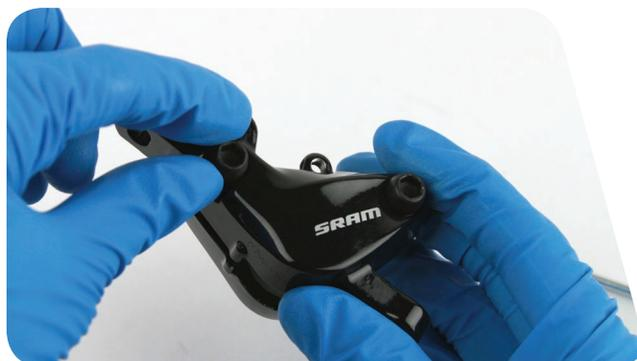
**6** À l'aide d'une clé dynamométrique équipée d'une douille hexagonale de 5 mm, serrez chaque boulon à un couple compris entre 9,8 et 11,8 N·m.
