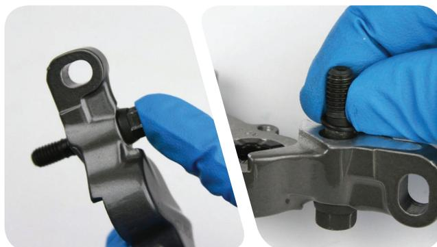
**6** Alignez l'olive creuse et le boulon creux puis vissez le boulon à la main dans l'olive creuse jusqu'à ce qu'il se bloque. Pour l'instant, ne serrez pas trop le boulon creux.
