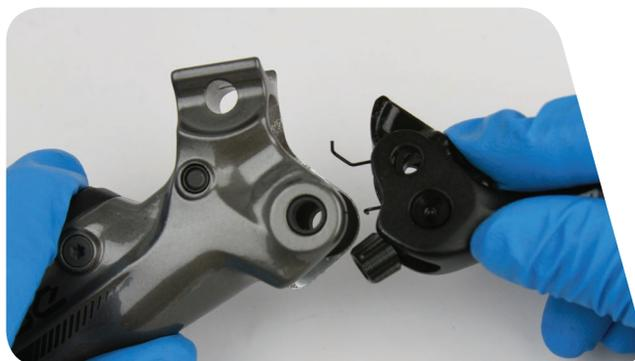
*Assurez-vous que le ressort de retour du levier est correctement positionné dans le levier, comme illustré. L'extrémité du ressort qui pointe vers l'extérieur doit être contre la poignée du levier, alors que l'extrémité qui pointe vers l'intérieur doit être contre le corps du levier. La molette de réglage de la course doit se situer dans le trou de la came ; si elle n'est pas correctement installée, vous ne pourrez pas régler la course du levier.*
