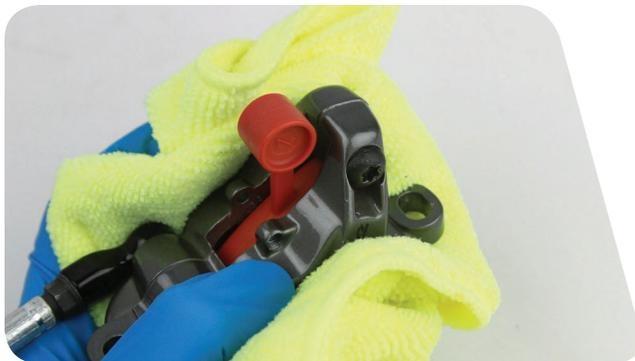
Examinez votre travail. Si vous constatez qu'un joint torique dépasse de l'olive creuse ou du boulon creux, retirez puis remplacez le joint torique ; reprenez ensuite le procédé d'installation des joints.
