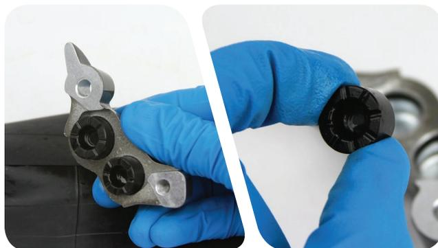
**6** À l'aide d'une pointe, retirez les joints des pistons situés à l'intérieur des deux moitiés de l'étrier. Mettez en place des joints neufs à l'intérieur des deux moitiés de l'étrier.
