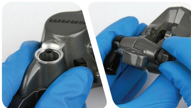
**7** À l'aide d'une clé dynamométrique équipée d'une douille TORX® T25, installez le boulon du corps de l'étrier et serrez-le à un couple compris entre 9,7 et 11,7 N-m.
