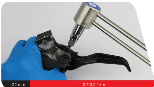
**9** À l'aide d'une clé TORX® T8, installez une cheville de fixation du boulon neuve.
