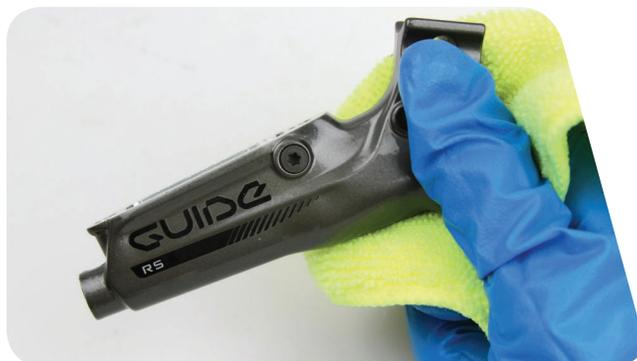
Le liquide DOT abîme les surfaces peintes. Si du liquide entre en contact avec une surface peinte (comme celle du cadre) ou avec les décors imprimés sur les freins, essuyez-le immédiatement puis nettoyez les surfaces à l'alcool isopropylique ou à l'eau. Les dommages occasionnés par le liquide DOT sur les surfaces peintes et/ou imprimées ne sont pas couverts par la garantie.
