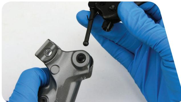
*Assurez-vous que le ressort de retour du levier est correctement positionné dans le levier, comme illustré. La molette de réglage de la course doit se situer dans le trou de la came ; si elle n'est pas correctement installée, vous ne pourrez pas régler la course du levier.*
