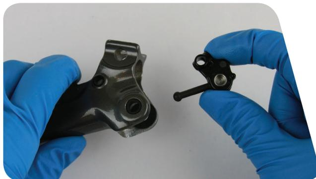
**4 RS uniquement** : alignez le trou du SwingLink avec le trou de la douille puis poussez la clavette du pivot dans le trou jusqu'à ce qu'elle se bloque.
