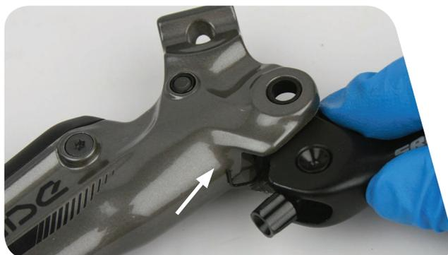
**7** Alignez la came et la poignée du levier avec les trous du corps du levier puis enfoncez la clavette du pivot à travers les trous.
