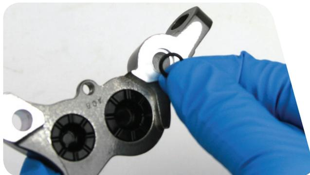
**5** Placez l'une des moitiés de l'étrier, le piston tourné vers le bas, bien à plat sur un carré de caoutchouc souple ou une bande de butyle.
