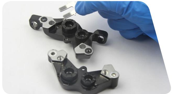
**7** Entfernen Sie die Bremssattel-Vierkantdichtungen von der Außenseite des Bremssattels.
