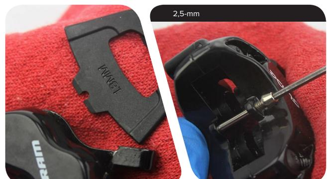
**5** Entfernen Sie alle Bremssattelgehäuse-Schrauben.
