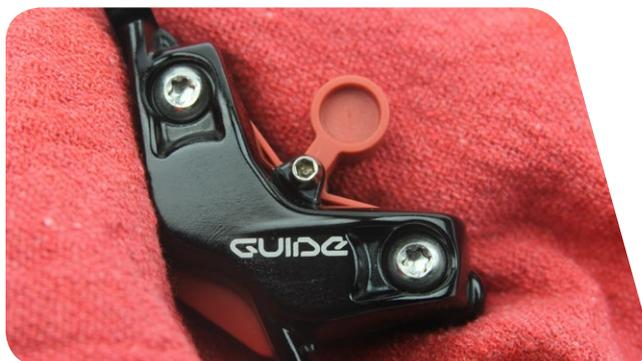
Nehmen Sie eine Sichtprüfung vor. Wenn O-Ringe über die Außenkanten der Bremsleitungsaufnahme und der Achsschraube hervorsteht, entfernen und erneuern Sie sie. Wiederholen Sie danach das Einbauverfahren
