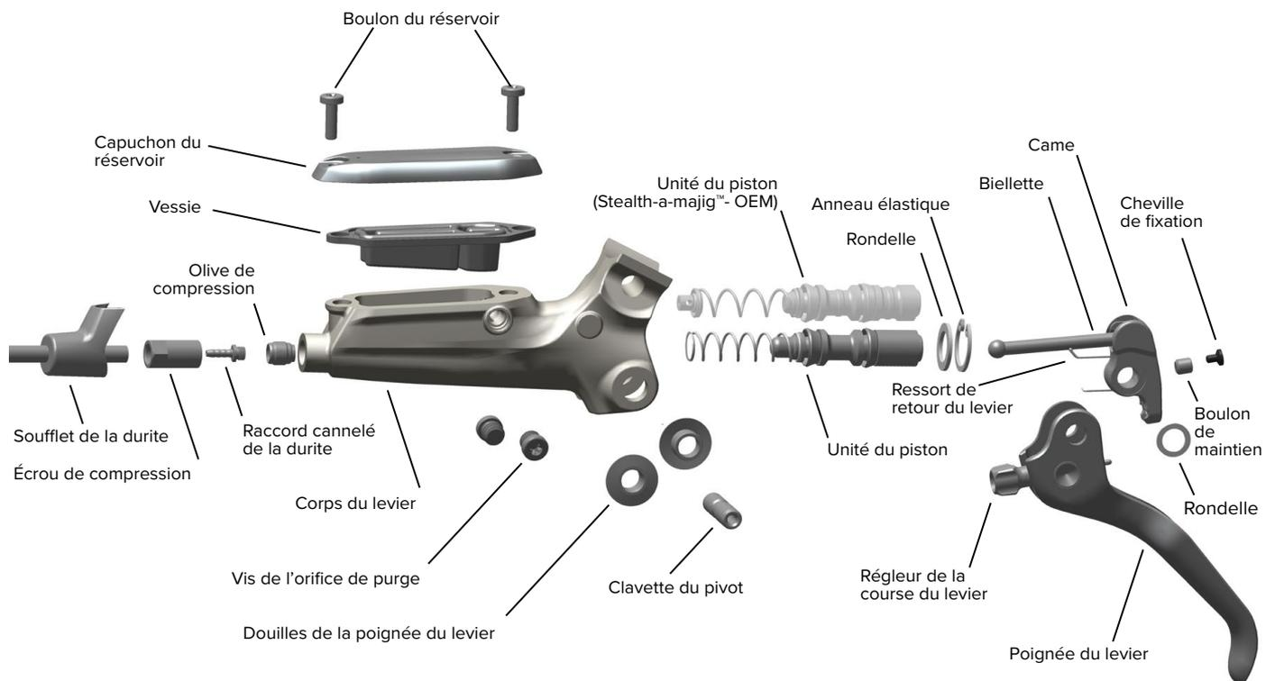
Le liquide de frein DOT endommage les surfaces peintes. Si du liquide entre en contact avec une surface peinte (comme celle du cadre) ou avec les décors imprimés sur les freins, essuyez-le immédiatement puis nettoyez les surfaces à l'alcool isopropylique ou à l'eau. Les dommages occasionnés par le liquide de frein DOT sur les surfaces peintes et/ou imprimées ne sont pas couverts par la garantie.
