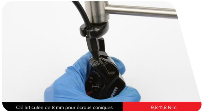
Clé articulée de 8 mm pour écrous coniques
