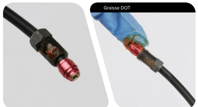
**9** installez le raccord de compression et son écrou sur l'étrier.
