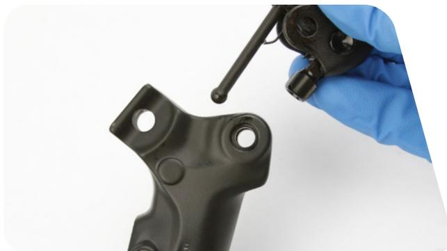
*Veillez à ce que la molette de réglage de la course du levier se trouve bien dans l'orifice de la came et que le ressort de retour du levier soit bien inséré comme sur la photo. La molette de réglage doit être insérée dans l'orifice de la came. Si elle n'est pas correctement mise en place, il sera impossible de régler la course du levier.*
