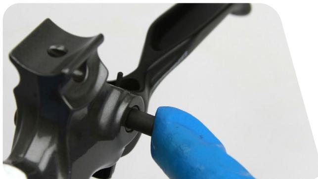
**4** Appliquez une petite quantité de Loctite® Threadlocker Blue 242® sur le boulon de maintien.
