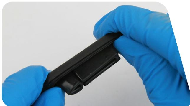
**7** Installez l'unité vessie/capuchon du réservoir dans le corps du levier.
