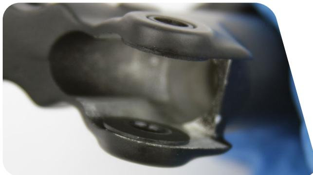
**2** Insérez l'unité du levier dans le corps du levier en plaçant la tige poussoir dans le piston et le ressort de retour du levier dans le corps du levier.
