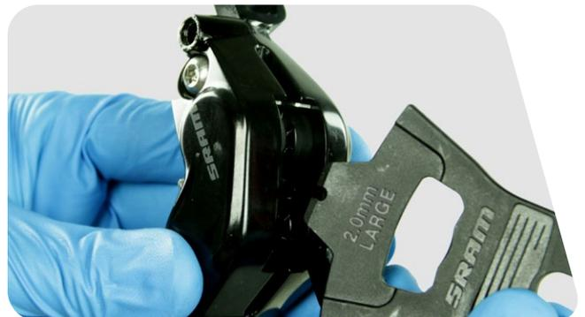
**8** Entfernen Sie die Bremsbelag-Befestigungsschraube.
