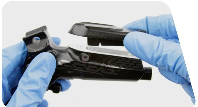
**9** Ziehen Sie die Schrauben des Ausgleichsbehälterdeckels fest.
