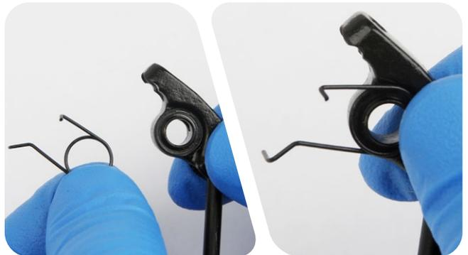
Halten Sie die Mitnehmer/Druckstange/Hebelrückstellfeder/Unterlegscheibe in Position, montieren Sie die Baugruppe auf dem Hebelgriff und fahren Sie mit Schritt 2 fort.
