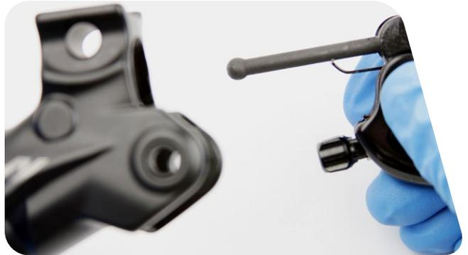
*Der Code™ R-Hebelgriff besteht aus vier Teilen: dem Hebelgriff, der Mitnehmer/Druckstangen-Baugruppe, einer Unterlegscheibe und der Hebelrückstellfeder. Um alle Teile zusammenzuhalten, können Sie den Hebelgelenkstift wieder einsetzen und den Hebelgriff vorsichtig beiseite legen.*
