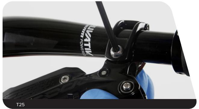
**5** Entfernen Sie die Hohlschraube und die Leitung, und entfernen Sie anschließend die Hohlschraube von der Leitungsaufnahme.
