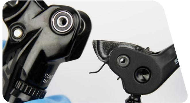
*Stellen Sie sicher, dass die Hebelrückstellfeder ordnungsgemäß im Hebel sitzt. Das nach außen weisende Ende der Feder muss gegen den Hebelgriff drücken, während das nach innen weisende Ende der Feder am Hebelkörper anliegen muss. Wenn die Rückstellfeder nicht ordnungsgemäß sitzt, können Sie die Reichweite des Hebelgriffs nicht einstellen.*
