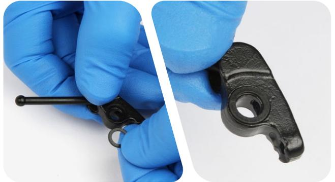
Montieren Sie die Hebelrückstellfeder auf der Mitnehmer/Druckstangen-Baugruppe.
