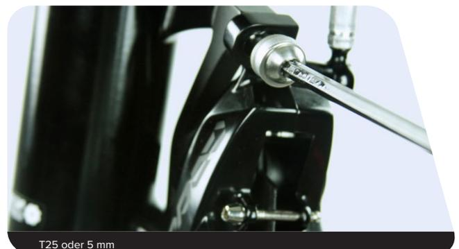
**4** Entfernen Sie den Hebel und die Schelle.
