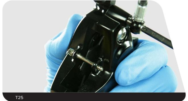
**6** Entfernen Sie die O-Ringe der Hohlschraube und bringen Sie neue O-Ringe an.
