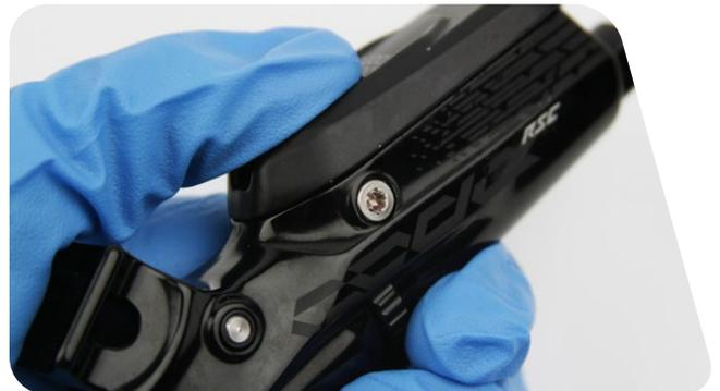
**7** Setzen Sie eine neue Rastkugel und dann eine Rastfeder in die Ausgleichsbehälterbohrung im Hebelkörper ein, die sich näher am Hebelgriff befindet.
