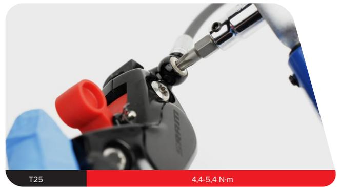
Nehmen Sie eine Sichtprüfung vor. Wenn O-Ringe über die Außenkanten der Bremsleitungsaufnahme und der Achsschraube hervorstehen, entfernen und erneuern Sie sie. Wiederholen Sie danach das Einbauverfahren.
