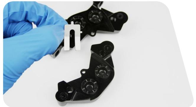
**11** Entfernen Sie die Kolben aus beiden Bremssattelgehäuse-Hälften.
