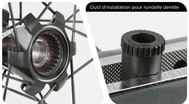
**8** Installez le moyeu du côté de la chaîne par-dessus l'outil d'installation pour rondelle dentée. Appuyez fermement vers le bas puis faites tourner la roue afin de vous assurer que les dents de l'outil s'emboîtent bien dans la rondelle dentée.
