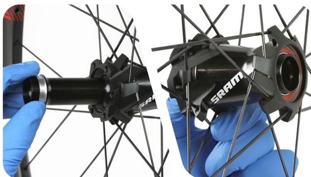
**8** Insérez l'un des outils pour moyeu avant FR/440 dans le moyeu contre le roulement en place.
