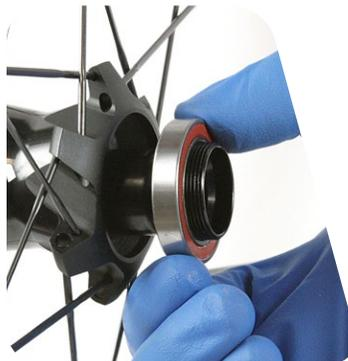
**9** Retirez le roulement de l'axe et jetez-le. Installez un nouveau roulement sur l'axe avec le joint rouge tourné vers l'extérieur de l'axe.
