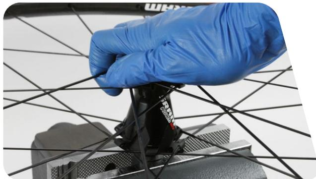
**9** Tout en continuant à appuyer sur la roue, faites-la tourner dans le sens inverse des aiguilles d'une montre afin de démonter la rondelle dentée du moyeu. Le joint du rotor va également se démonter et il se peut qu'il tombe sur l'étau, par-dessus la rondelle dentée. Retirez la rondelle dentée de l'outil. Nettoyez-la puis vérifiez son état. Remplacez la rondelle dentée en cas de dommage.
