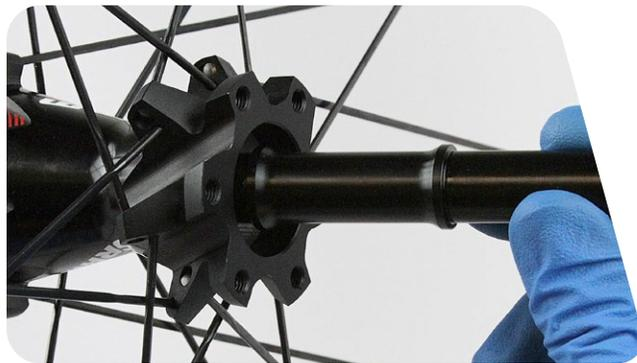
**12** À l'aide d'un maillet en caoutchouc, frappez sur l'axe afin de faire sortir le roulement du moyeu.
