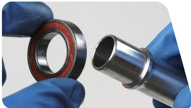
**5** Insérez l'une des extrémités de l'axe à travers le moyeu, jusque dans le roulement déjà en place.
