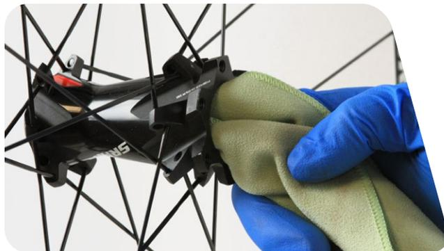
**9** Lubrifiez légèrement l'emplacement des roulements.
