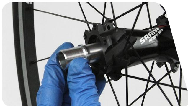
**6** Insérez le grand outil étagé dans l'axe. À l'aide d'un maillet en caoutchouc, frappez sur l'axe afin de faire sortir le roulement du moyeu.
