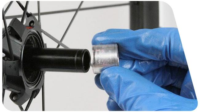
**5** À l'aide d'un maillet en caoutchouc, frappez sur l'axe afin de retirer le roulement du moyeu situé du côté du frein à disque.
