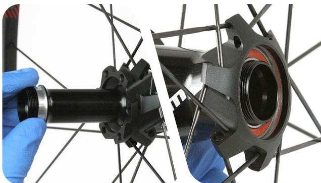
**8** Insérez le petit outil étagé dans l'axe. À l'aide d'un maillet en caoutchouc, tapez sur l'axe pour faire sortir le roulement du moyeu.
