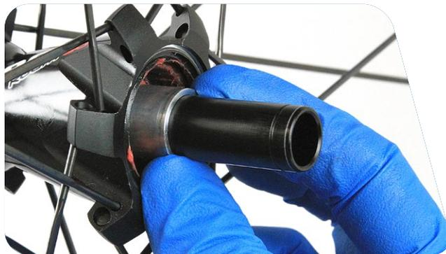
**33** Installez le ressort sur l'axe et par-dessus l'entretoise. L'ouverture la plus large du ressort doit être tournée vers le moyeu.
