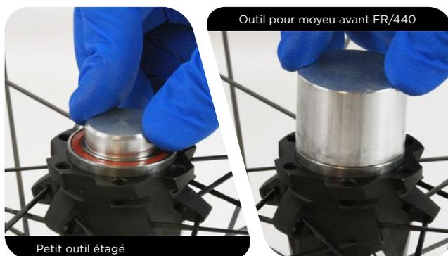
**11** À l'aide d'un maillet en caoutchouc, tapez sur l'outil pour moyeu avant FR/440 jusqu'à ce que le roulement soit parfaitement en place dans son logement.
