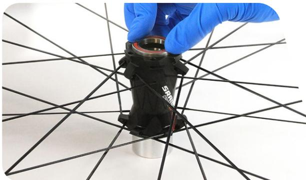
**10** Insérez le petit outil étagé dans l'axe et le roulement. Installez l'autre outil pour moyeu avant FR/440 sur le petit outil étagé et contre le roulement.
