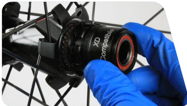
**38** Appliquez une fine couche de graisse sur le roulement du corps de cassette. À l'aide d'un chiffon ou de papier absorbant, essuyez la graisse aux deux extrémités de l'axe.
