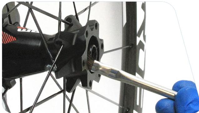
**31** Appliquez une fine couche de **graisse spécifique DT** sur les dents de la rondelle dentée.
