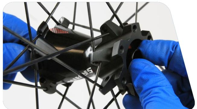
**30** Appliquez une fine couche de graisse sur le côté du roulement opposé à la chaîne. À l'aide d'un chiffon ou de papier absorbant, essuyez la graisse à l'extrémité de l'axe.
