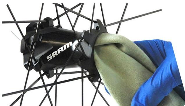
**11** Lubrifiez légèrement l'emplacement des roulements.
