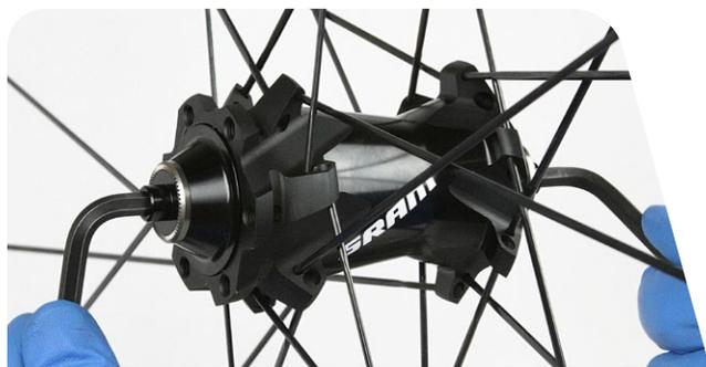
Clé Allen de 5 mm      Blocage rapide      Clé Allen de 5 mm
