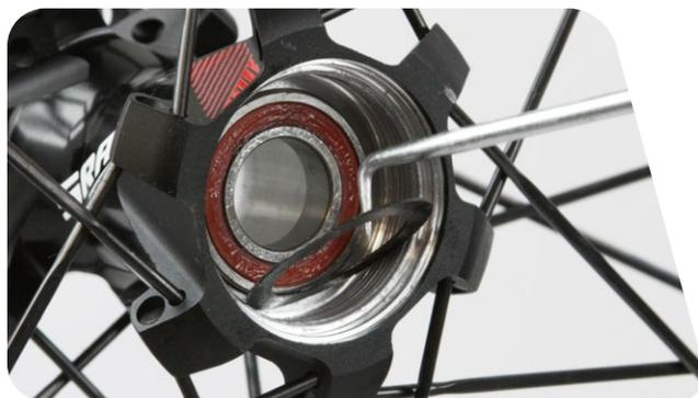
**11** Insérez l'extrémité la plus courte de l'axe dans le moyeu du côté du frein à disque jusqu'à dans le roulement situé du côté de la chaîne.
