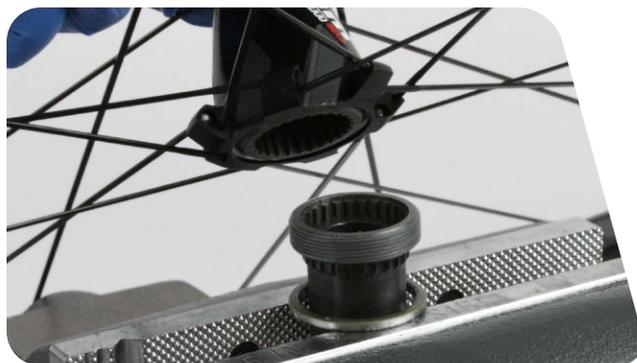
**10** À l'aide d'une pointe, retirez la rondelle d'ajustage du moyeu.
