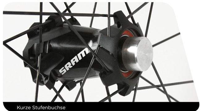
**3** Schlagen Sie mit einem Gummihammer die Achse aus der Nabe heraus.
