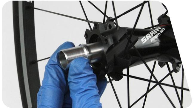
**6** Führen Sie die lange Stufenbuchse in die Achse ein. Schlagen Sie mit einem Gummihammer auf die Achse, um das Lager aus der Nabe zu entfernen.
