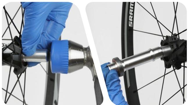
**4** Entfernen Sie das Lager aus der Achse und entsorgen Sie es.
