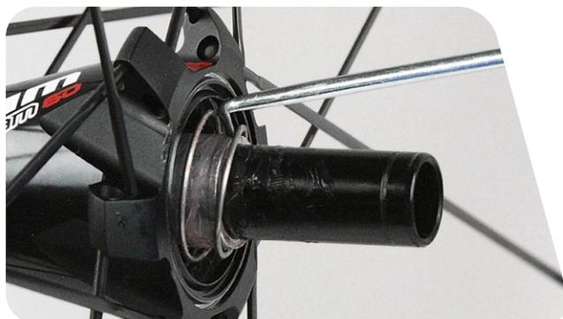
**4** Entfernen Sie das Aluminium-Distanzstück aus der Achse.
