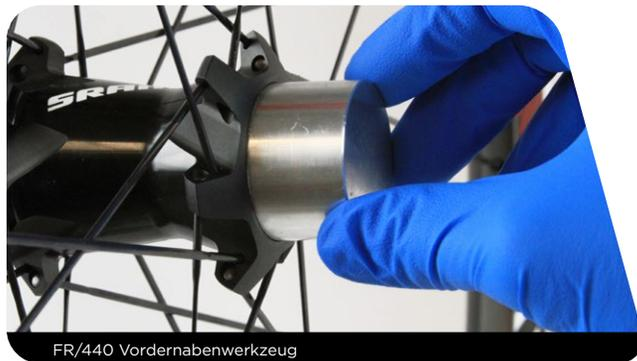
**9** Legen Sie das FR/440 Vordernabenwerkzeug und das Laufrad auf eine Werkbank. Setzen Sie das andere Lager so auf die Achse auf, dass die rote Dichtung von der Nabe weg weist.
