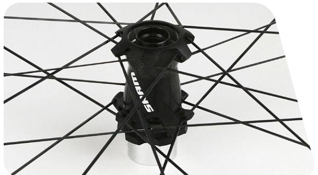
**14** Platzieren Sie das andere FR/440 Vordernabenwerkzeug auf der Achse und in der Nabe. Schlagen Sie mit einem Gummihammer auf das Werkzeug, bis das Lager fest im Lagersitz sitzt.
