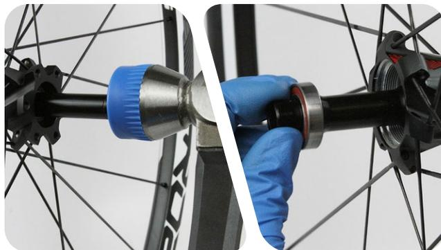
**13** Entfernen Sie das Lager aus der Achse und entsorgen Sie es.
