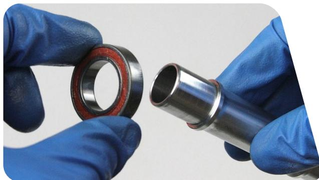
**11** Führen Sie die Achse durch die Scheibenbremsenseite der Nabe in die Nabe ein.
