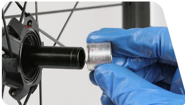
**5** Schlagen Sie mit einem Gummihammer auf die Achse, um das Lager auf der Scheibenbremsseite aus der Nabe zu entfernen.
