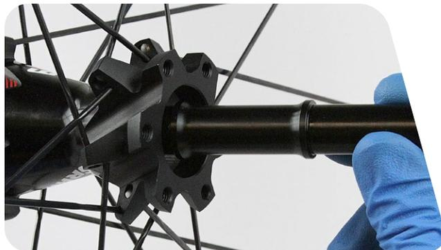
**12** Schlagen Sie mit einem Gummihammer auf die Achse, um das Lager aus der Nabe zu entfernen.
