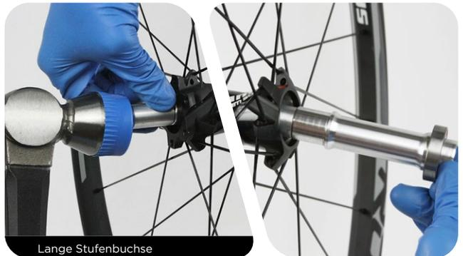
**7** Entfernen Sie das Lager aus der Achse und entsorgen Sie es.
