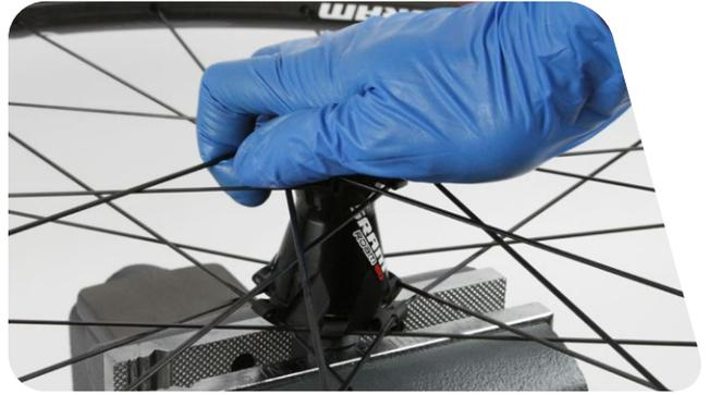
**9** Drücken Sie das Laufrad fest nach unten und drehen Sie es gegen den Uhrzeigersinn, um die Ringmutter von der Nabe zu entfernen. Die Bremsscheibendichtung wird dabei ebenfalls entfernt und kann über das Ringmutter-Montagewerkzeug auf den Schraubstock fallen. Nehmen Sie die Ringmutter vom Werkzeug ab. Reinigen Sie die Ringmutter und prüfen Sie sie auf Beschädigungen. Wenn die Ringmutter beschädigt ist, tauschen Sie sie aus.
