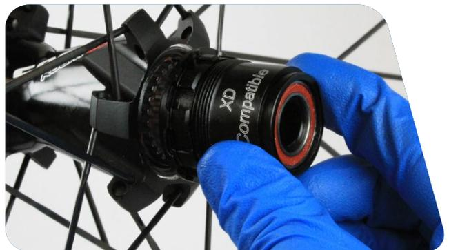
**38** Tragen Sie eine dünne Schicht Schmierfett auf das Lager des Freilaufkörpers auf. Entfernen Sie mit einem Lappen oder Papiertuch jegliches Fett von den Achsenenden.
