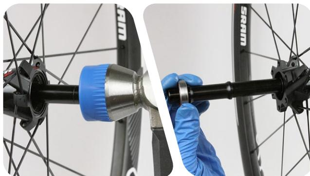
**6** Entfernen Sie das Lager aus der Achse und entsorgen Sie es.
