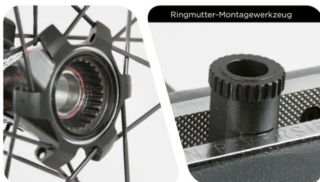
**8** Setzen Sie die Antriebsseite der Nabe auf das Ringmutter-Montagewerkzeug auf. Drücken Sie das Laufrad fest nach unten und drehen Sie es. Achten Sie darauf, dass die Zähne des Werkzeugs in der Ringmutter fassen.
