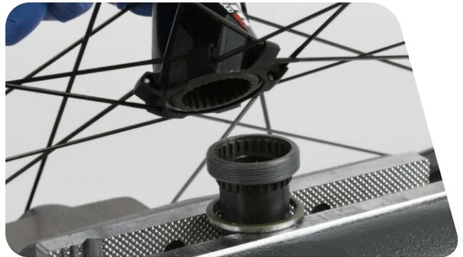
**10** Entfernen Sie mit einem Dorn den Distanzring von der Nabe.
