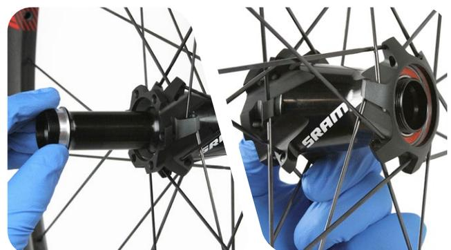
**8** Führen Sie eines der FR/440 Vordernabenwerkzeuge so in die Nabe ein, dass es auf der montierten Lagerschale aufliegt.
