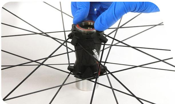
**10** Führen Sie die kurze Stufenbuchse in die Achse und das Lager ein. Setzen Sie das andere FR/440 Vordernabenwerkzeug auf die kurze Stufenbuchse und die Lagerschale auf.
