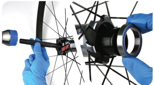
**5** Säubern Sie die Lagerbohrungen mit einem Lappen.
