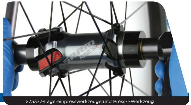
275377-Lagereinpresswerkzeuge und Press-1-Werkzeug
